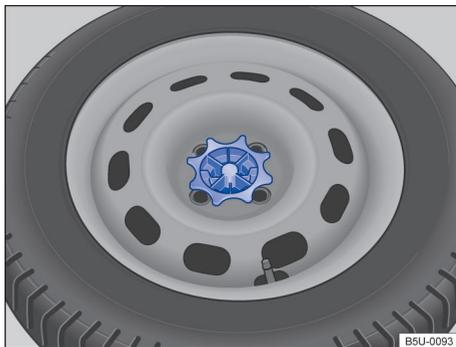
**Fig. 194** No compartimento de bagagem: manipulô para fixação da roda de emergência.
