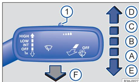
**Fig. 75** À direita da coluna de direção: comandar os limpadores / lavadores do para-brisa.
