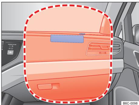
**Fig. 36** Local de instalação e área de expansão do airbag frontal do passageiro dianteiro.
