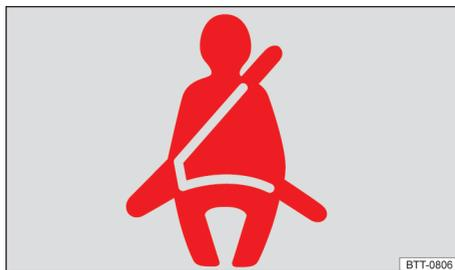
**Fig. 22** Luz de advertência no display do instrumento combinado.
