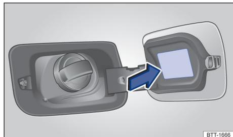
Fig. 192 Na parte interna da portinhola do tanque de combustível: etiqueta com a pressão dos pneus.
