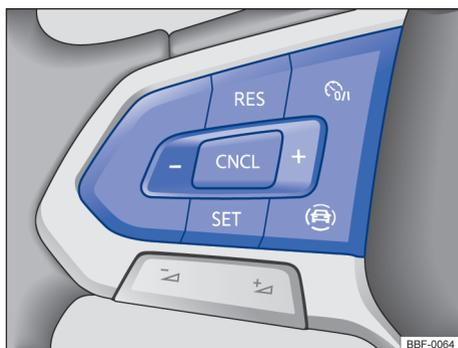
Fig. 96 Lado esquerdo do volante multifunções: botões para comandar o GRA.
