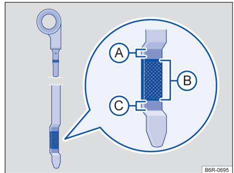
**Fig. 183** Vareta de medição do óleo com marcas de nível do óleo do motor.
