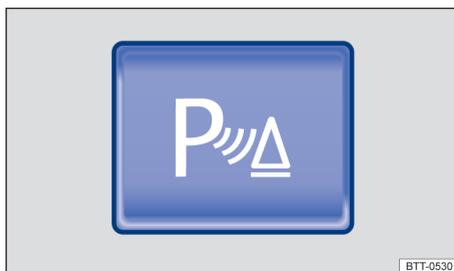
**Fig. 105** No console central: botão para ligar e desligar o auxílio de estacionamento.
