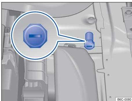
**Fig. 177** No compartimento do motor: ponto de auxílio à partida (ponto de aterramento).
