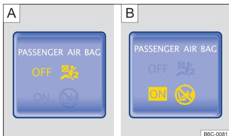
Fig. 34 Na parte superior do console central: luz de controle para o airbag frontal do passageiro dianteiro desligado [A] ou luz de controle para o airbag frontal do passageiro dianteiro ligado [B].
