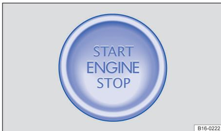
**Fig. 89** Na parte inferior do console central: botão de partida para ligar o motor.
