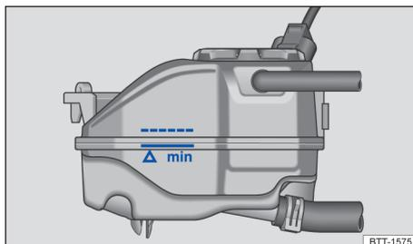
Fig. 185 No compartimento do motor: marcação no reservatório de expansão do líquido de arrefecimento do motor.
