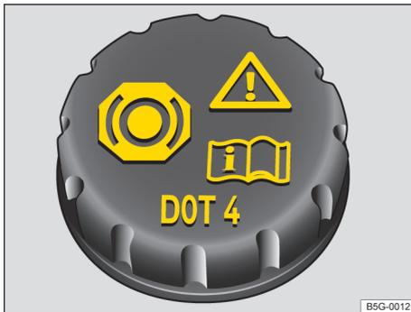
Fig. 187 No compartimento do motor: tampa do reservatório de fluido de freio.
