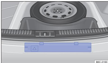
Fig. 49 No compartimento de bagagem: suporte para o triângulo de segurança.
