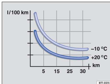
Fig. 87 Consumo de combustível em l/100 km em 2 temperaturas ambiente diferentes.
