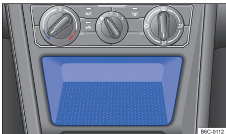
**Fig. 108** Na parte inferior do console central: porta-objetos aberto.
