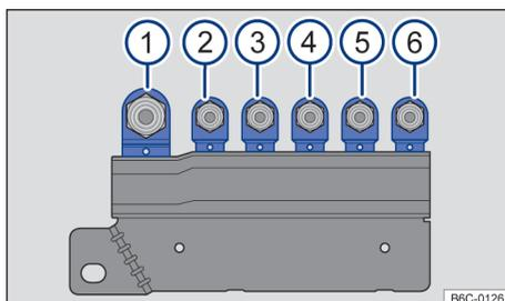
**Fig. 174** No compartimento do motor em cima da bateria: disposição dos fusíveis.
