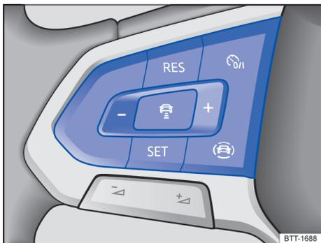
Fig. 102 Lado esquerdo do volante multifunções: botões para comandar o ACC.
