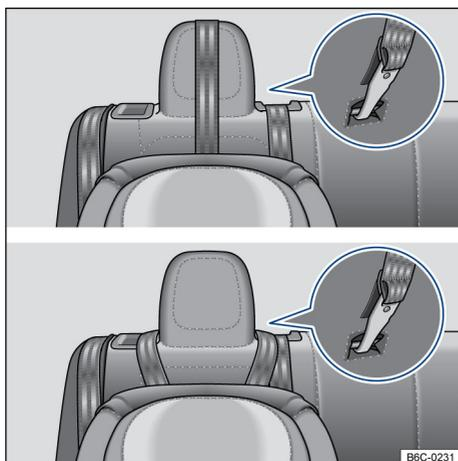
Fig. 45 No encosto do banco traseiro: **A**) posição do cadaço do cinto de segurança no caso de apoios para cabeça não ajustáveis com cinto individual Top Tether, **B**) posição do cadaço do cinto de segurança no caso de apoios para cabeça não ajustáveis com cinto Top Tether em forma de V.
