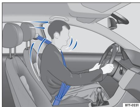
Fig. 28 Condutor protegido pelo cinto de segurança colocado corretamente em uma manobra de frenagem súbita. ▶
