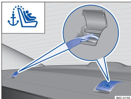
Fig. 44 Olhal de retenção para o cinto de fixação superior na cobertura do compartimento de bagagem.
