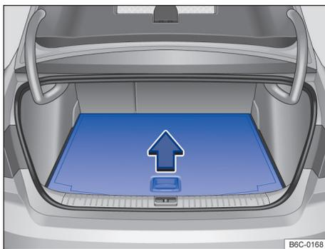
**Fig. 156** No compartimento de bagagem: levantar assoalho variável do compartimento de bagagem.
