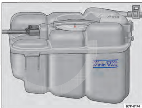
Fig. 244 No compartimento do motor: marca no reservatório de expansão do líquido de arrefecimento do motor.
