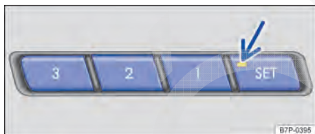
Fig. 77 Na região superior do revestimento da porta do condutor e do passageiro dianteiro: botões de memória dos ajustes do banco.
