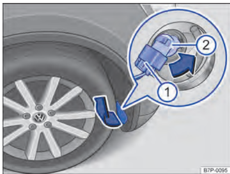
Fig. 285 Na moldura da caixa de roda dianteira direita: substituir a lâmpada incandescente no farol.
