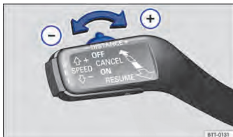
Fig. 210 À esquerda da coluna da direção: ajustar a distância do controle automático de distância.
