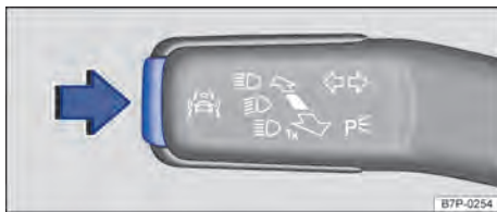
Fig. 20 Na alavanca dos indicadores de direção e do farol alto: botão dos sistemas de assistência ao condutor.
