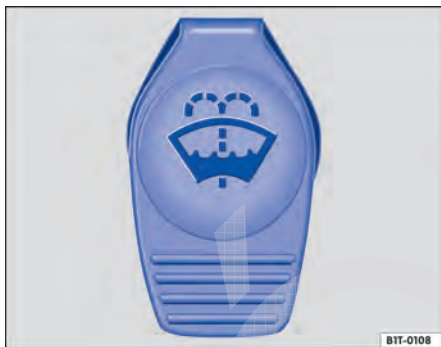
Fig. 118 No compartimento do motor: tampa do reservatório de água dos lavadores dos vidros.
