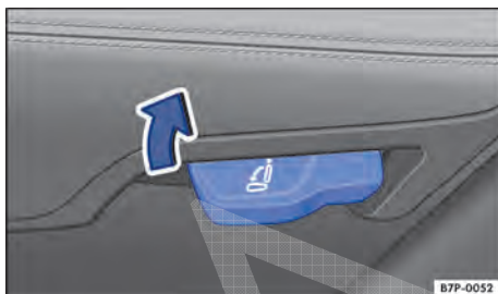
Fig. 63 Área lateral esquerda no banco traseiro: alavanca para ajustar a inclinação do encosto do banco.
