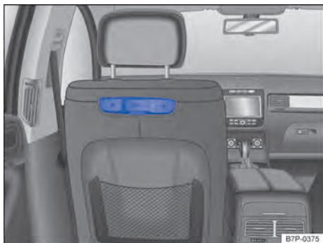
Fig. 160 No lado de trás do banco do condutor: alojamento para o Rear Seat Entertainment.
