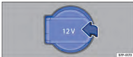
Fig. 157 No porta-objetos no painel de instrumentos: abrir a tomada 12 V.
