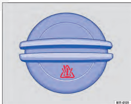
Fig. 245 No compartimento do motor: tampa do reservatório de expansão do líquido de arrefecimento do motor.
