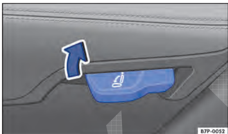
Fig. 122 Parte inferior do banco traseiro: alavanca de destravamento do encosto do banco traseiro.
