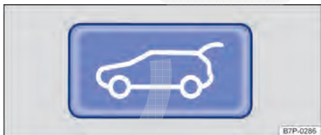
Fig. 51 À direita da tampa traseira aberta: botão de acionamento elétrico da tampa traseira.
