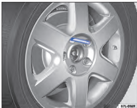
Fig. 277 Troca de roda: pino de montagem no furo superior.
