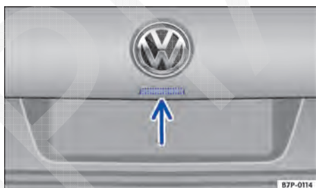
Fig. 49 Na tampa traseira: botão para abrir a tampa traseira por fora.
