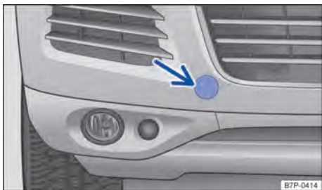
Fig. 294 No para-choque dianteiro à direita: tampa de cobertura para o alojamento da argola de reboque.
