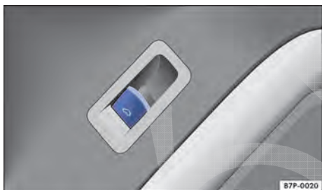
Fig. 48 No revestimento da porta do condutor: botão de destravamento da tampa traseira.
