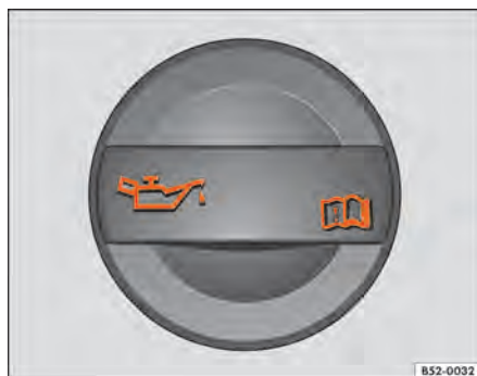
Fig. 242 No compartimento do motor: tampa da abertura para enchimento de óleo do motor.
