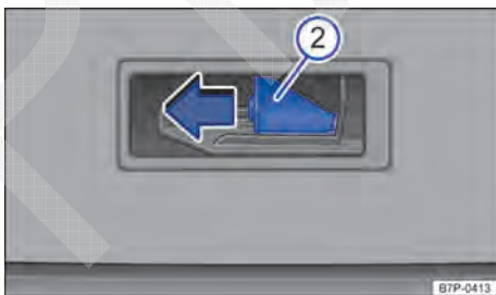
Fig. 265 Por fora do compartimento de bagagem: alavanca de destravamento atrás da cobertura do destravamento de emergência da tampa traseira.
