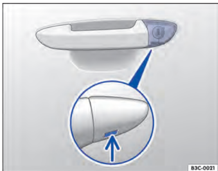
Fig. 261 Maçaneta da porta do condutor: cilindro da fechadura coberto.
