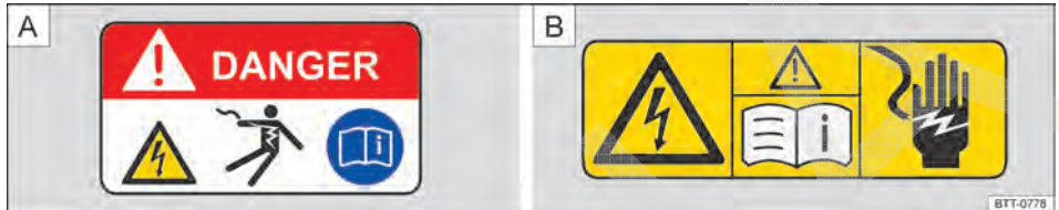
Fig. 183 Placa de advertência nos componentes de alta voltagem (variante A). Placa de alerta geral para alta voltagem (variante B).
