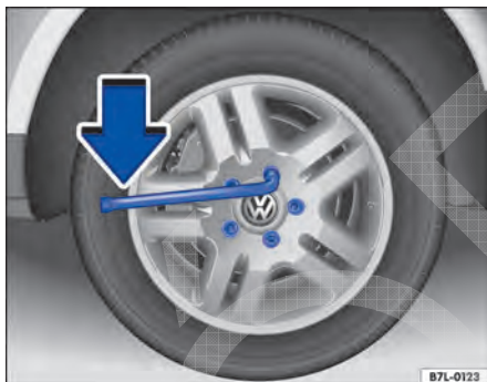
Fig. 271 Troca de roda: soltar os parafusos de roda.
