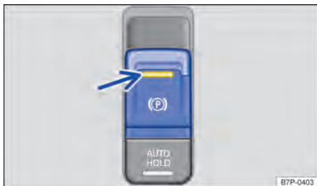
Fig. 168 Na parte inferior do console central: botão do freio de estacionamento eletrônico.
