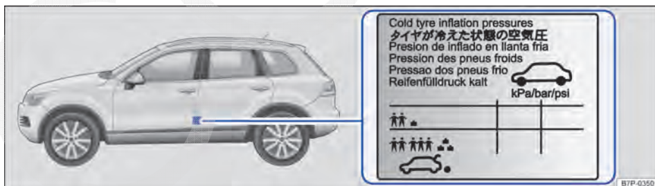
Fig. 251 Local de instalação da etiqueta da pressão dos pneus.
