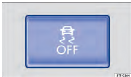
Fig. 169 No console central: botão para ligar e desligar manualmente a função ASR ou do programa eletrônico de estabilidade (ESC).
