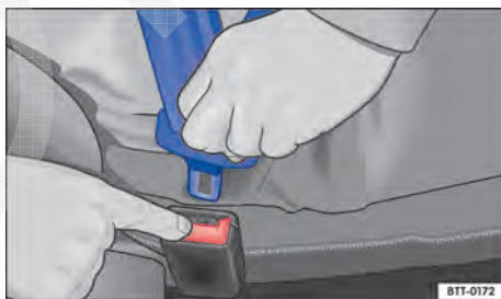
Fig. 86 Soltar a lingueta do cinto de segurança do fecho do cinto de segurança.
