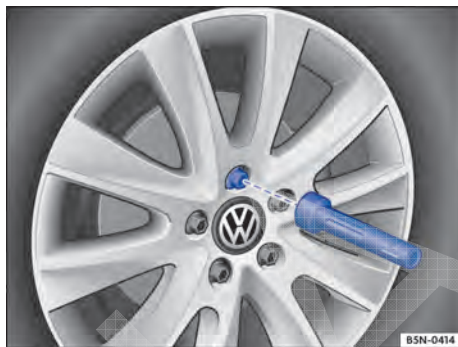
Fig. 278 Troca de roda: desaparafusar os parafusos de roda com o punho da chave de fenda.
