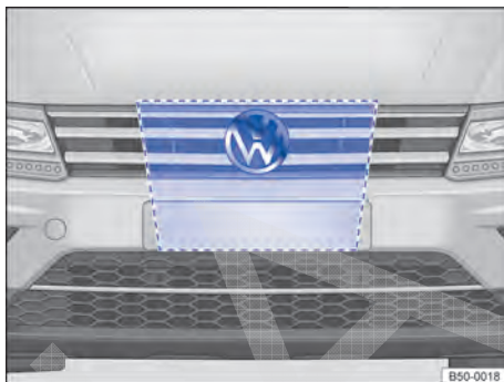
Fig. 164 Na grade do radiador, atrás do logotipo da Volkswagen: sensor do radar e área que deve ser mantida livre em volta do sensor do radar.
