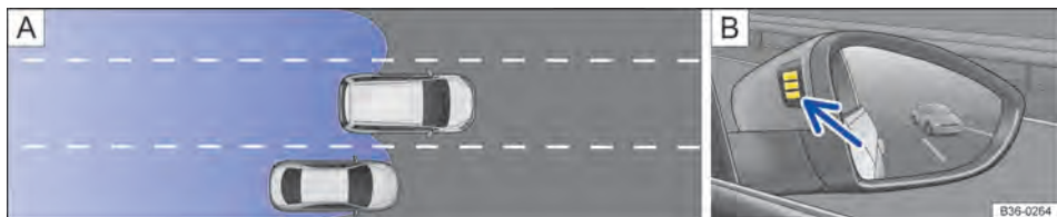
Fig. 171 A Situação de condução ao ultrapassar e mudar frequentemente de faixa. B Indicação visual no espelho retrovisor externo direito.
