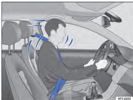
Fig. 8 Condutor protegido pelo cinto de segurança colocado corretamente em uma manobra de frenagem súbita.
