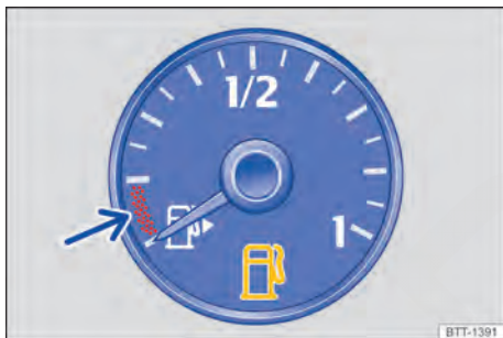
Fig. 54 No instrumento combinado: indicador do nível de combustível para gasolina e óleo diesel.
