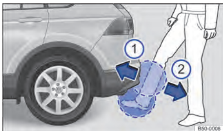
Fig. 84 Tapa do compartimento de bagagem com abertura controlada por sensor (Easy Open).
