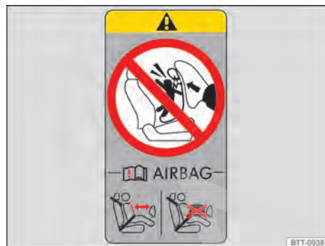
Fig. 25 Representação esquemática: etiqueta de airbag na coluna B.
