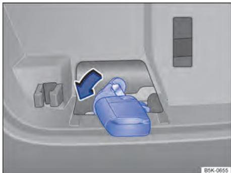
Fig. 86 No compartimento de bagagem: destravamento de emergência da tampa do compartimento de bagagem.
