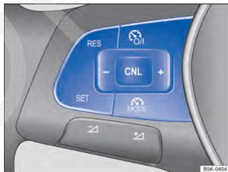
Fig. 156 Lado esquerdo do volante multifunções: botões para comandar o limitador de velocidade.
