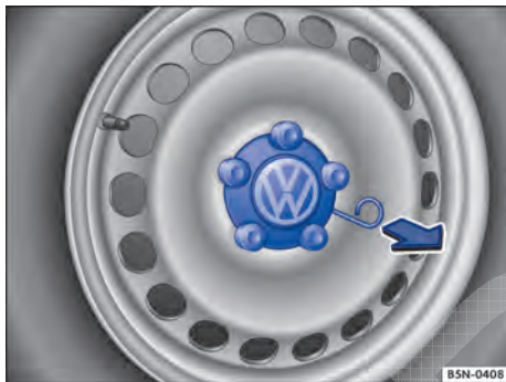
Fig. 271 Retirar a calota central.
