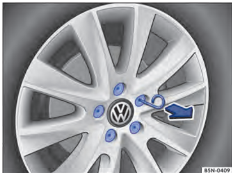
Fig. 273 Remover as capas de cobertura dos parafusos de roda.
