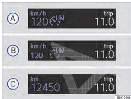
Fig. 154 No display do instrumento combinado: indicadores de status do limitador de velocidade.
