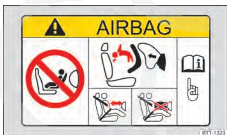
Fig. 24 Representação esquemática: etiqueta de airbag no para-sol.
