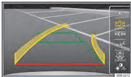
Fig. 181 Exibição do display da câmera de marcha a ré: modo 1 ligado.
