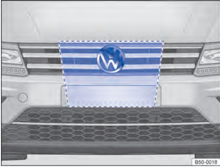
Fig. 158 Na grade do radiador, atrás do logotipo da Volkswagen: sensor do radar e área que deve ser mantida livre em volta do sensor do radar.
