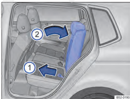
Fig. 95 Ajustar o encosto do banco traseiro.
