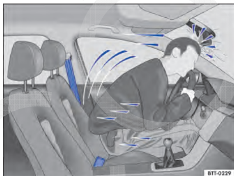
Fig. 6 O condutor sem cinto de segurança é lançado para frente.
