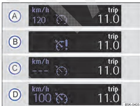
Fig. 151 No display do instrumento combinado: indicadores de status do sistema regulador de velocidade.
