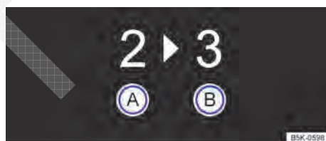
Fig. 129 No display do instrumento combinado: recomendação de marcha.
