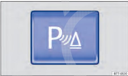
Fig. 175 No console central: botões para ligar e desligar o Park Pilot (dependendo da versão).
