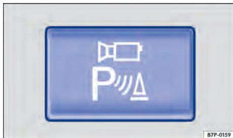
Fig. 191 Na parte superior do console central: botão para ligar manualmente a visão do ambiente.
