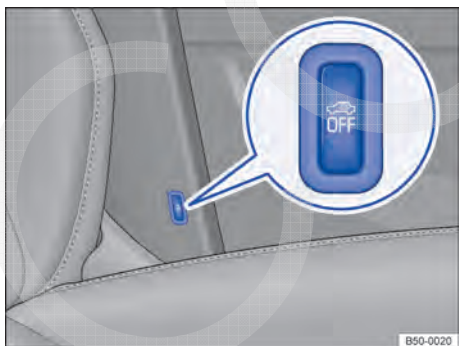
Fig. 72 Ao lado do banco do condutor: botão para desligar o monitoramento do interior do veículo e o alarme antirrebocagem.
