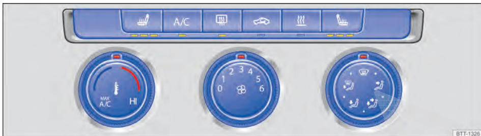
Fig. 121 Na parte superior do console central: comandos do ar-condicionado manual ou do sistema de ventilação e aquecimento.
