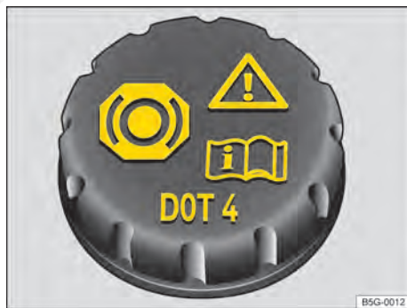
Fig. 261 No compartimento do motor: tampa do reservatório do fluido de freio.
