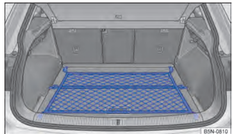
Fig. 220 No compartimento de bagagem: fixar a rede para bagagem no assoalho.
