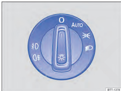
Fig. 108 Ao lado do volante: Interruptor de luzes (representação esquemática).
