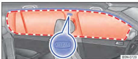
Fig. 20 No lado esquerdo do veículo: local de instalação e área de expansão do airbag para cabeça.
