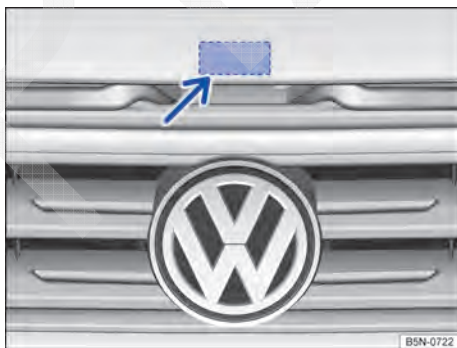
Fig. 254 Pela grade do radiador: alavanca de abertura da tampa do compartimento do motor.
