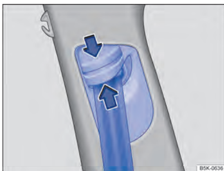
Fig. 13 Ao lado dos bancos dianteiros: regulagem de altura do cinto de segurança. ►
