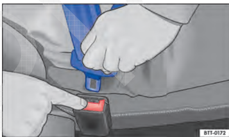
Fig. 10 Soltar a lingueta do cinto de segurança do fecho do cinto de segurança.
