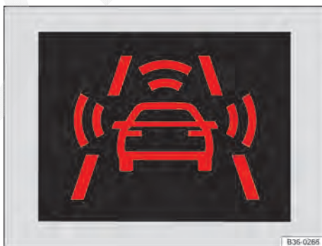
Fig. 163 No display do instrumento combinado: exibição do alerta antecipado.
