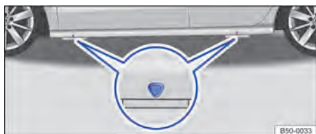
Fig. 276 Pontos de apoio do macaco.
