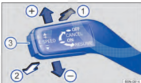
Fig. 152 À esquerda na coluna de direção: alavanca do sistema regulador de velocidade.
