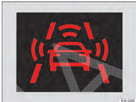
Fig. 165 No display do instrumento combinado: exibição do alerta antecipado.
