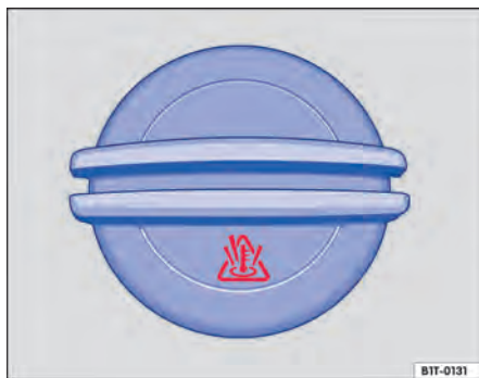
Fig. 260 No compartimento do motor: tampa do reservatório do líquido de arrefecimento do motor.
