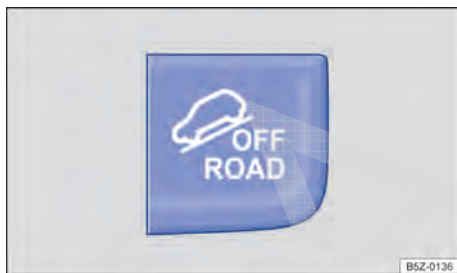
Fig. 112 No console central: botão para ligar e desligar o modo off-road manualmente.
