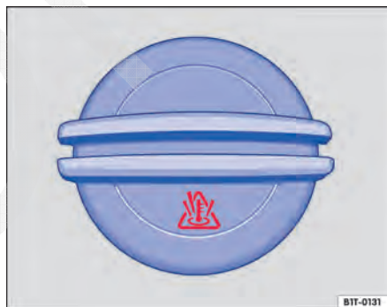
Fig. 132 No compartimento do motor: tampa do reservatório de expansão do líquido de arrefecimento do motor.
