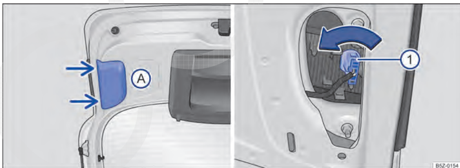
Fig. 178 Na tampa do compartimento de bagagem: remover a cobertura e lâmpada da lanterna direita e/ou da lanterna esquerda - para veículos sem lanterna de neblina.
