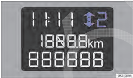
Fig. 99 No instrumento combinado: indicador de troca de marcha (variante 2).
