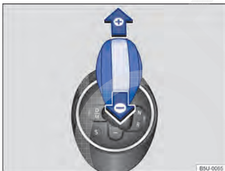
Fig. 102 Alavanca seletora na posição para condução de marcha no modo manual.
