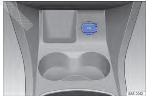
Fig. 90 No console central dianteiro: tomada 12 V.
