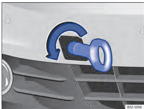
Fig. 185 No para-choque dianteiro à direita: rosquear a argola de reboque.
