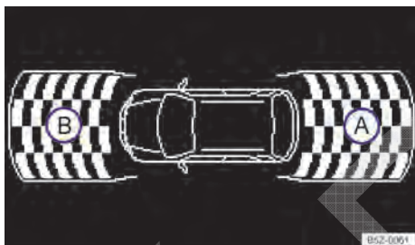
Fig. 116 Exibição do display do controle de distância de estacionamento dianteiro e traseiro no rádio (não disponível para algumas versões).
