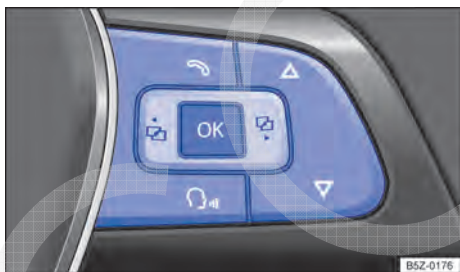
Fig. 13 Lado direito do volante multifunções: teclas de comando dos menus do instrumento combinado.
