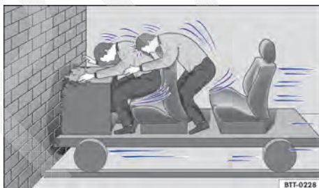
Fig. 42 Um veículo com os ocupantes do veículo sem cintos de segurança colide com um muro.
