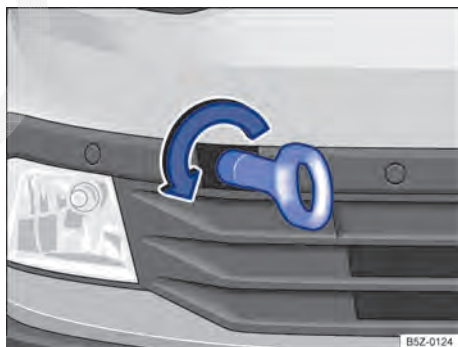
Fig. 187 No para-choque dianteiro à direita: rosquear a argola de reboque.
