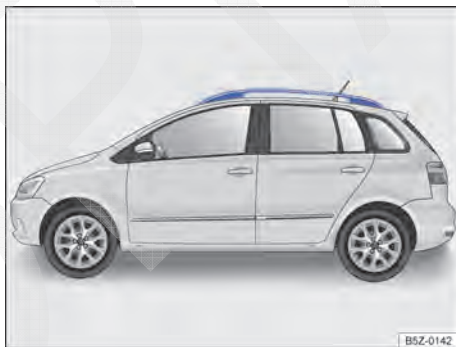
Fig. 77 Suportes longitudinais do bagageiro do teto (ambos os lados).
