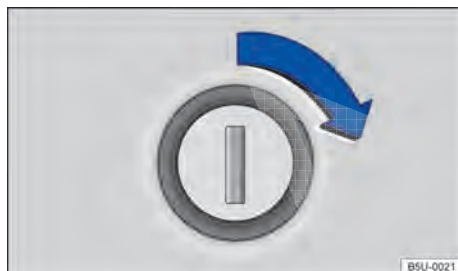
Fig. 27 Tampa do compartimento de bagagem: abrir a tampa pelo cilindro da fechadura.
