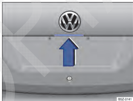
Fig. 28 No rebaixo acima da placa de licença: botão de abertura da tampa do compartimento de bagagem.
