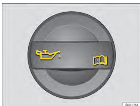
Fig. 130 No compartimento do motor: tampa da abertura para enchimento de óleo do motor.
