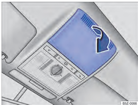
Fig. 157 No revestimento do teto: remover a cobertura.
