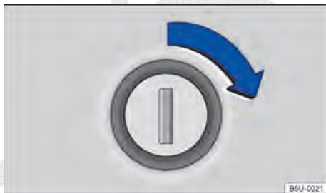
Fig. 30 Tampa do compartimento de bagagem: abrir a tampa pelo cilindro da fechadura.
