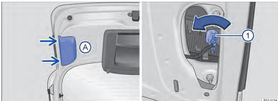
Fig. 181 Na tampa do compartimento de bagagem: remover a cobertura e lâmpada da lanterna direita e/ou da lanterna esquerda - para veículos sem lanterna de neblina.
