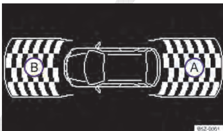
Fig. 117 Exibição do display do controle de distância de estacionamento dianteiro e traseiro no rádio (não disponível para algumas versões).
