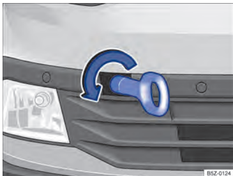
Fig. 190 No para-choque dianteiro à direita: rosquear a argola de reboque.
