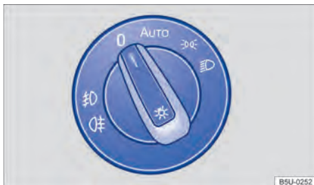
Fig. 61 No painel: interruptor das luzes.
