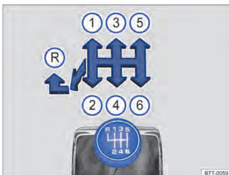
Fig. 99 Esquema de troca de marchas da transmissão manual de 6 marchas.
