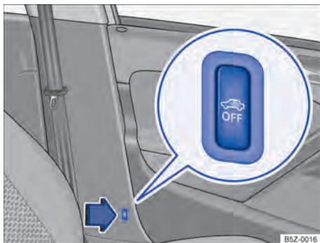
Fig. 29 Ao lado do banco do condutor: botão para desligar o monitoramento do interior do veículo.
