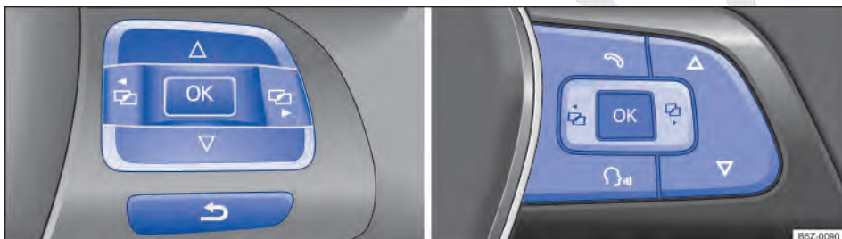
Fig. 13 Lado direito do volante multifunções: teclas de comando dos menus do instrumento combinado.
