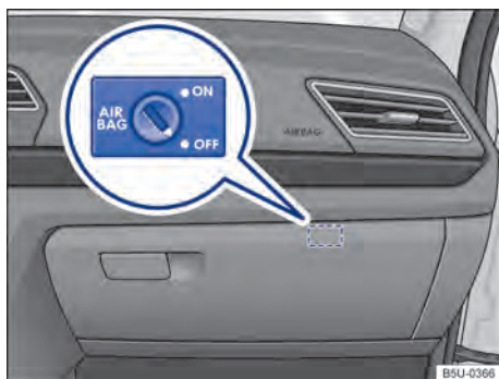
Fig. 35 No porta-luvas: interruptor desacionado pela chave para desligar e ligar o airbag frontal do passageiro.
