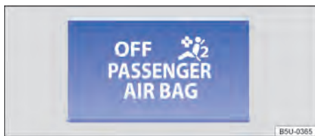
Fig. 32 Luz de controle no painel de instrumentos para o airbag frontal do passageiro desligado.
