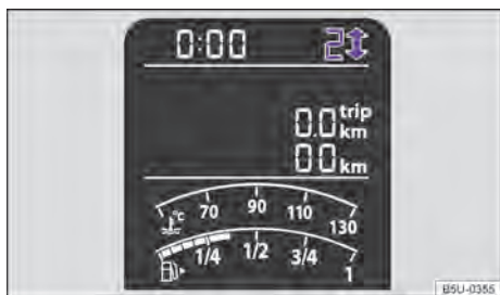
Fig. 82 No instrumento combinado: indicador de troca de marcha (variante 1).
