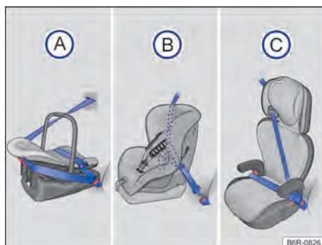
Fig. 36 As ilustrações A, B e C mostram a fixação do sistema de retenção para crianças apenas com o cinto de segurança do veículo.
