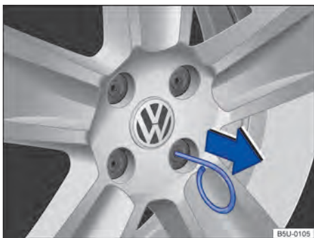
Fig. 218 Retirar as capas de cobertura dos parafusos da roda.
