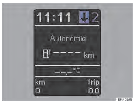
Fig. 83 No instrumento combinado: indicador de troca de marcha (variante 2).
