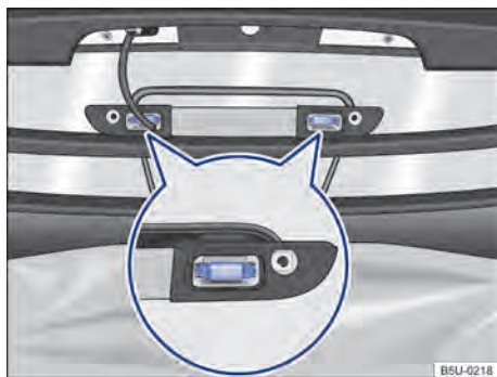
Fig. 192 Lanterna de freio elevada: remover a lâmpada incandescente da iluminação do compartimento de carga.
