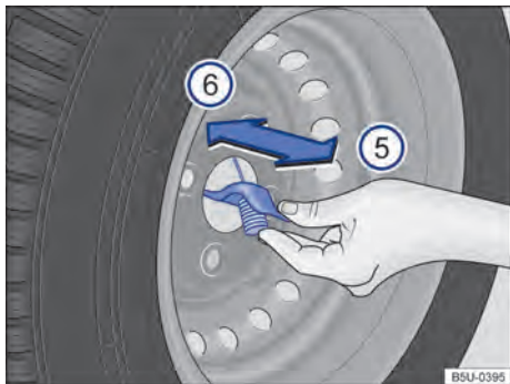
Fig. 216 Na roda de emergência: remover o cabo da roda de emergência.
