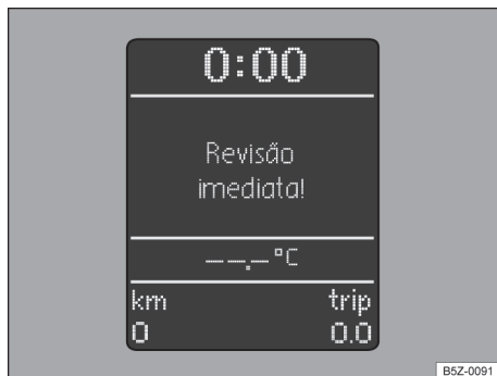
Fig. 16 Display do instrumento combinado: indicador do intervalo de serviço.
