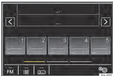
Fig. 134 Operação do rádio: busca automática em andamento (SCAN).
