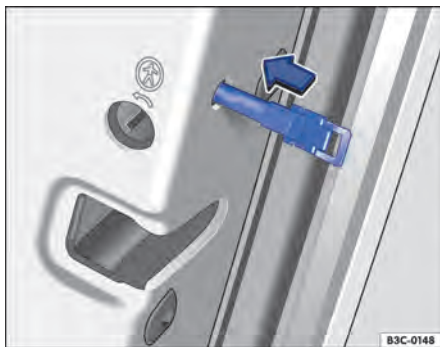
Fig. 243 Na parte dianteira da porta traseira direita: travamento de emergência do veículo com a chave de emergência.
