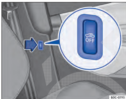
Fig. 33 Ao lado do banco do condutor: botão para desligar o monitoramento do interior do veículo e o alarme antirrebocagem.
