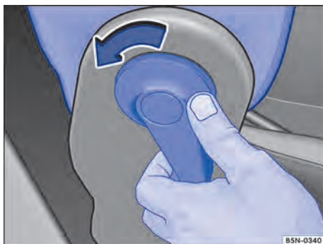
Fig. 66 Destruvar o encosto do banco do passageiro dianteiro rebatível.
