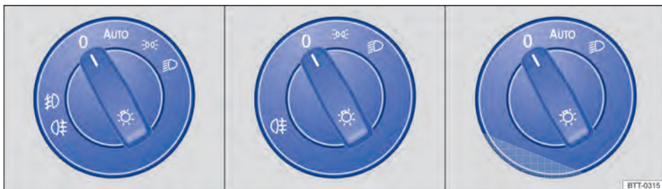
Fig. 97 Ao lado do volante: interruptor de luzes (representação de algumas variantes).
