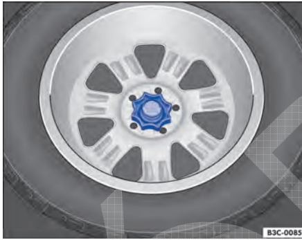
Fig. 235 No compartimento de bagagem: volante para fixação da roda sobressalente.
