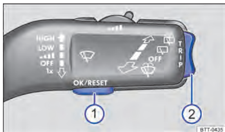
Fig. 16 Veículos sem volante multifunções: botão ① na alavanca dos limpadores dos vidros (à direita da coluna de direção) para confirmar itens de menu e chave ② para alternar os menus.
