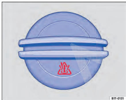
Fig. 226 No compartimento do motor: tampa do reservatório do líquido de arrefecimento do motor.
