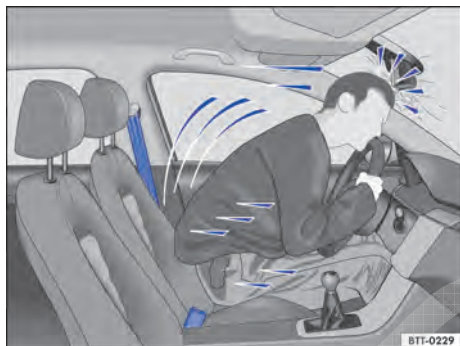
Fig. 71 O condutor sem cinto de segurança é lançado para frente.
