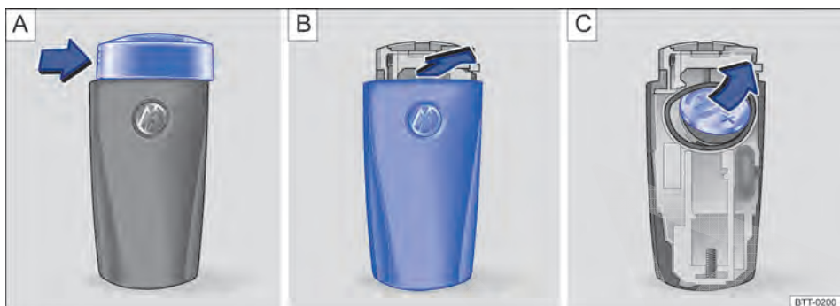
Fig. 27 Abrir a cobertura da bateria da chave do veículo.
