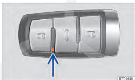
Fig. 25 Luz de controle da chave do veículo.
