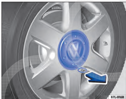
Fig. 252 Retirar a calota central.
