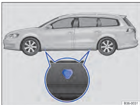
Fig. 258 Pontos de apoio do macaco.
