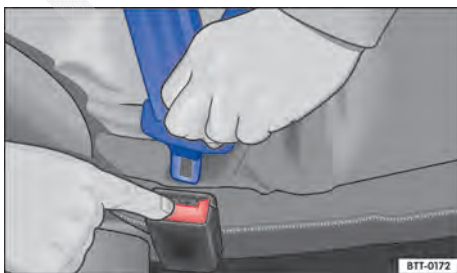
Fig. 75 Soltar a lingueta do cinto de segurança do fecho do cinto de segurança.
