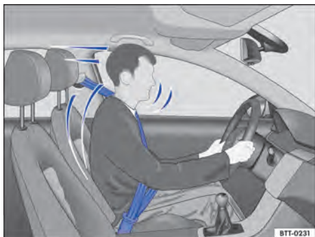
Fig. 73 Conductor protegido pelo cinto de segurança colocado corretamente em uma manobra de frenagem súbita.
