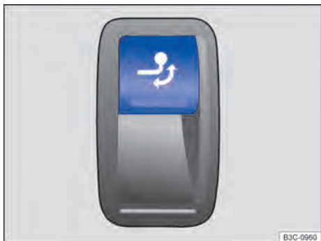
Fig. 134 No compartimento de bagagem à direita: botão para destravamento da rótula de engate.
