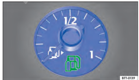
Fig. 215 No instrumento combinado: indicador do nível de combustível para gás natural.
