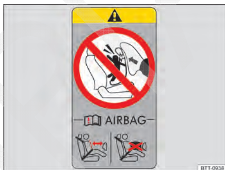
Fig. 87 Na coluna B do lado do passageiro dianteiro: etiqueta adesiva do airbag.
