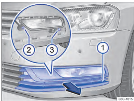
Fig. 272 No para-choque dianteiro à esquerda: lanterna para luz de neblina, farol de rotação direita e farol de conversão.
