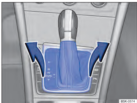
Fig. 247 Destinstalar a cobertura do quadro da alavanca seletora.
