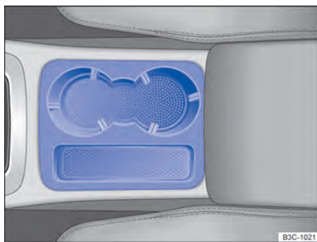
Fig. 148 No console central dianteiro: porta-bebidas (variante 2).
