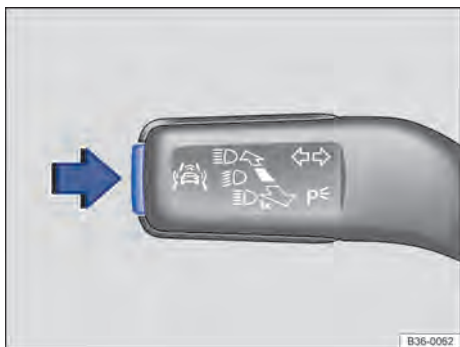
Fig. 18 Na alavanca dos indicadores de direção e do farol alto à esquerda da coluna de direção: botão dos sistemas de assistência ao condutor.
