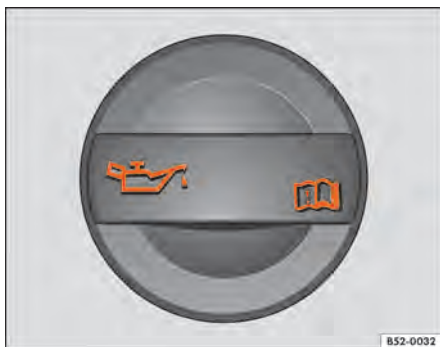
Fig. 223 No compartimento do motor: tampa da abertura para enchimento de óleo do motor.
