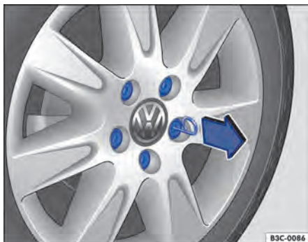
Fig. 255 Remover as capas de cobertura dos parafusos de roda.
