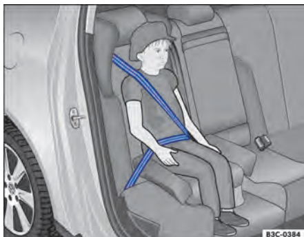
Fig. 93 Cadeira de criança integrada: posição do cadarço do cinto de segurança.
