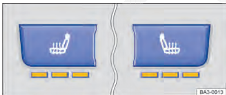
Fig. 58 No console central: teclas do aquecimento dos bancos dos assentos dianteiros.
