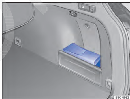
Fig. 250 No compartimento de bagagem à direita: porta-objetos com bolsa com ferramentas de bordo e, se for o caso, bolsa com macaco e chave de roda.
