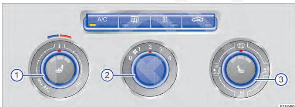
Fig. 209 No console central: Elementos de operação do ar condicionado (manual).
