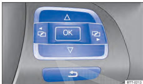
Fig. 17 No lado direito do volante multifunções: botões para comandar os menus do instrumento combinado.
