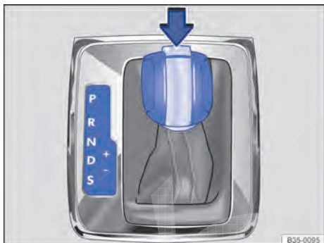
Fig. 166 Direção à esquerda: alavanca seletora da transmissão automática com trava de bloqueio (seta).
