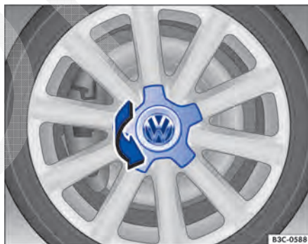
Fig. 253 Desparafusar a calota central.
