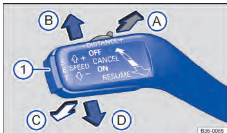
Fig. 196 Alavanca de operação ACC à esquerda na coluna de direção: regular a velocidade.
