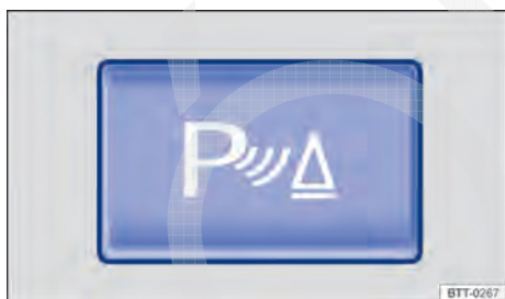
Fig. 180 Na parte inferior do console central: botão para ligar e desligar o Park Pilot.
