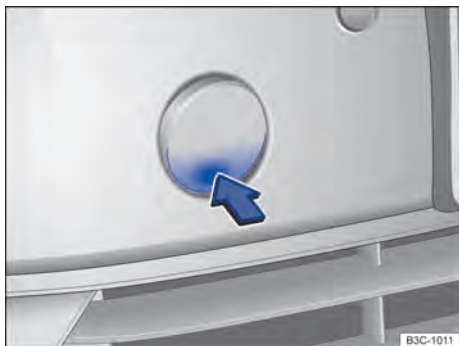
Fig. 283 No para-choque dianteiro à direita: retirar a cobertura.
