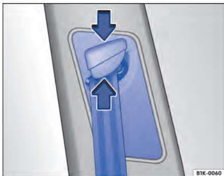
Fig. 78 Ao lado dos bancos dianteiros: regulagem de altura do cinto de segurança.
