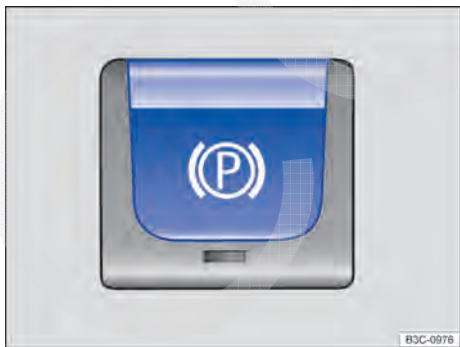
Fig. 170 Na parte inferior do console central: botão do freio de estacionamento eletrônico.
