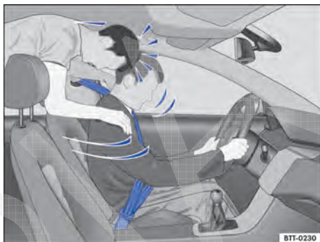
Fig. 72 O passageiro sem cinto de segurança no banco traseiro é lançado para frente sobre o condutor com cinto de segurança.
