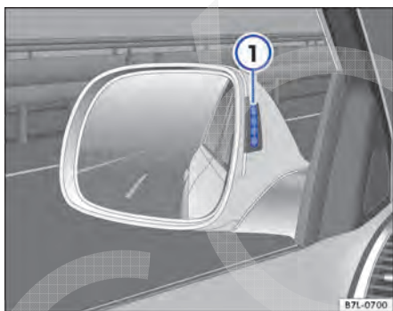
Fig. 204 No espelho retrovisor externo: indicador do assistente de mudança de faixa.
