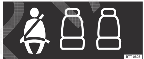
Fig. 68 Indicador do status do cinto para os assentos traseiros no instrumento combinado.
