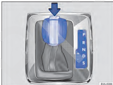
Fig. 167 Direção à direita: alavanca seletora da transmissão automática com trava de bloqueio (seta).
