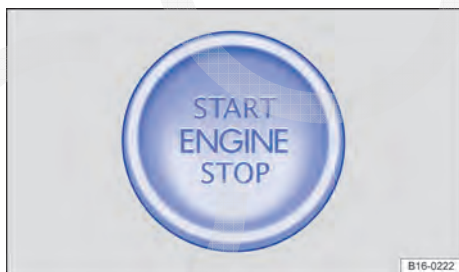
Fig. 160 Na parte inferior do console central: botão de partida do sistema de travamento e de partida Keyless Access sem chave.
