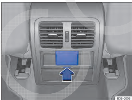
Fig. 156 Console central traseiro: abrir a cobertura com uma tecla.
