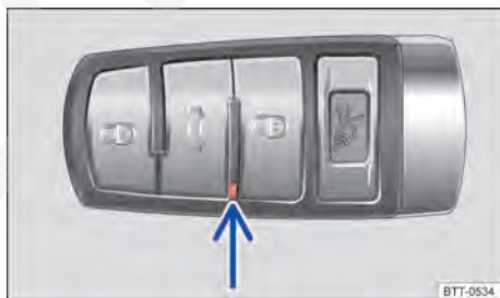
Fig. 26 Luz de controle da chave do veículo.
