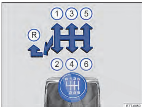
Fig. 165 Esquema de troca de marchas da transmissão manual de 6 marchas.
