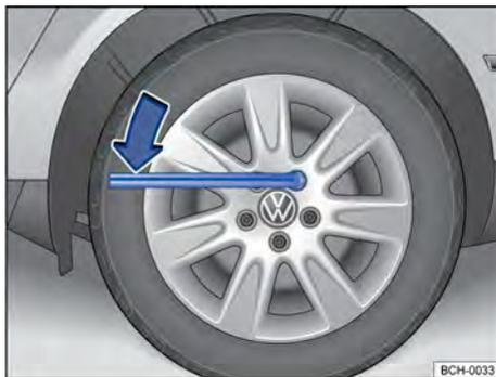
**Fig. 193** Troca de roda: soltar os parafusos da roda.
