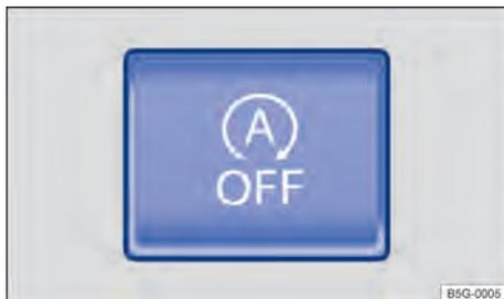
**Fig. 89** Na parte superior do console central: botão do sistema Start-Stop.
