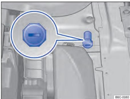
Fig. 174 No compartimento do motor: ponto de auxílio à partida (ponto de aterramento).
