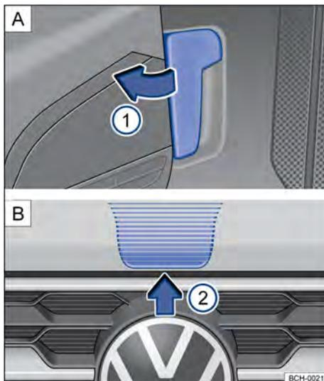
**Fig. 176** **A** Alavanca de destravamento da tampa do compartimento do motor na área para os pés do lado do condutor. **B** Alavanca de destravamento na parte interna da tampa do compartimento do motor. ▶
