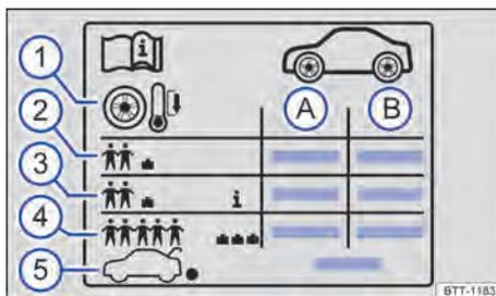
Fig. 188 Etiqueta com as pressões dos pneus.
