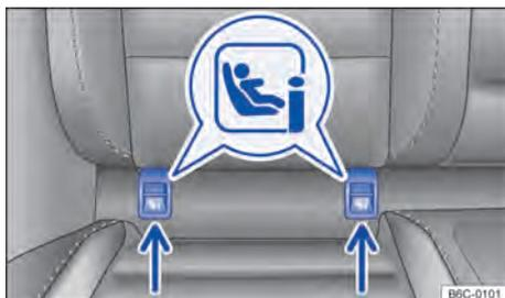
**Fig. 41** No banco do veículo: identificação dos pontos de ancoragem inferiores para cadeiras de criança.
