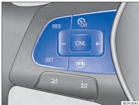
Fig. 96 Lado esquerdo do volante multifunções (variante 1); botões para comandar o limitador de velocidade.
