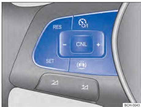
Fig. 94 Lado esquerdo do volante multifunções (variante 1); botões para comandar o GRA
