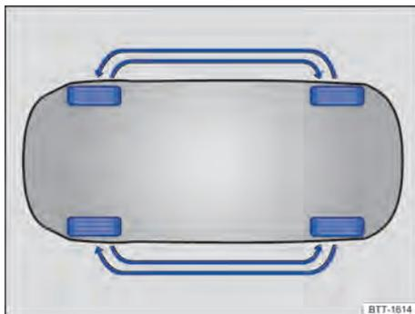
Fig. 187 Esquema para a troca das rodas.
