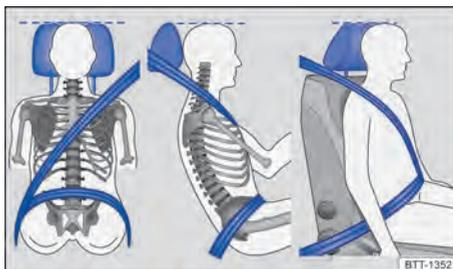
Fig. 29 Posição correta do cadarço do cinto de segurança e ajuste correto do apoio para cabeça.
