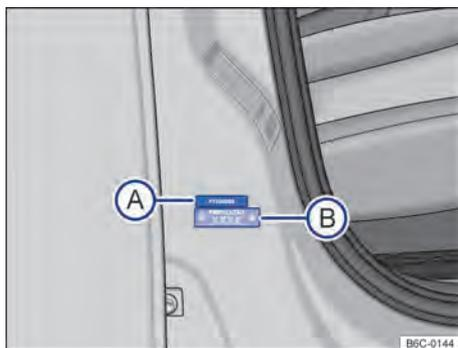
Fig. 200 Na área inferior da coluna da porta dianteira direita: etiqueta com número de identificação do veículo parcial (VIS) (A) e placa do ano de fabricação (B).
