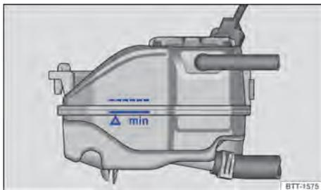
Fig. 182 No compartimento do motor: marcação no reservatório de expansão do líquido de arrefecimento do motor.
