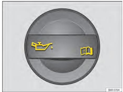
**Fig. 181** No compartimento do motor: tampa da abertura para enchimento de óleo do motor.
