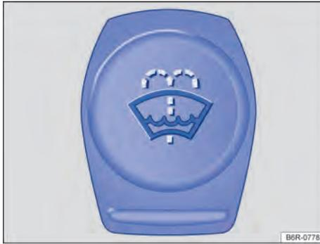
**Fig. 179** No compartimento do motor: tampa do reservatório de água dos lavadores dos vidros.
