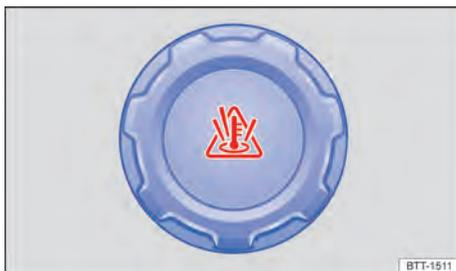
Fig. 183 No compartimento do motor: tampa do reservatório de expansão do líquido de arrefecimento do motor.
