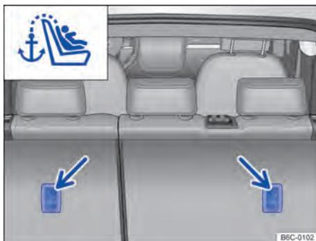
Fig. 42 Olhais de retenção para o cinto de fixação superior no lado de trás do banco traseiro.
