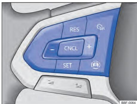
Fig. 97 Lado esquerdo do volante multifunções (variante 2); botões para comandar o limitador de velocidade.
