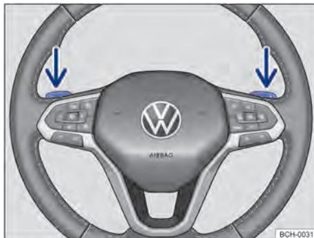
Fig. 92 Volante com seletores basculantes do Tiptronic.
