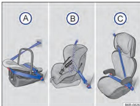
**Fig. 39** As ilustrações (A), (B) e (C) mostram a fixação do sistema de retenção para crianças apenas com o cinto de segurança do veículo.
