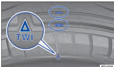
Fig. 190 Perfil do pneu: indicadores de desgaste.
