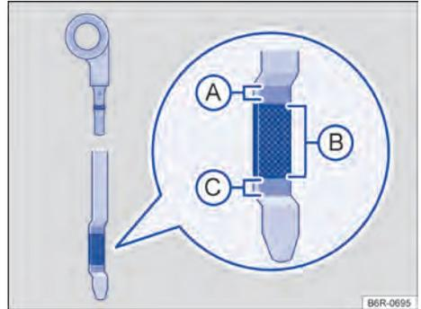
**Fig. 180** Varetas de medição do óleo com marcas de nível do óleo do motor.
