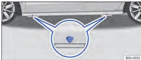
Fig. 194 Pontos de apoio do macaco.
