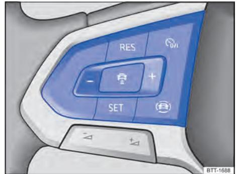
**Fig. 101** Lado esquerdo do volante multifunções: botões para comandar o ACC.
