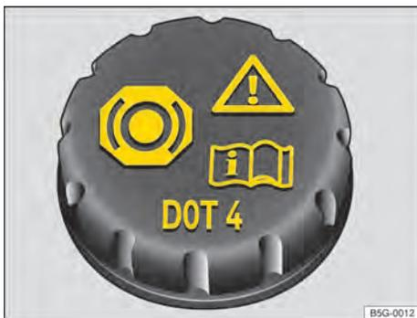
**Fig. 184** No compartimento do motor: tampa do reservatório de fluido de freio.
