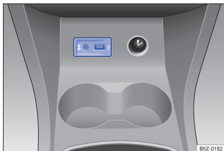
Fig. 104 No console central dianteiro: interface USB e entrada AUX-IN.
