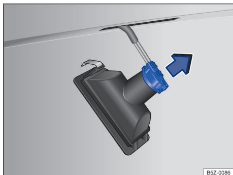
Fig. 132 Lanterna da placa de licença: remover o soquete da lâmpada.
