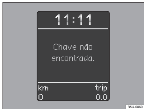
Fig. 84 No instrumento combinado: display com indicação do imobilizador ativado - veículos com Sistema de Informações Volkswagen.
