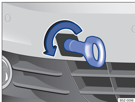
Fig. 142 No para-choque dianteiro à direita: rosquear a argola de reboque.
