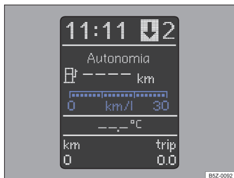
Fig. 14 No instrumento combinado: indicador de consumo de combustível.
