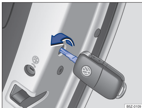
Fig. 49 Travamento de emergência do veículo com a chave do veículo.
