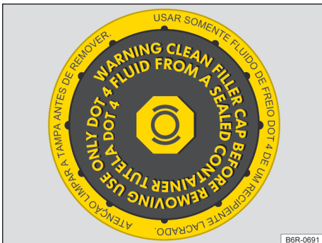
Fig. 154 No compartimento do motor: tampa do reservatório de fluido de freio (variante 1).
