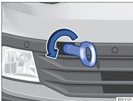
Fig. 144 No para-choque dianteiro à direita: rosquear a argola de reboque.
