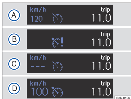
Fig. 92 No display do instrumento combinado: indicadores de status do GRA.
