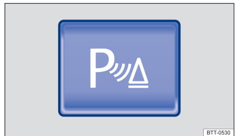
Fig. 95 Na parte superior do console central: botão para ligar e desligar o controle de distância de estacionamento (Park Pilot).
