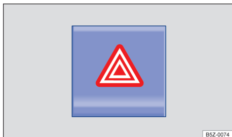
Fig. 36 Na parte superior do console central: interruptor para ligar e desligar as luzes de advertência.
