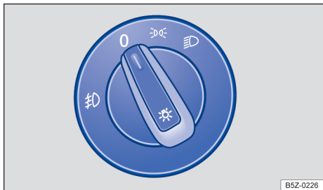
Fig. 65 No painel: interruptor das luzes.
