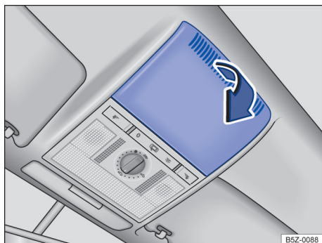
Fig. 54 No revestimento do teto: remover a cobertura.
