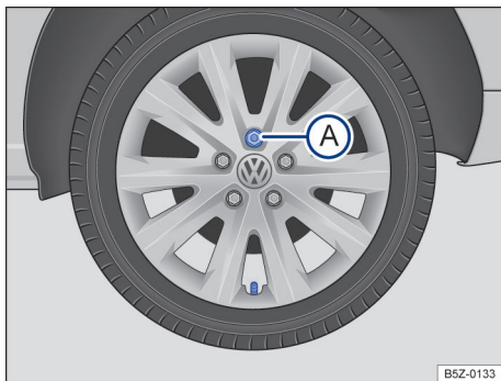
Fig. 168 Troca de roda: sequência de remoção dos parafusos da roda.
