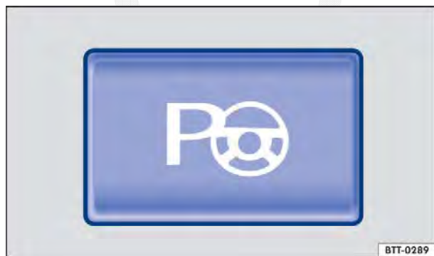
Fig. 160 Na parte inferior do console central: botão para ligar o assistente de direção para estacionamento.
