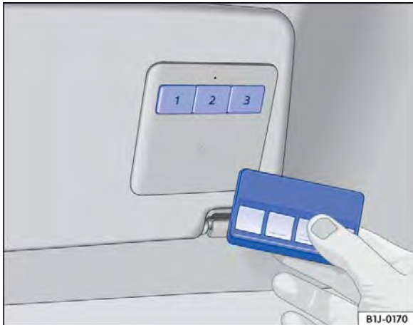
Fig. 36 Controle remoto e botões do comando de abertura de portão de garagem no para-sol.
