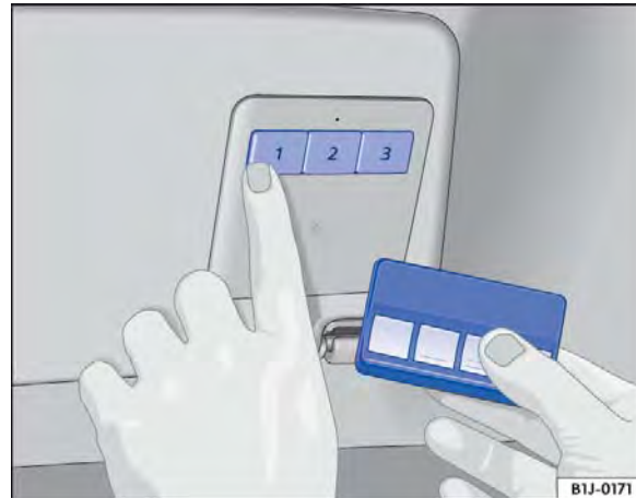
Fig. 37 Para programar: Pressionar ao mesmo tempo tecla para o controle de porta de garagem e o controle remoto.
