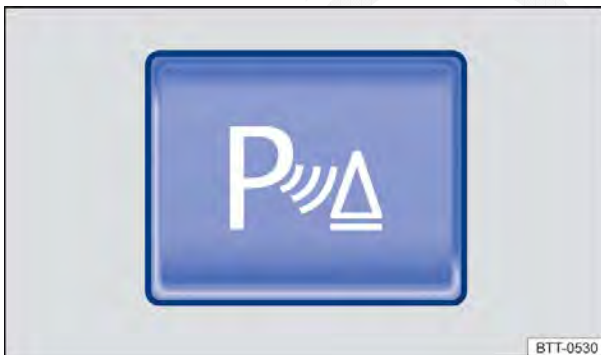
Fig. 148 No console central: botões para ligar e desligar o Park Pilot (depende da versão).
