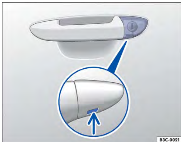
Fig. 217 Maçaneta da porta do condutor: cilindro da fechadura coberto.
