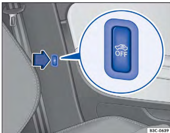
Fig. 28 Ao lado do banco do condutor: botão para desligar o monitoramento do interior do veículo e o alarme antirrebocagem.
