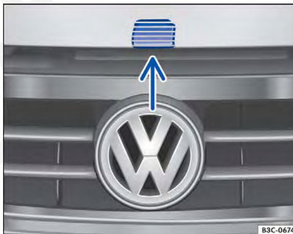
Fig. 196 Acima da grade do radiador: alavanca de abertura da tampa de compartimento do motor
