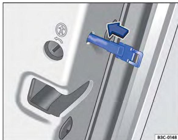
Fig. 219 Na parte dianteira da porta traseira direita: travamento de emergência do veículo com a chave de emergência.
