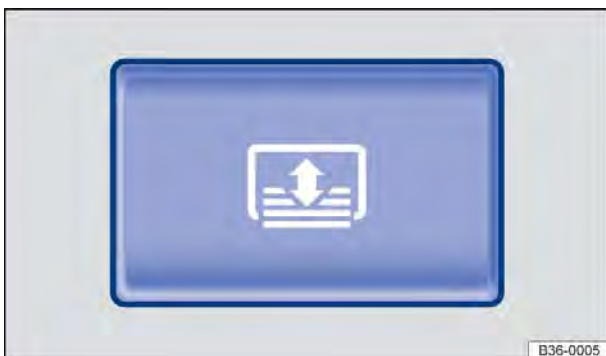
Fig. 85 No console central: interruptor da cortina de proteção solar do vidro traseiro.
