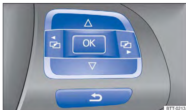
Fig. 15 No lado direito do volante multifunções: botões para comandar os menus do instrumento combinado.
