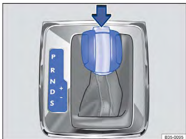
Fig. 138 Veículos com direção à esquerda: alavanca seletora da transmissão automática com botão bloqueador (seta).
