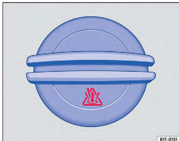
Fig. 201 No compartimento do motor: tampa do reservatório do líquido de arrefecimento do motor.
