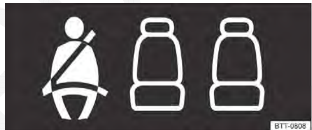
Fig. 58 Indicador de status do cinto de segurança no display do instrumento combinado para os assentos traseiros.
