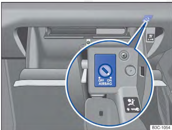
Fig. 72 No porta-luvas: interruptor acionado pela chave para desligar e ligar o airbag frontal do passageiro.
