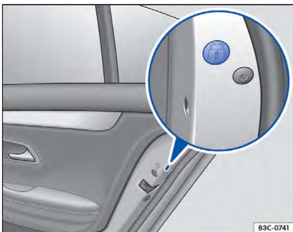
Fig. 218 Na parte dianteira da porta traseira direita: travamento de emergência, coberto por uma vedação de borracha.
