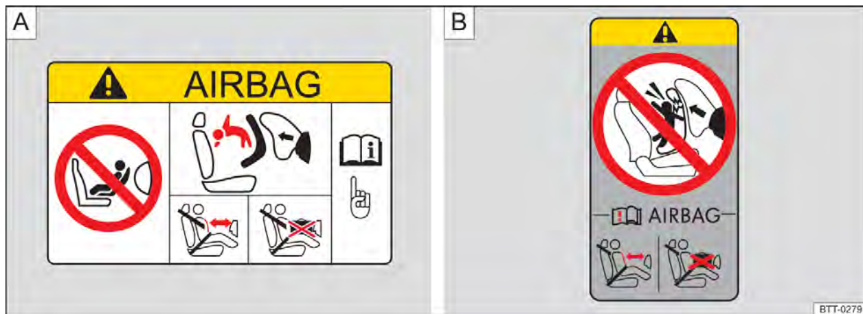
Fig. 75 Representação esquemática: etiqueta do airbag no para-sol A ou na coluna B .
