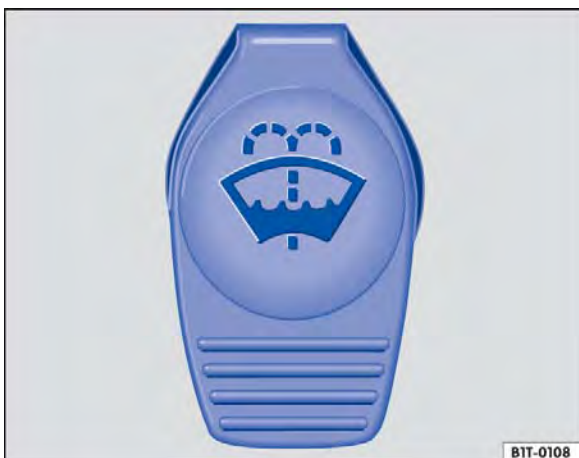
Fig. 91 No compartimento do motor: tampa do reservatório de água dos lavadores do para-brisa.
