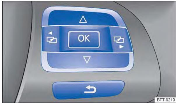
**Fig. 15** No lado direito do volante multifunções: botões para comandar os menus do instrumento combinado.
