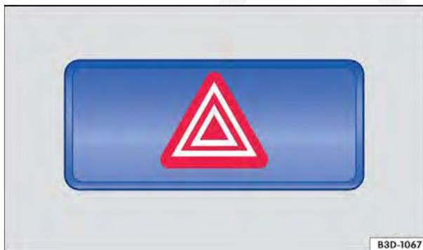
**Fig. 215** Na parte superior do console central: interruptor das luzes de advertência.
