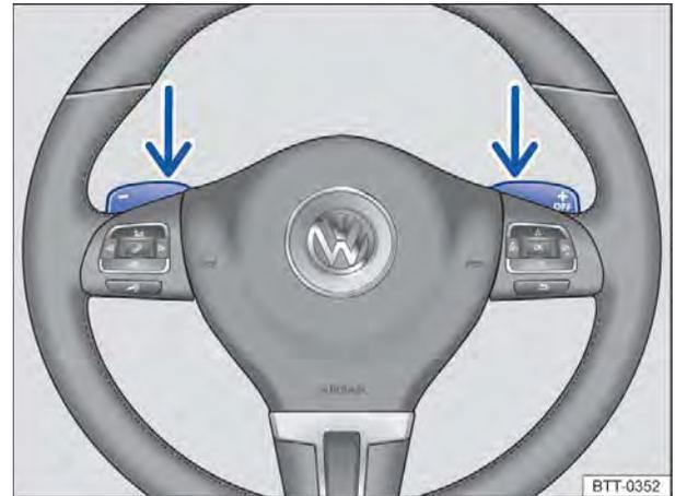
**Fig. 146** Volante com 2 seletores basculantes do Tiptronic.
