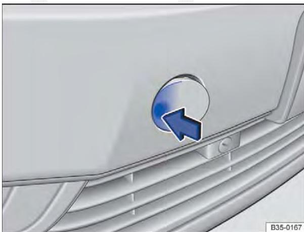
**Fig. 259** No para-choque dianteiro à direita: retirar a cobertura.
