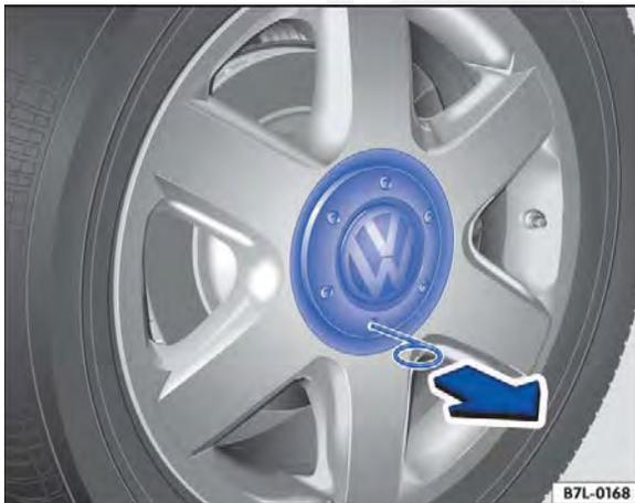
Fig. 228 Retirar a calota central.
