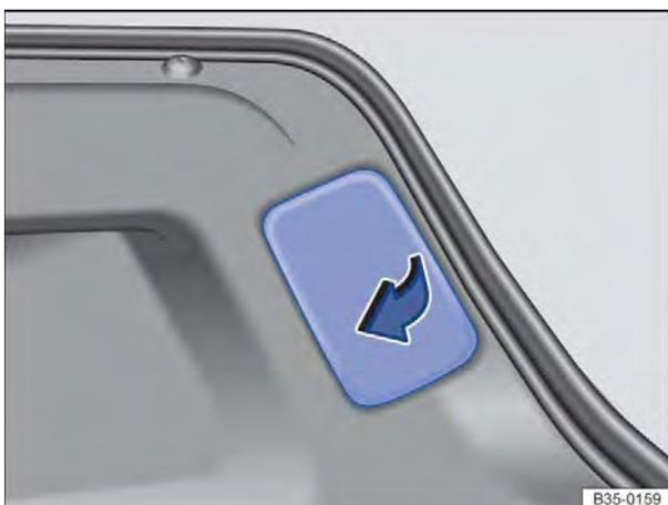
**Fig. 250** Na tampa do compartimento de bagagem: retirar a cobertura.
