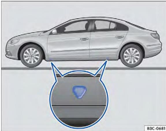
Fig. 234 Pontos de apoio do macaco.
