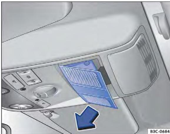
**Fig. 222** No revestimento do teto: remover a cobertura.
