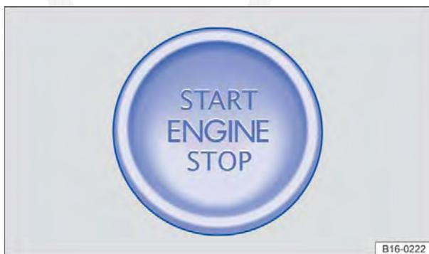
**Fig. 137** Na parte inferior do console central: botão de partida do sistema de fechamento e partida sem chave Keyless Access.
