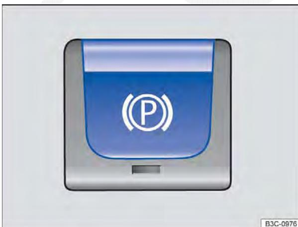
**Fig. 147** Na parte inferior do console central: botão do freio de estacionamento eletrônico.
