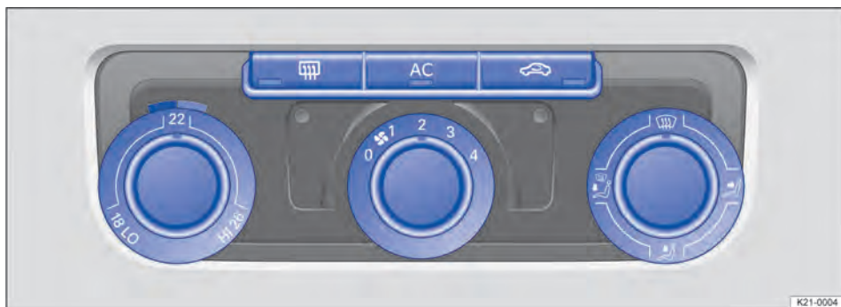
Fig. 85 No painel de instrumentos: elementos de comando do Climatic.
