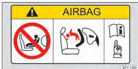
Fig. 36 Representação esquemática: etiqueta do airbag no para-sol.
