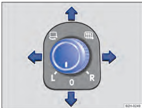
Fig. 82 Na porta do condutor: botão rotativo dos espelhos retrovisores externos.
