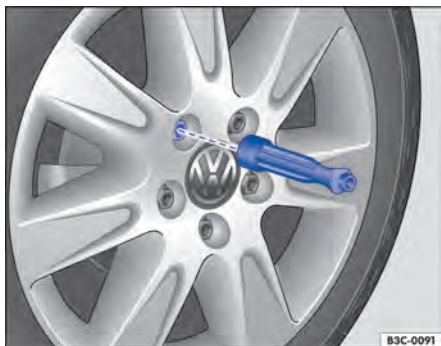
Fig. 211 Troca de roda: desaparafusar os parafusos de roda com o punho da chave de fenda.
