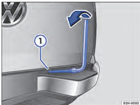
Fig. 197 Controlar a corda de elevação com o guincho.
