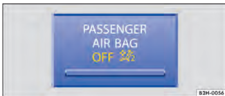
Fig. 28 Na parte superior do console central: luz de controle para o airbag frontal do passageiro dianteiro desligado.
