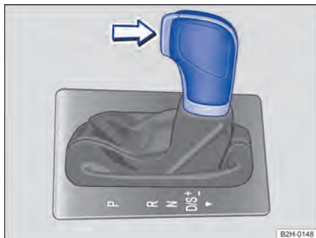
Fig. 93 Volante à esquerda: alavanca seletora da transmissão automática com botão bloqueador (seta). Em veículos com direção à direita, a disposição dos elementos é espelhada.
