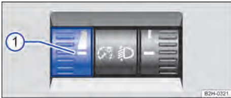
Fig. 75 Ao lado do volante: regulador da regulação da iluminação dos instrumentos e dos interruptores.
