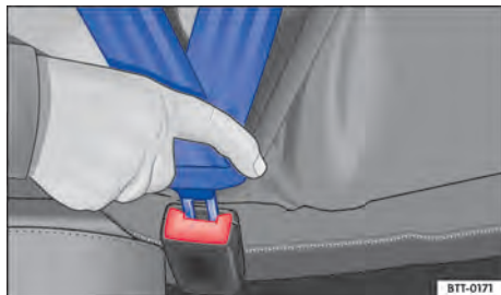
Fig. 19 Introduzir a lingueta do cinto de segurança no fecho do cinto de segurança.
