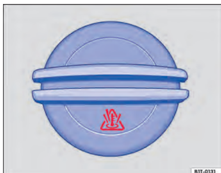
Fig. 180 No compartimento do motor: tampa do reservatório de expansão do líquido de arrefecimento do motor.
