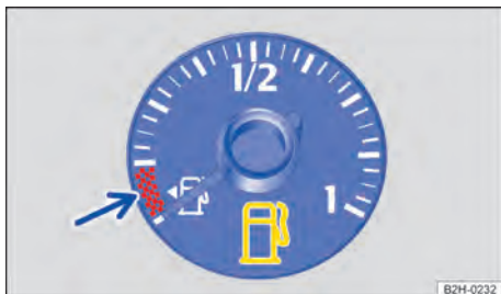
Fig. 14 Indicador do nível de combustível no instrumento combinado analógico (representação esquemática).
