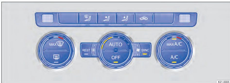
Fig. 86 No painel de instrumentos: elementos de comando do Climatronic.
