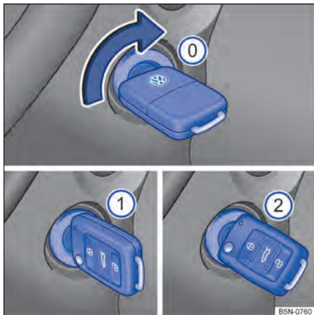
Fig. 90 Ao lado do volante à direita: posições da chave do veículo no cilindro da ignição.
