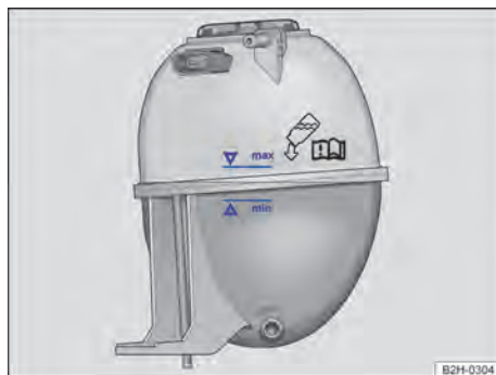
Fig. 181 No compartimento do motor: marca no reservatório de expansão do líquido de arrefecimento do motor (representação esquemática).
