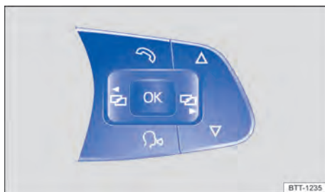
Fig. 12 No volante multifunções: botões para operação dos menus no instrumento combinado.
