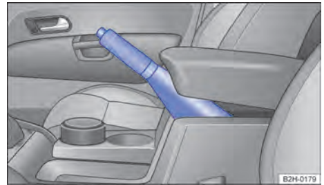
Fig. 107 Entre os assentos dianteiros: freio de estacionamento.
