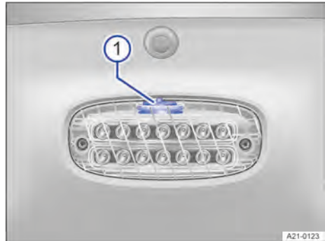
Fig. 77 Sobre a tampa do compartimento de carga: interruptor da iluminação da capota rígida do compartimento de carga.
