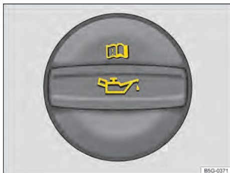
Fig. 179 No compartimento do motor: tampa da abertura para enchimento de óleo do motor (representação esquemática).
