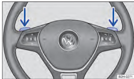
Fig. 95 Volante com seletores basculantes do Tiptronic.
