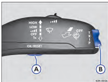
Fig. 13 Na alavanca do limpador de para-brisa: botões para operar os menus.
