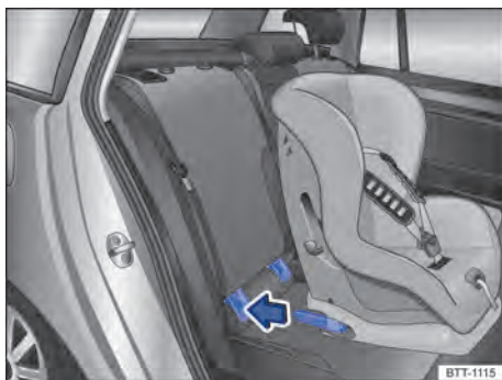
Fig. 39 Representação esquemática: instalar a cadeira de criança ISOFIX com os braços de apoio.
