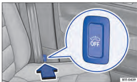
Fig. 49 Ao lado do banco do condutor: botão para desligar o monitoramento do interior do veículo e o alarme antirrebocagem.
