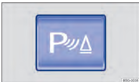
Fig. 109 No console central: botão para ligar ou desligar o auxílio de estacionamento (depende da versão).
