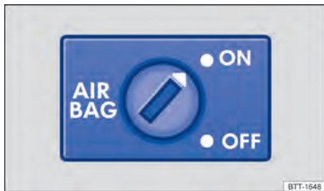
Fig. 31 Na parte frontal no lado do passageiro dianteiro: interruptor acionado pela chave para desativar e ativar o airbag frontal do passageiro dianteiro.
