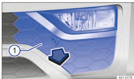
Fig. 148 Para-choque dianteiro: remover o protetor.
