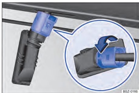
Fig. 157 Lanterna da placa de licença: desinstalar o suporte da lâmpada.
