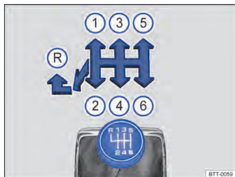
Fig. 92 Esquema de troca de marchas da transmissão manual de 6 marchas.
