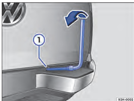
Fig. 203 Colocar a roda sobressalente sobre o guincho.
