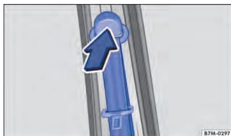
Fig. 27 Ao lado dos bancos dianteiros: regulagem de altura do cinto de segurança.
