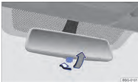
Fig. 81 No para-brisa: espelho retrovisor interno com antiofuscante manual.
