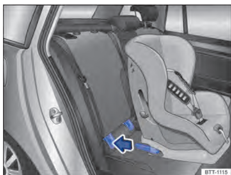
Fig. 41 Representação esquemática: instalar a cadeira de criança ISOFIX com os braços de apoio.
