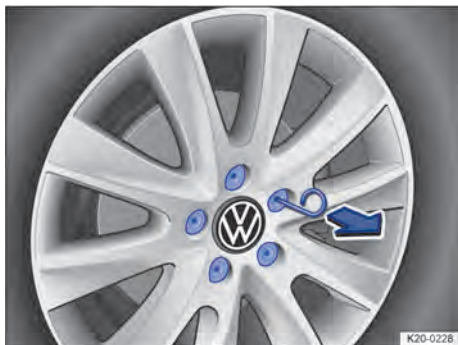
Fig. 193 Remover as capas de cobertura dos parafusos de roda.
