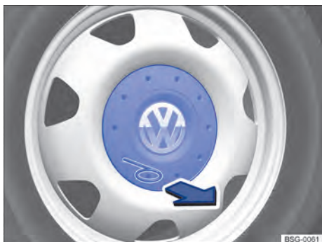
Fig. 192 Retirar a calota central.
