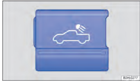
Fig. 76 No console central: botão da iluminação do compartimento de carga.
