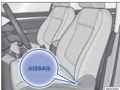
Fig. 33 Na lateral no banco dianteiro: local de instalação do airbag para cabeça e laterais combinado (variante 1).
