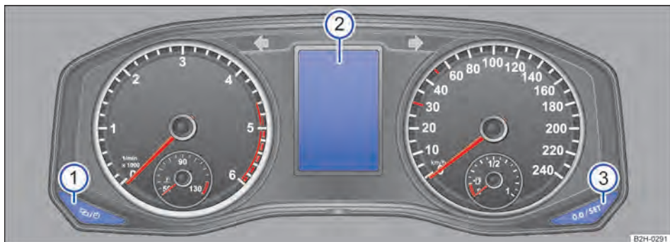
Fig. 186 Botões no instrumento combinado no painel de instrumentos.
