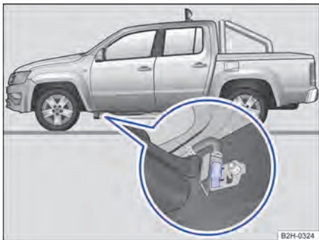
Fig. 135 Na parte inferior do veículo, na longarina: bужão de drenagem do filtro do óleo diesel (dependendo da versão).
