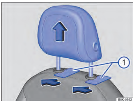
Fig. 66 No banco dianteiro: remover o apoio para cabeça (variante 1).
