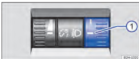
Fig. 74 Ao lado do volante: regulador do alcance do farol ①.
