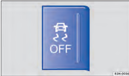
Fig. 113 No controle central: botão para desligar e ligar o ASR manualmente.
