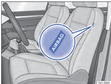
Fig. 34 Na lateral no banco dianteiro: local de instalação do airbag para cabeça e laterais combinado (variante 2).
