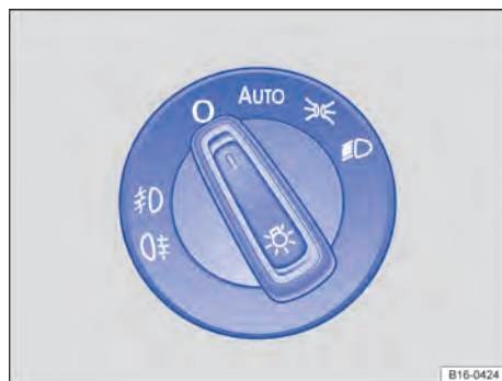
Fig. 71 Ao lado do volante: interruptor de luzes (uma variante).
