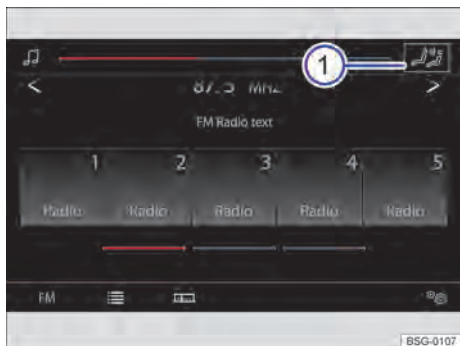
Fig. 120 Exibição do display no console central: superfície de função para acessar o amplificador de voz eletrônico.
