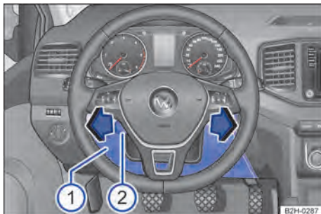
Fig. 161 No lado do condutor, veículos com direção à esquerda: caixa de fusíveis atrás do revestimento do painel de instrumentos.
