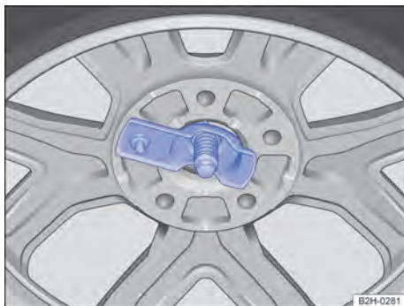
Fig. 201 Roda sobressalente ou de emergência: colocação correta do suporte do aro no orifício do aro.
