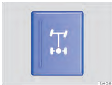
Fig. 102 No console central: botão do bloqueio do diferencial (representação esquemática)
