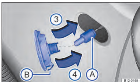
Fig. 155 Lanterna lateral dos indicadores de direção: substituir lâmpada incandescente.
