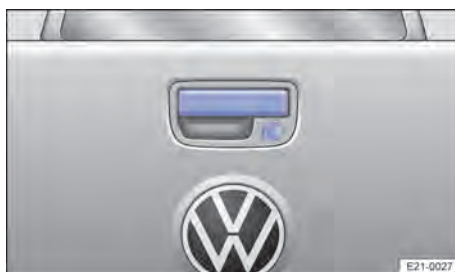
Fig. 50 Na tampa do compartimento de carga: alça para abrir a tampa do compartimento de carga.
