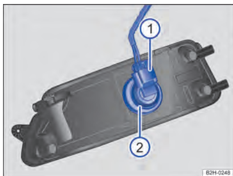
Fig. 150 Substituir a lâmpada incandescente do farol.
