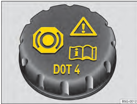
Fig. 183 No compartimento do motor: tampa do reservatório do fluido de freio.
