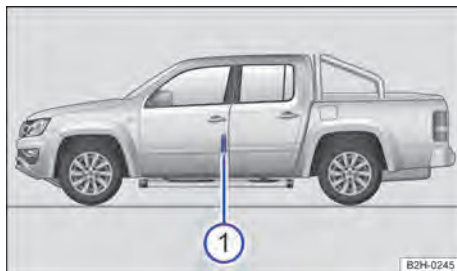
◀ Fig. 189 Na porta do condutor ①: etiqueta de pressão dos pneus (alternativamente no lado interno da portinhola do tanque).
