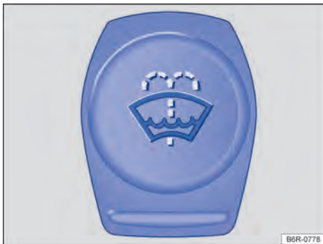
Fig. 175 No compartimento do motor: tampa do reservatório de água dos lavadores do para-brisa.
