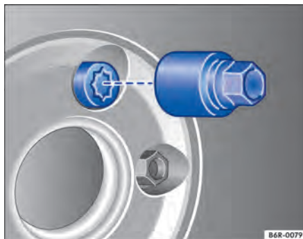
Fig. 195 Troca de roda: parafusos de roda antifurto e adaptador.
