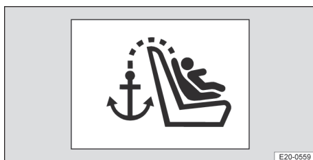
Fig. 42 Representação esquemática: identificação para o ponto de fixação do Top Tether.
