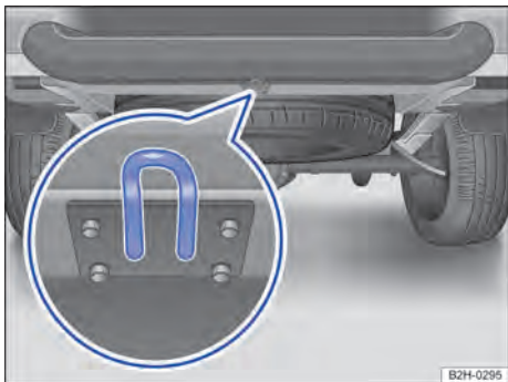
Fig. 167 Abaixo do para-choque: argola de reboque em veículos sem dispositivo de reboque de fábrica.
