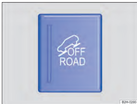
Fig. 98 No console central: botão para ligar e desligar a função off-road manualmente.
