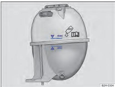
**Fig. 171** No compartimento do motor: marcações no reservatório de expansão do líquido de arrefecimento (representação esquemática).
