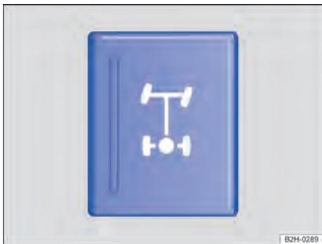
**Fig. 103** No console central: botão do bloqueio do diferencial.
