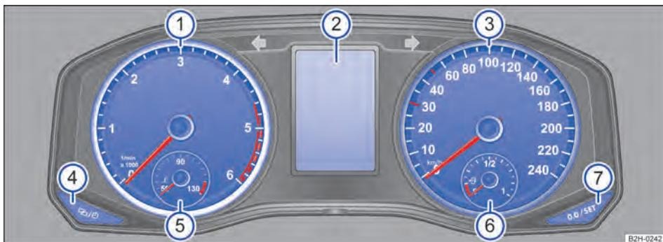
Fig. 11 Instrumento combinado analógico no painel de instrumentos.
