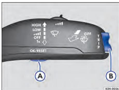
**Fig. 15** Na alavanca do limpador de para-brisa: botões para operar menus
