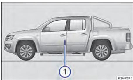
Fig. 180 Na porta do condutor: etiqueta de pressão dos pneus.
