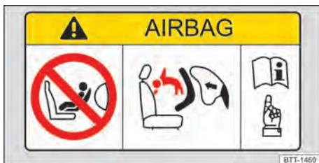
Fig. 40 Representação esquemática: etiqueta do airbag no para-sol.
