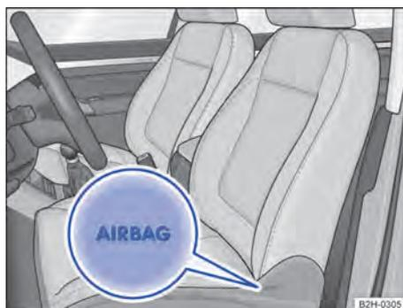
Fig. 37 Na lateral no banco dianteiro: local de instalação do airbag para cabeça e laterais combinado.
