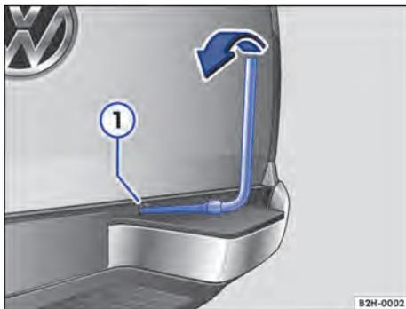
Fig. 188 Controlar a corda de elevação com o guincho.
