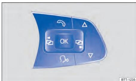
**Fig. 16** No volante multifunções: botão para operação do menu no instrumento combinado.
