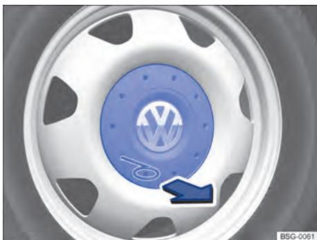
Fig. 183 Retirar a calota central.
