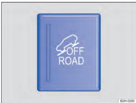
**Fig. 99** No console central: botão para ligar e desligar a função off-road manualmente.
