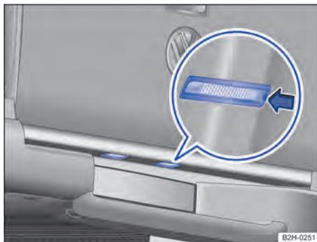
Fig. 149 Na chapa terminal traseira embaixo da tampa do compartimento de carga: lanternas da placa de licença.
