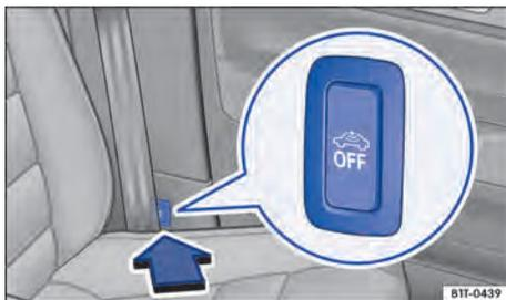
**Fig. 50** Ao lado do banco do condutor: botão para desligar o monitoramento do interior do veículo e o alarme antirrebocagem.
