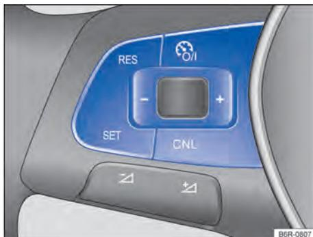
**Fig. 107** Lado esquerdo do volante multifunções: botões para comandar o GRA.
