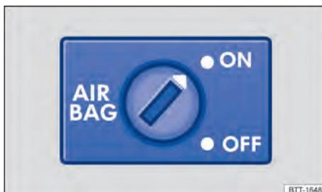
**Fig. 36** Na parte frontal no lado do passageiro dianteiro: interruptor acionado pela chave para desativar e ativar o airbag frontal do passageiro dianteiro.
