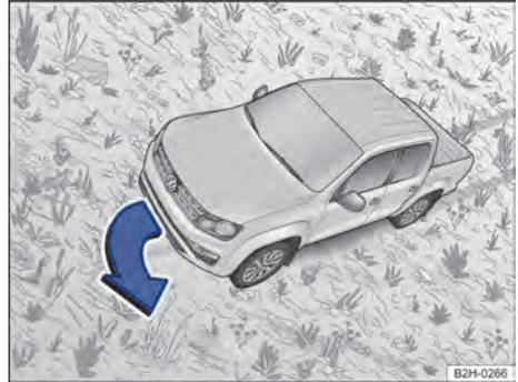
Fig. 104 Representação esquemática: dirigir na linha de inclinação.
