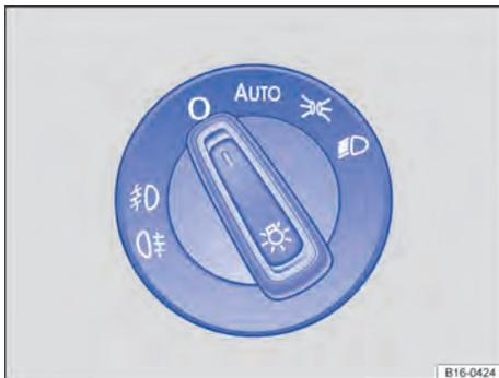
Fig. 71 Ao lado do volante: interruptor de luzes (uma variante).
