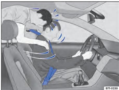
**Fig. 22** O passageiro sem cinto de segurança no banco traseiro é lançado para frente sobre o condutor com cinto de segurança.
