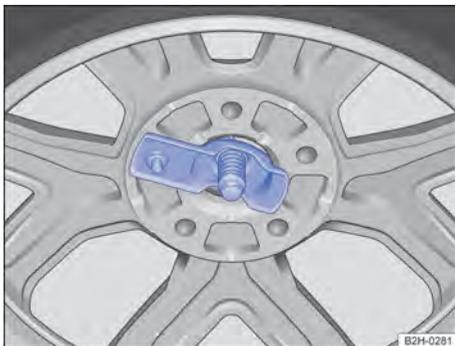
**Fig. 192** Roda sobressalente ou de emergência: colocação correta do suporte do aro no orifício do aro.
