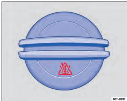
**Fig. 172** No compartimento do motor: tampa do reservatório de expansão do líquido de arrefecimento do motor.
