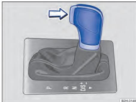
**Fig. 94** Volante à esquerda: alavanca seletora da transmissão automática com botão bloqueador (seta). Em veículos com direção à direita, a disposição dos elementos é espelhada.
