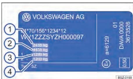
Fig. 206 Na porta dianteira esquerda na coluna B: plaqueta de identificação.
