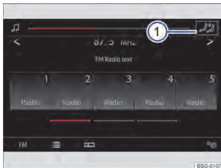
Fig. 119 Exibição do display no console central: superfície de função para acessar o amplificador de voz eletrônico.
