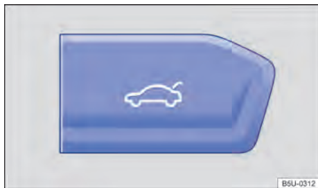
Fig. 51 Na parte superior do console central: tecla de abertura da tampa traseira.
