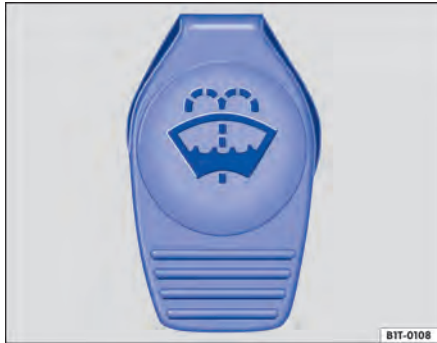
Fig. 126 No compartimento do motor: tampa do reservatório de água dos lavadores do para-brisa.
