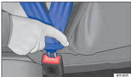
Fig. 27 Introduzir a lingueta do cinto de segurança no fecho do cinto de segurança.
