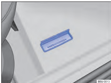
Fig. 150 Em frente ao banco do passageiro dianteiro: número de identificação do veículo (número do chassi) no assoalho, em frente ao banco do passageiro dianteiro.
