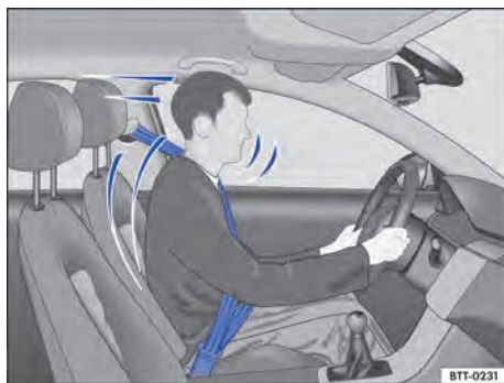
Fig. 26 Condutor protegido pelo cinto de segurança colocado corretamente em uma manobra de frenagem súbita. ▶
