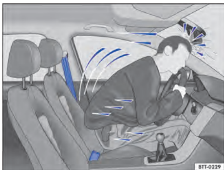
Fig. 24 O condutor sem cinto de segurança é lançado para frente.
