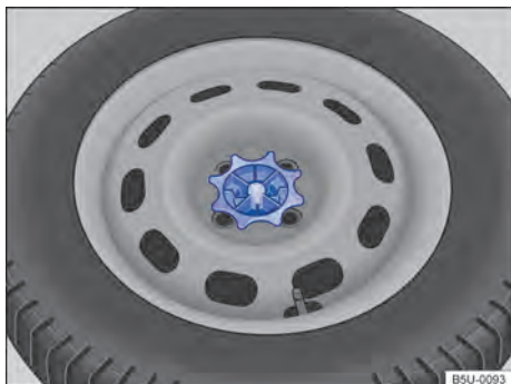
Fig. 138 No compartimento de bagagem: manípulo para fixação da roda de emergência.
