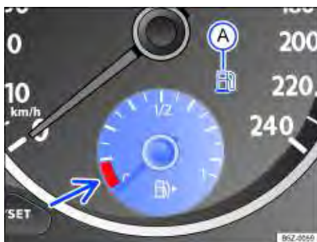
Fig. 125 No instrumento combinado: indicador do nível de combustível.
