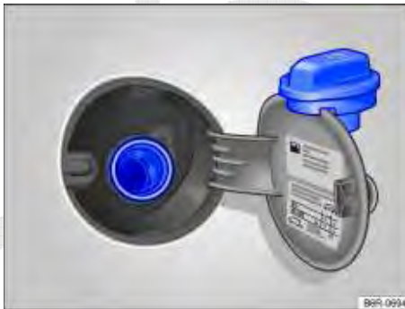
Fig. 126 Portinhola do tanque de combustível aberta com a tampa do tanque de combustível pendurada.
