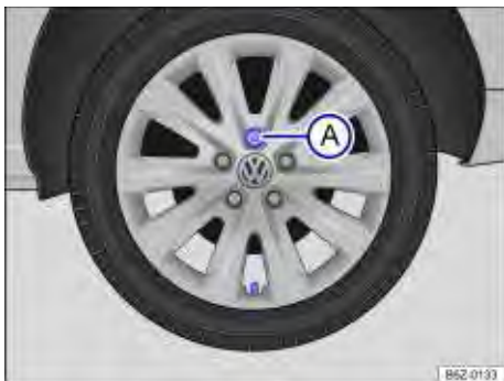
Fig. 163 Retirar a calota integral.
