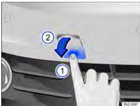
Fig. 187 No para-choque dianteiro à direita: soltar e remover a cobertura.
