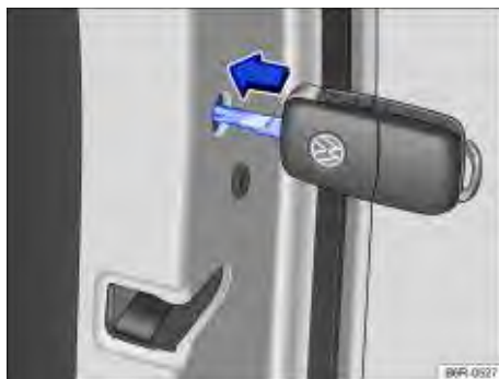
Fig. 156 Travamento de emergência do veículo com a chave do veículo.
