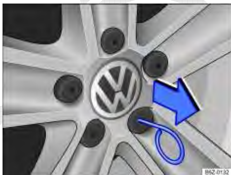
Fig. 162 Retirar as capas de cobertura dos parafusos da roda.
