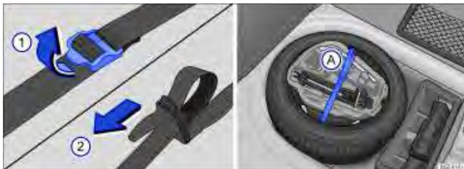
Fig. 160 No compartimento de bagagem: cinta de fixação da caixa de ferramentas e caixa de ferramentas de bordo.
