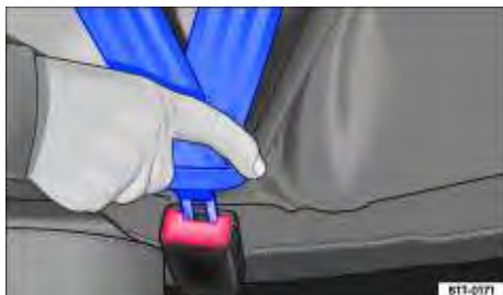
Fig. 49 Introduzir a lingueta do cinto de segurança no fecho do cinto de segurança.
