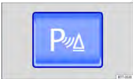
Fig. 114 Na parte superior do console central: botão para ligar e desligar o controle de distância de estacionamento (Park Pilot).
