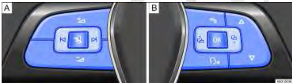
Fig. 15 Volante multifunções: teclas de comando.
