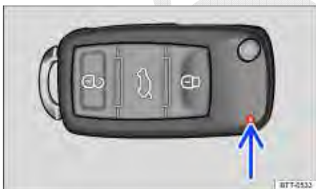
Fig. 22 Luz de controle da chave do veículo com comando remoto.
