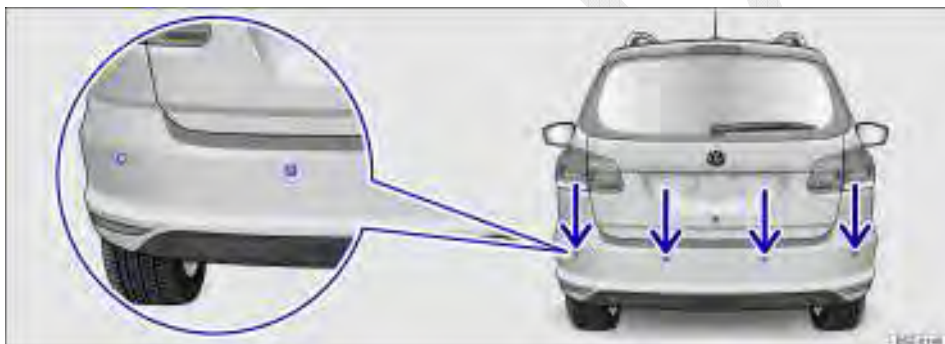
Fig. 116 Sensores de ultrassom do controle de distância de estacionamento no para-choque traseiro.
