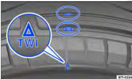
Fig. 142 Perfil do pneu: indicadores de desgaste.
