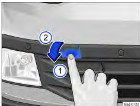
Fig. 189 No para-choque dianteiro à direita: soltar e remover a cobertura.
