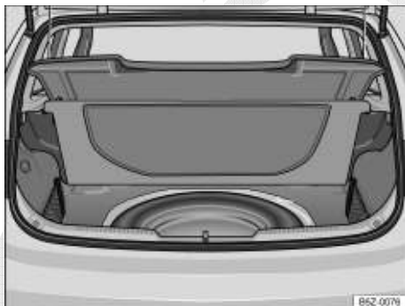
Fig. 159 No compartimento de bagagem, sob o revestimento do assoalho: roda de emergência e ferramentas de bordo.
