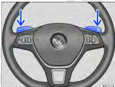
Fig. 105 Volante com dois seletores para troca de marcha no modo manual.
