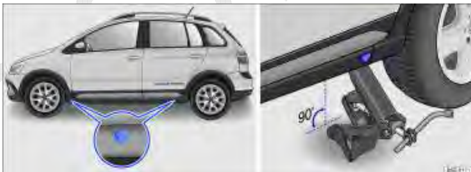
Fig. 166 Pontos de apoio do macaco e macaco posicionado no lado esquerdo traseiro do veículo.
