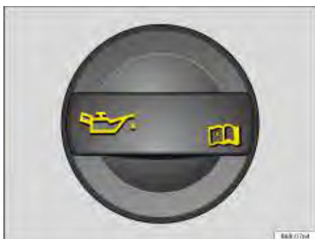
Fig. 130 No compartimento do motor: tampa de abertura para enchimento de óleo do motor.
