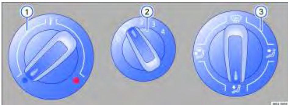
Fig. 121 No console central: comandos do sistema de ventilação e aquecimento.
