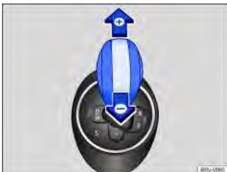
Fig. 104 Alavanca seletora na posição para condução de marcha no modo manual.
