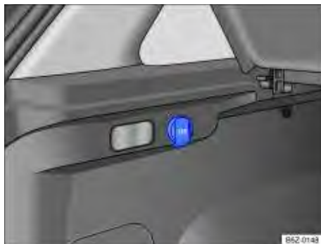
Fig. 93 No compartimento de bagagem: tomada 12 V.
