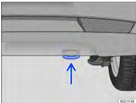
Fig. 191 No para-choque traseiro à direita: argola de reboque.
