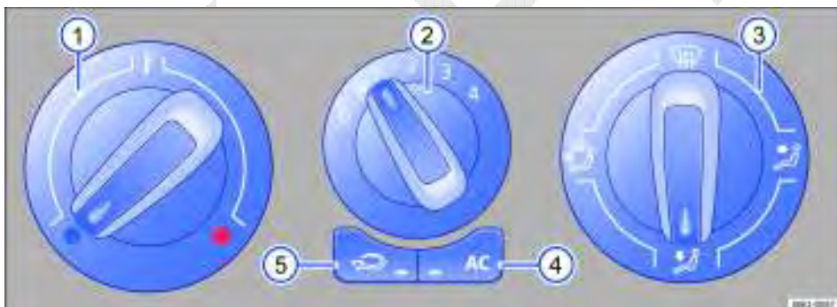
Fig. 122 No console central: comandos do ar-condicionado.
