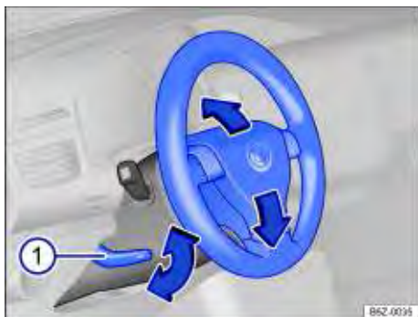
Fig. 42 Ajustar a posição do volante mecanicamente.
