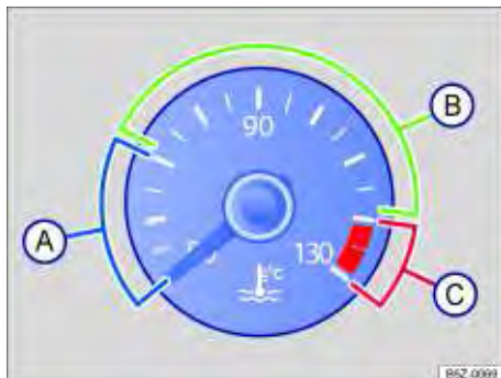
Fig. 131 Indicador de temperatura do líquido de arrefecimento do motor no instrumento combinado: (A) área fria; (B) área normal; (C) área de alerta.
