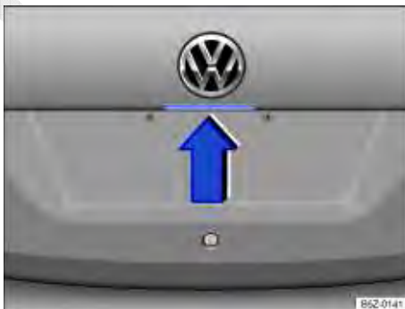
Fig. 31 No rebaixo acima da placa de licença: botão de abertura da tampa do compartimento de bagagem.
