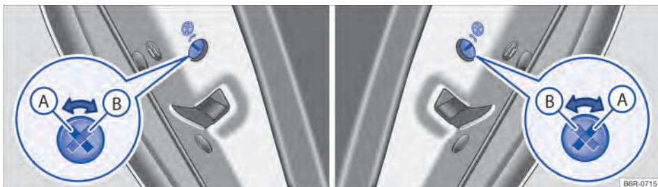
Fig. 58 Nas portas traseiras: trava de segurança para crianças (A) desacionada, (B) acionada.
