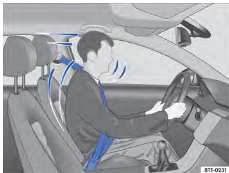
Fig. 48 Conductor protegido pelo cinto de segurança colocado corretamente em uma manobra de frenagem súbita.
