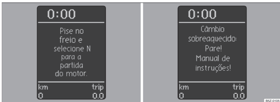
Fig. 106 Display do instrumento combinado: textos de advertência.
