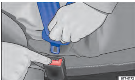
Fig. 50 Soltar a lingueta do cinto de segurança do fecho do cinto de segurança.
