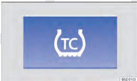
Fig. 110 No console central: botão para desligar ligar TC (controle de tração) manualmente.
