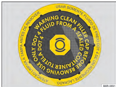
Fig. 109 No compartimento do motor: tampa do reservatório de fluido de freio (variante 1).
