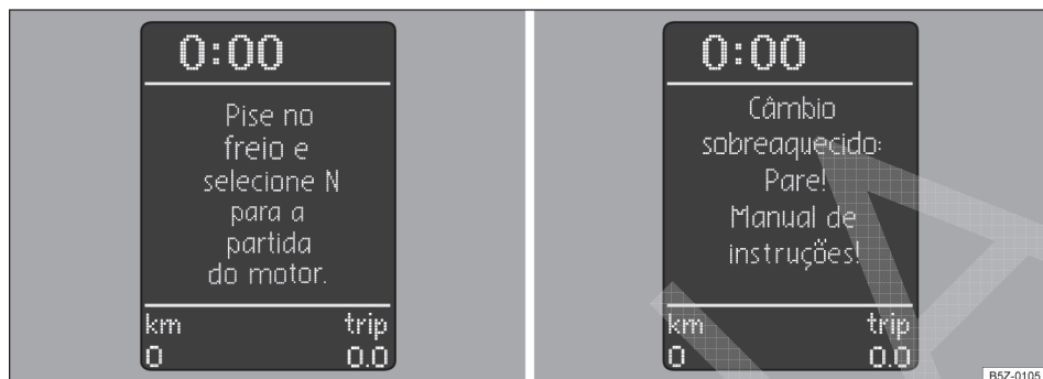
Fig. 104 Display do instrumento combinado: textos de advertência.
