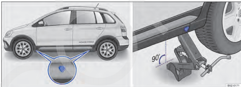
Fig. 163 Pontos de apoio do macaco e macaco posicionado no lado esquerdo traseiro do veículo.
