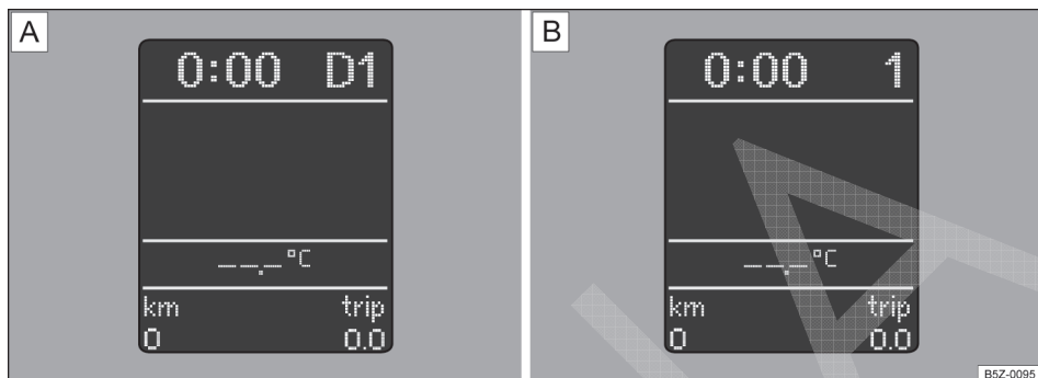
Fig. 100 (A) Posições da alavanca seletora no display: indicação da alavanca no modo de condução automatizada (Modo normal), com a 1ª marcha engatada. (B) Posições da alavanca seletora no display: modo de condução manual, com a 1ª marcha selecionada.
