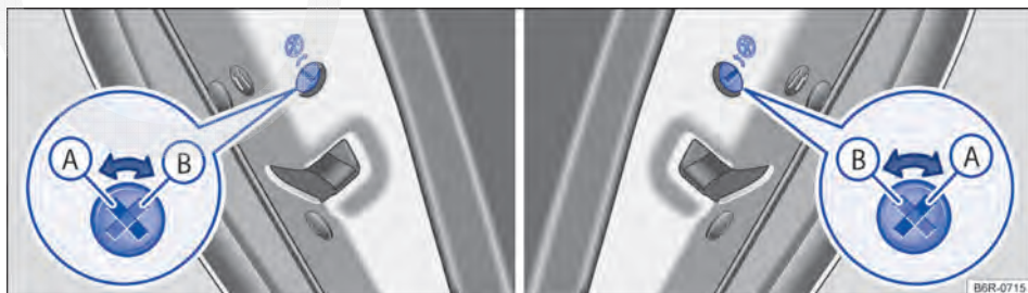
Fig. 55 Nas portas traseiras: trava de segurança para crianças (A) desacionada, (B) acionada.
