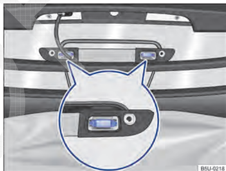
Fig. 174 Lanterna de freio elevada: remover a lâmpada incandescente da iluminação do compartimento de carga.
