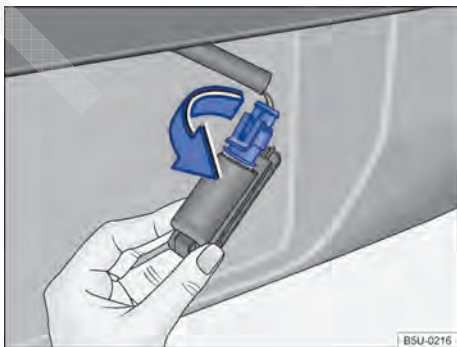
Fig. 172 Lanterna da placa de licença: remover o soquete da lâmpada.
