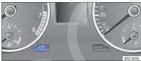
Fig. 85 No instrumento combinado: tecla de regulação da iluminação dos instrumentos e dos interruptores.
