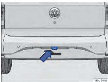
Fig. 118 No parachoque traseiro: local de instalação do assistente de condução em marcha a ré.
