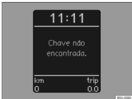
Fig. 108 No instrumento combinado: display com indicação do imobilizador ativado - veículos com Sistema de Informações Volkswagen.
