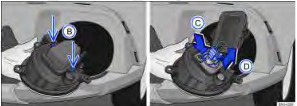
Fig. 193 Remover a cobertura para acesso da lâmpada e acesso a lâmpada do farol de neblina.
