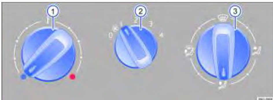
Fig. 122 No console central: comandos do aquecimento e da ventilação.
