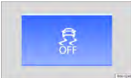
Fig. 112 No console central: botão para desligar e ligar ASR manualmente.
