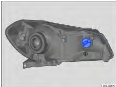
Fig. 182 No compartimento do motor: localização da lâmpada incandescente do indicador de direção dianteiro.
