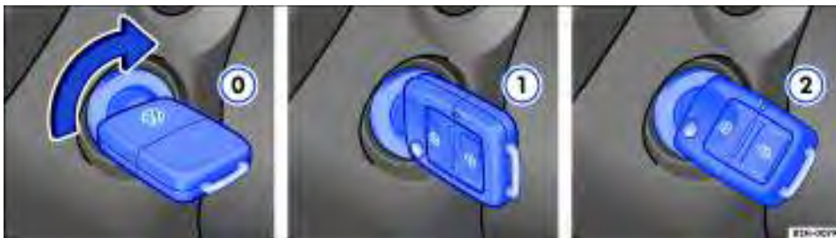
Fig. 107 Ao lado do volante, à direita: posições da chave do veículo no cilindro da ignição.
