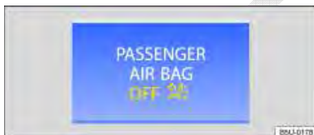
Fig. 59 Luz de controle no painel de instrumentos para o airbag frontal do passageiro desligado.
