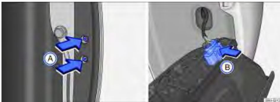
Fig. 194 Lateralmente no compartimento de carga: desaparafusar os parafusos de fixação da lanterna e retirar conector de alimentação do conjunto.
