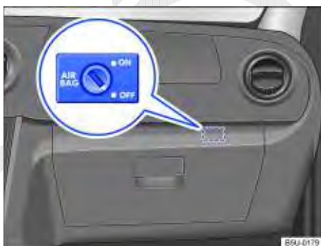
Fig. 62 No porta-luvas: interruptor desacionado pela chave para desligar e ligar o airbag frontal do passageiro.
