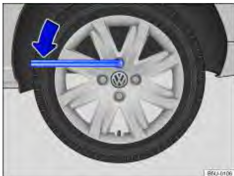
Fig. 168 Troca de roda: afrouxar os parafusos da roda.
