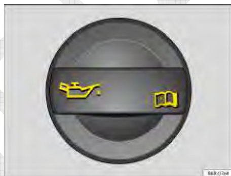
Fig. 131 No compartimento do motor: tampa da abertura de enchimento de óleo do motor.
