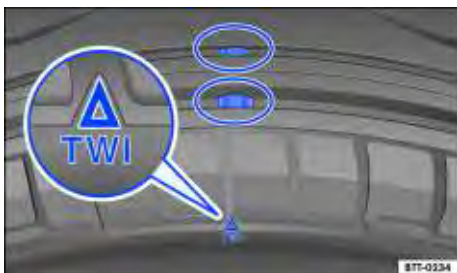
Fig. 141 Perfil do pneu: indicador de desgaste.
