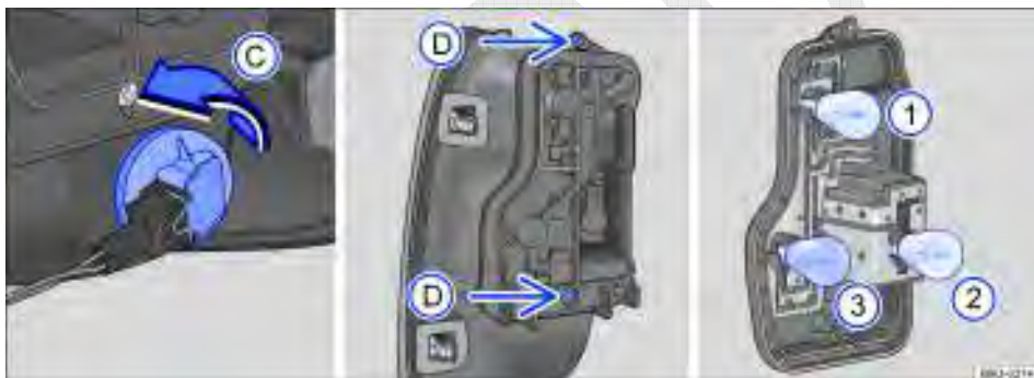
Fig. 195 Lanterna traseira desinstalada: remoção da lâmpada da lanterna de neblina, desinstalar o suporte de lâmpadas e localização das lâmpadas no suporte.
