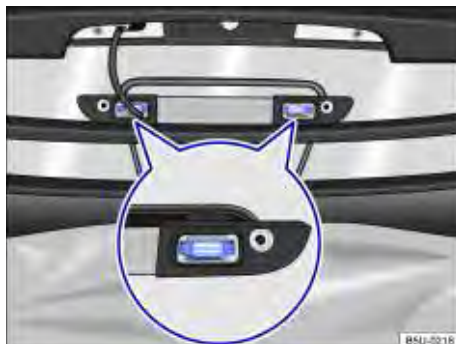
Fig. 199 Lanterna de freio elevada: remover a lâmpada incandescente da iluminação do compartimento de carga.
