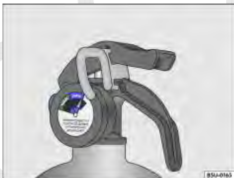
Fig. 154 No extintor de incêndio: indicador de carga (manômetro).
