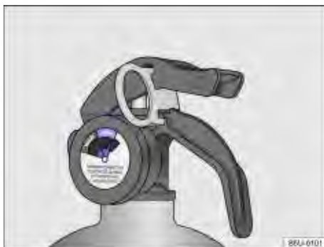
Fig. 155 No extintor de incêndio: indicador de carga (manômetro).
