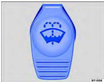
Fig. 74 No compartimento do motor: tampa do reservatório de água dos lavadores do para-brisa.
