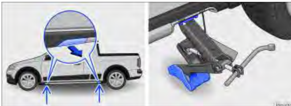
Fig. 170 Pontos de apoio do macaco e macaco posicionado no lado esquerdo traseiro do veículo - veículos com soleiras externas.
