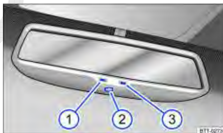
Fig. 76 No para-brisa: espelho retrovisor interno com antiofuscante automático.
