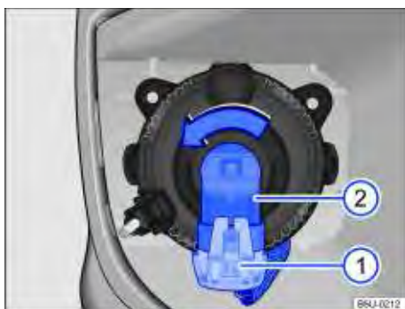
Fig. 191 Trocar a lâmpada incandescente do farol de neblina.
