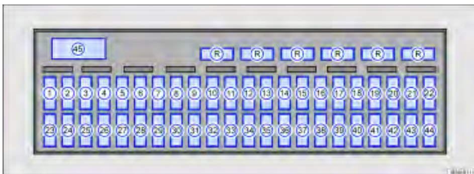
Fig. 176 Caixa de fusíveis.
