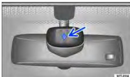
Fig. 73 No para-brisa: superfície sensível do sensor de chuva.
