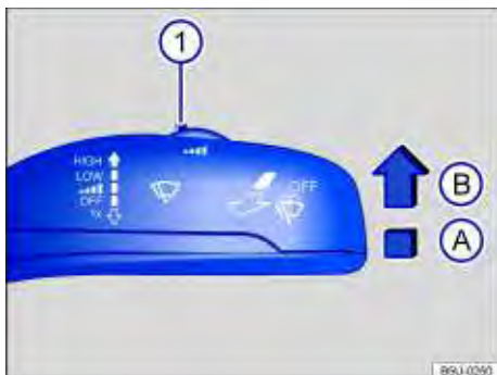
Fig. 72 Ao lado do volante: alavanca dos limpadores dos vidros: regular a sensibilidade do sensor de chuva ①.
