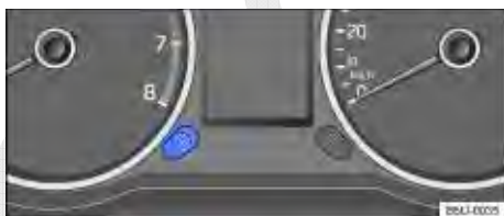
Fig. 68 No instrumento combinado: tecla de regulagem da iluminação dos instrumentos e dos interruptores.
