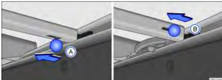
Fig. 33 Travessas no compartimento de carga: (A) veículos com suportes de amarração fixos, (B) veículos com suportes de amarração deslizantes.
