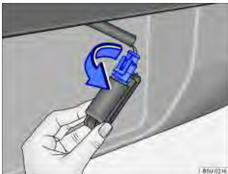
Fig. 197 Lanterna da placa de licença: remover o soquete da lâmpada.
