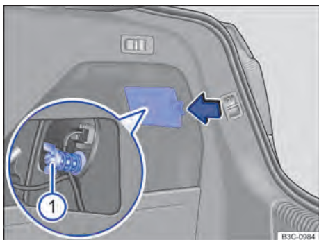
Fig. 257 Na carroceria: desinstalar a lanternas traseiras.
