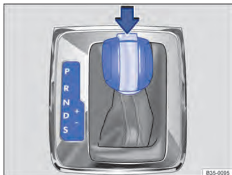
Fig. 145 Veículos com direção à esquerda: alavanca seletora da transmissão automática com botão bloqueador (seta).
