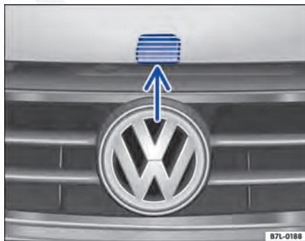
Fig. 200 Em cima da grade do radiador: alavanca de destravamento para abrir a tampa do compartimento do motor.
