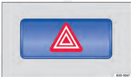
Fig. 218 Na parte superior do console central: interruptor das luzes de advertência.
