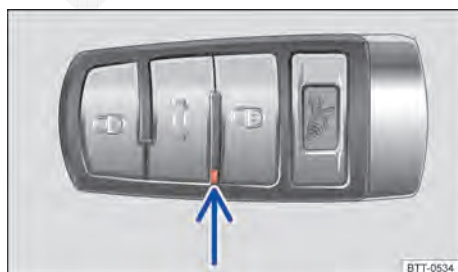
Fig. 24 Luz de controle da chave do veículo.
