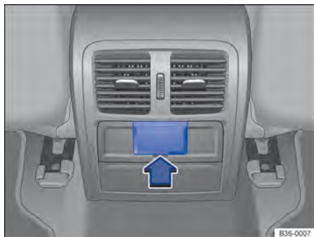
Fig. 137 Console central traseiro: abrir a cobertura dobrável.
