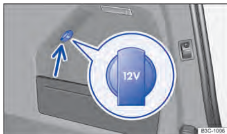
Fig. 134 No compartimento de bagagem: tomada 12 V.
