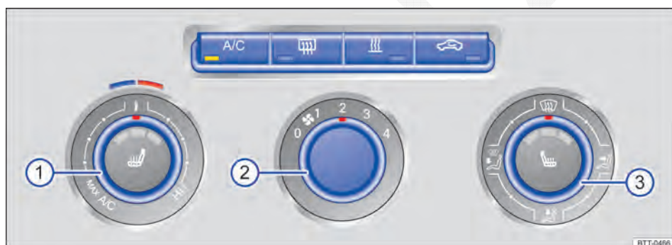
Fig. 188 No console central: comandos do ar-condicionado (manual).
