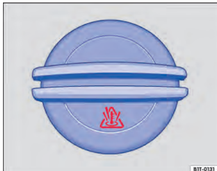
Fig. 205 No compartimento do motor: tampa do reservatório do líquido de arrefecimento do motor.
