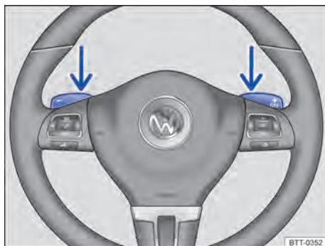
Fig. 148 Volante com 2 seletores basculantes do Tiptronic.
