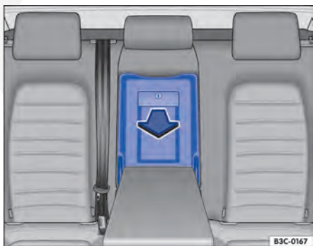
Fig. 105 No encosto do banco traseiro: abrir o dispositivo para transporte de objetos longos.
