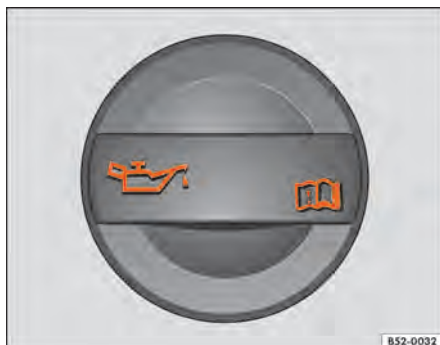
Fig. 202 No compartimento do motor: tampa da abertura de enchimento de óleo do motor.
