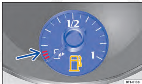
Fig. 193 No instrumento combinado: indicador do nível de combustível para gasolina e óleo diesel.
