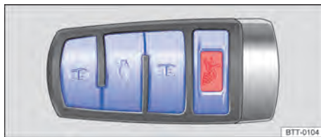
Fig. 21 Chave do veículo com botão do alarme.
