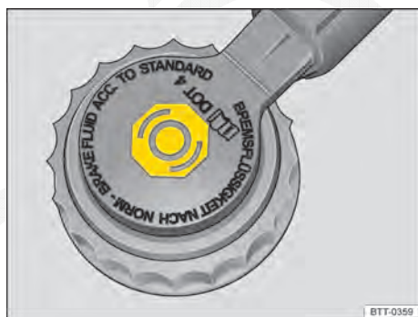
Fig. 151 No compartimento do motor: tampa do reservatório de fluido de freio.
