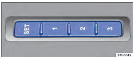
Fig. 56 Na parte externa do banco do condutor: botões da memória.
