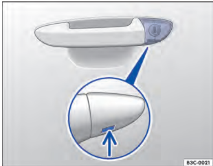
Fig. 220 Maçaneta da porta do condutor: cilindro da fechadura coberto.
