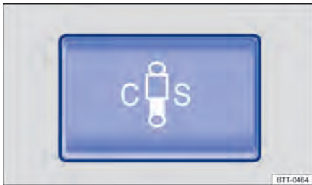
Fig. 186 No console central: botão de ajuste da regulagem dinâmica da suspensão.
