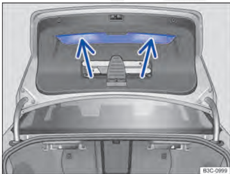
Fig. 36 Tampa do compartimento de bagagem aberta: rebaixos para puxar.
