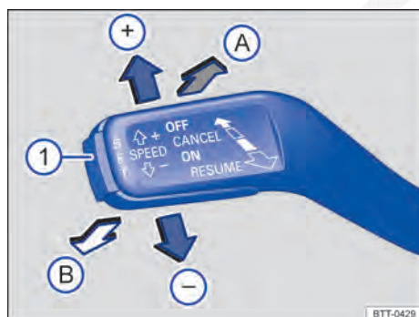
Fig. 169 À esquerda na coluna da direção: alavanca de comando do GRA.
