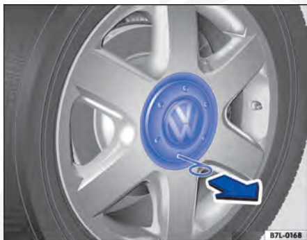
Fig. 231 Retirar a calota central.
