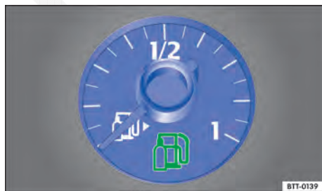
Fig. 194 No instrumento combinado: indicador do nível de combustível para gás natural.
