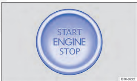
Fig. 139 Na parte inferior do console central: botão de partida do sistema de travamento e de partida Keyless Access sem chave.
