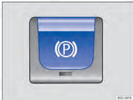
Fig. 149 Na parte inferior do console central: botão do freio de estacionamento eletrônico.
