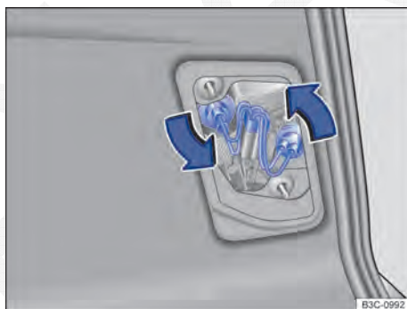
Fig. 256 Na tampa do compartimento de bagagem: desinstalar as lâmpadas incandescentes.
