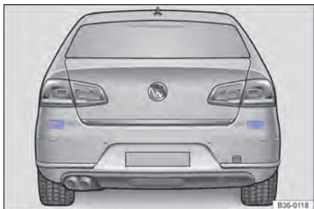
Fig. 181 Vista traseira do veículo: área dos sensores do radar.
