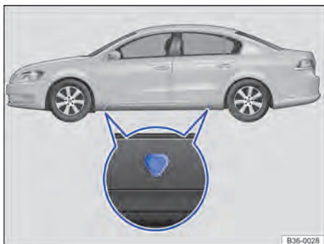
Fig. 237 Pontos de apoio do macaco.
