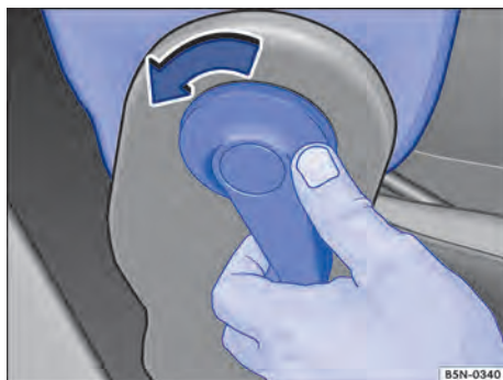
Fig. 59 Destruvar o encosto do banco do passageiro dianteiro rebatível.
