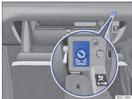
Fig. 75 No porta-luvas: interruptor acionado pela chave para desligar e ligar o airbag frontal do passageiro.
