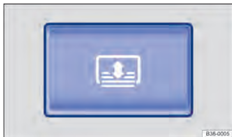
Fig. 92 No console central: interruptor da cortina de proteção solar do vidro traseiro.
