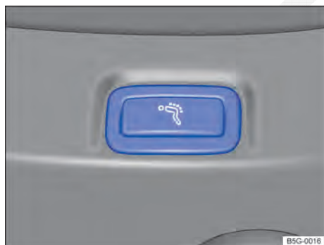
Fig. 57 Parte externa do banco dianteiro: botões da função de massagem para as costas.
