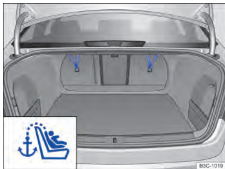
Fig. 82 Cintos de fixação superiores encaixados no compartimento de bagagem.
