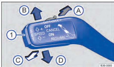
Fig. 172 Alavanca de operação ACC à esquerda na coluna de direção: regular a velocidade.
