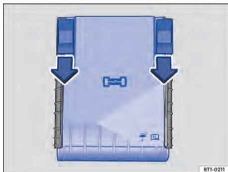
Fig. 246 No compartimento do motor: cobertura da caixa de fusíveis.
