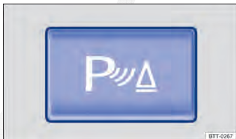
Fig. 156 Na parte inferior do console central: botão para ligar e desligar o Park Pilot.
