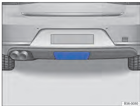
Fig. 115 Para-choque traseiro: retirar a cobertura do dispositivo de reboque.
