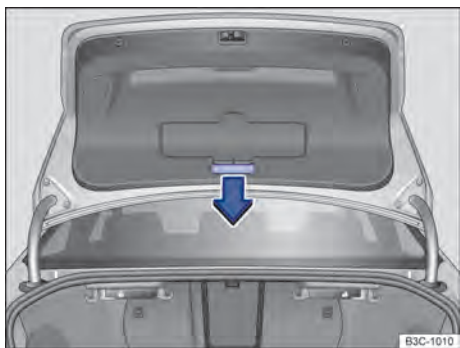
Fig. 223 A partir do compartimento de bagagem: destravar emergencialmente a tampa do compartimento de bagagem (variante 1)
