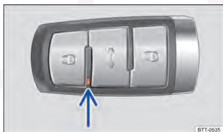
Fig. 23 Luz de controle da chave do veículo.
