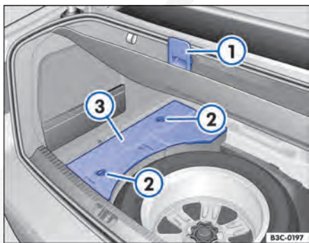
Fig. 229 No compartimento de bagagem, sob o revestimento do assoalho preso (1): roda sobressalente e cobertura (2) das ferramentas de bordo.
