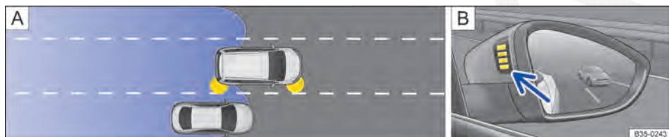
Fig. 183 Representação esquemática: A: situação de condução ao ultrapassar e mudar frequentemente de faixa. B: indicador do assistente de mudança de faixa no espelho retrovisor externo direito.
