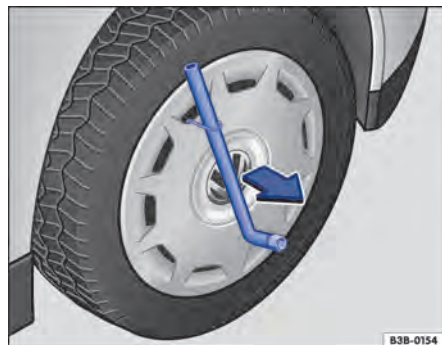
Fig. 233 Retirar a calota integral.
