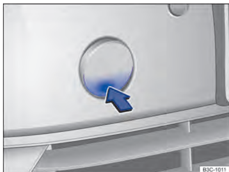
Fig. 262 No para-choque dianteiro à direita: retirar a cobertura.
