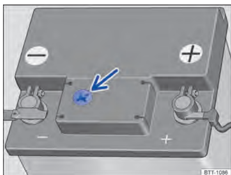
Fig. 207 Representação esquemática: visor no lado superior da bateria do veículo.
