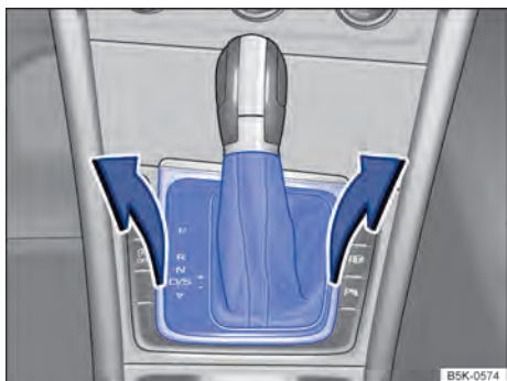
Fig. 227 Desinstalar a cobertura do quadro da alavanca seletora.
