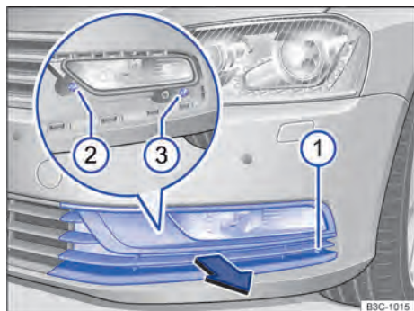
Fig. 251 No para-choque dianteiro à esquerda: lanterna para luz de neblina, farol de rotação diurna e farol de conversão.
