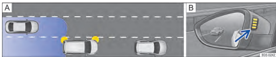
Fig. 182 Representação esquemática: A: situação de condução ao ultrapassar com o trânsito traseiro. B: indicador do assistente de mudança de faixa no espelho retrovisor externo esquerdo.
