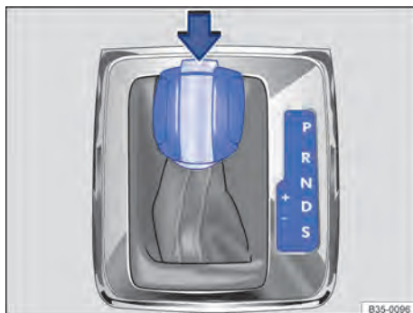
Fig. 146 Veículos com direção à direita: alavanca seletora da transmissão automática com botão bloqueador (seta).
