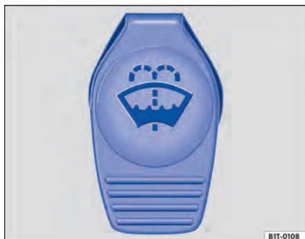
Fig. 99 No compartimento do motor: tampa do reservatório de água dos lavadores dos vidros.
