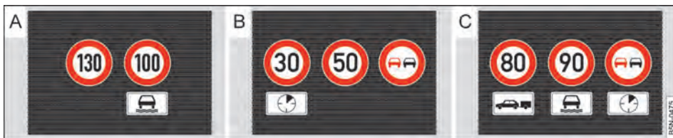
Fig. 184 No display do instrumento combinado: exemplos de limites de velocidade e proibição de ultrapassagem com placas adicionais associadas.
