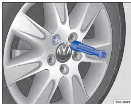
Fig. 243 Troca de roda: desaparafusar os parafusos de roda com o punho da chave de fenda.
