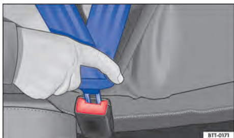
Fig. 29 Introduzir a lingueta do cinto de segurança no fecho do cinto de segurança.
