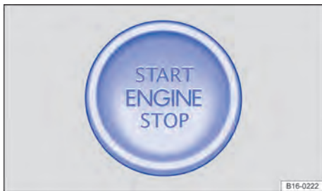
Fig. 88 Na parte inferior do console central: botão de partida para ligar o motor.
