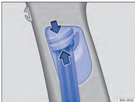
Fig. 33 Ao lado dos bancos dianteiros: regulagem de altura do cinto de segurança.
