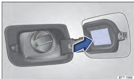
Fig. 195 Na parte interna da portinhola do tanque de combustível: etiqueta com a pressão dos pneus.
