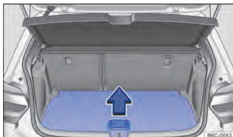
Fig. 151 No compartimento de bagagem: levantar o assoalho do compartimento de bagagem.
