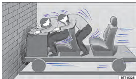
Fig. 25 Um veículo com os ocupantes sem cintos de segurança colide com o muro.
