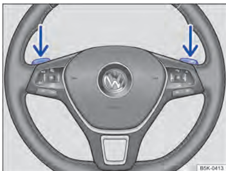
Fig. 93 Volante com seletores basculantes do Tiptronic.
