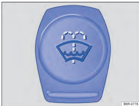
Fig. 185 No compartimento do motor: tampa do reservatório de água dos lavadores dos vidros.
