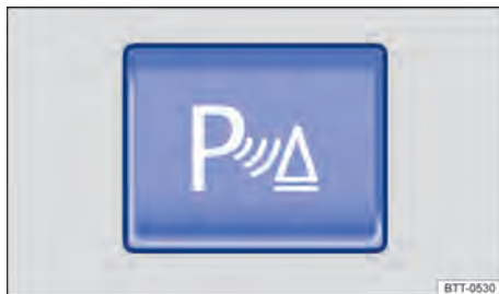
Fig. 97 No console central: botão para ligar e desligar o auxílio de estacionamento.
