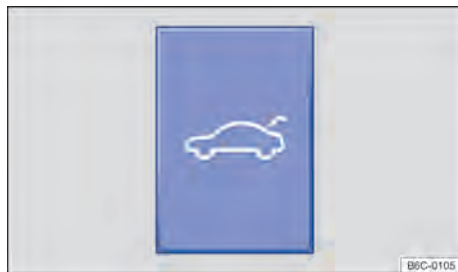
Fig. 59 No console central: botão de destravamento da tampa traseira.
