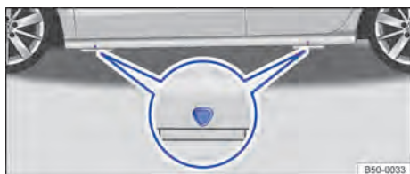
Fig. 201 Pontos de apoio do macaco.
