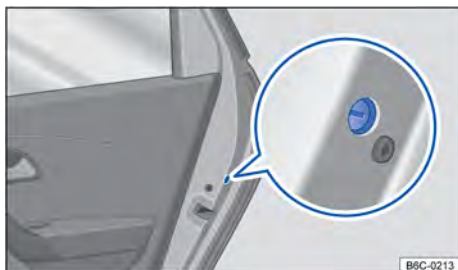
Fig. 56 Na porta traseira: travamento de emergência.
