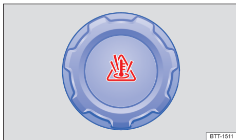
Fig. 152 No compartimento do motor: tampa do reservatório de expansão do líquido de arrefecimento do motor.
