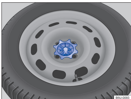
Fig. 160 No compartimento de bagagem: manípulo para fixação da roda de emergência.
