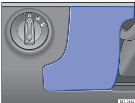
Fig. 137 No lado do condutor do painel de instrumentos: cobertura da caixa de fusíveis.
