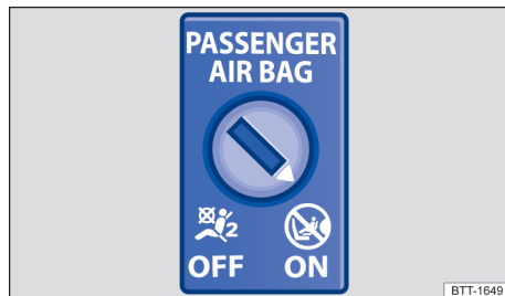
Fig. 40 No painel de instrumentos no lado do passageiro dianteiro: interruptor acionado pela chave para desligar e ligar o airbag frontal do passageiro dianteiro.
