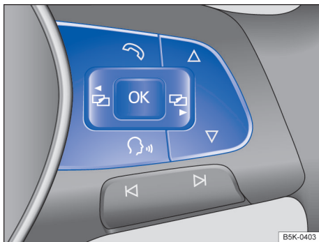
Fig. 23 Lado direito do volante multifunções: botões para comando dos menus e exibições de informação do instrumento combinado.
