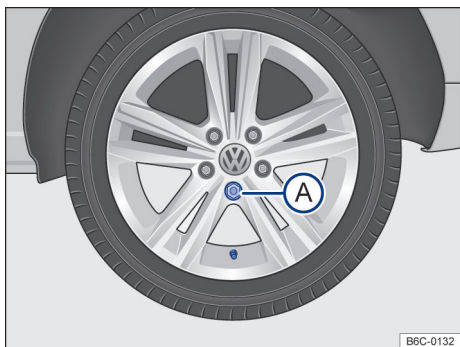
Fig. 162 Retirar a calota integral.
