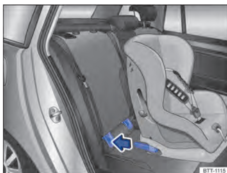
Fig. 6 Representação esquemática: instalar a cadeira de criança ISOFIX com os braços de apoio.
