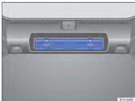
Fig. 10 No compartimento de bagagem: suporte para o triângulo de segurança.
