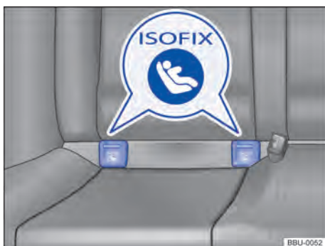
Fig. 5 No banco traseiro do veículo: identificação dos pontos de ancoragem inferiores para cadeiras de criança.
