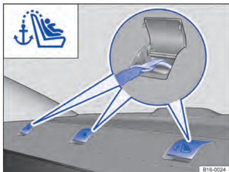
Fig. 7 Na superfície atrás do banco traseiro: olhais de retenção para o cinto de fixação superior.
