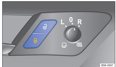
Fig. 58 Na porta do condutor: botão do travamento central.
