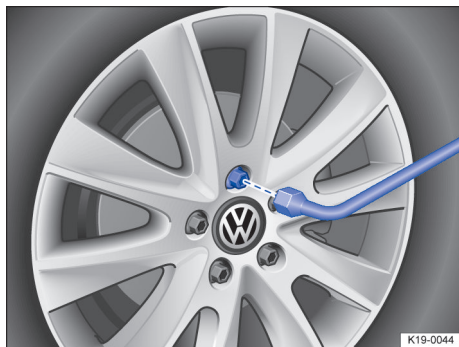
Fig. 210 Troca de roda: desaparafusar os parafusos de roda com a chave de roda.
