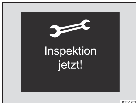
Fig. 21 No display do instrumento combinado: exemplo de indicação para um evento de serviço próximo de vencer (representação esquemática).
