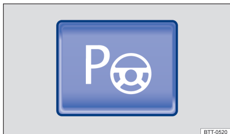
Fig. 130 No console central: botão para ligar o assistente de direção para estacionamento.
