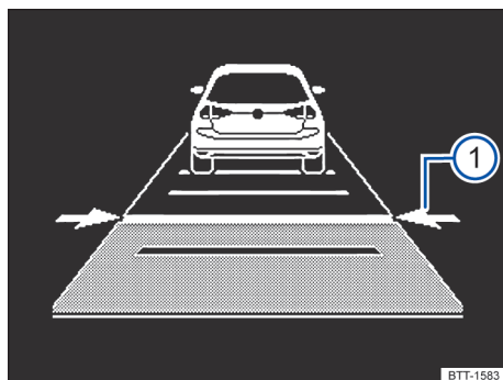
Fig. 121 No display do instrumento combinado: distância regulada ① (representação esquemática, ACC regula).
