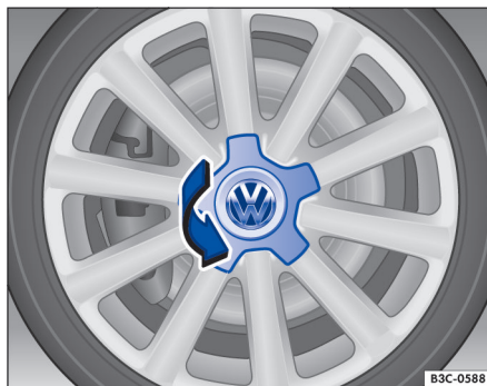
Fig. 203 Virar a calota central.
