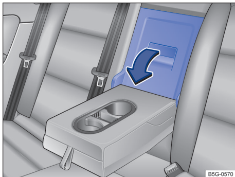
Fig. 149 No encosto do banco traseiro: abrir o dispositivo para transporte de objetos longos.
