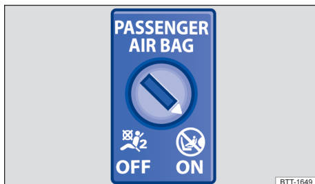
Fig. 39 No painel de instrumentos no lado do passageiro dianteiro: interruptor acionado pela chave para desligar e ligar o airbag do passageiro dianteiro.
