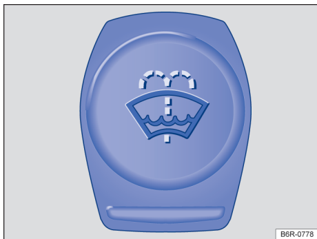
Fig. 190 No compartimento do motor: tampa do reservatório de água dos lavadores do para-brisa.
