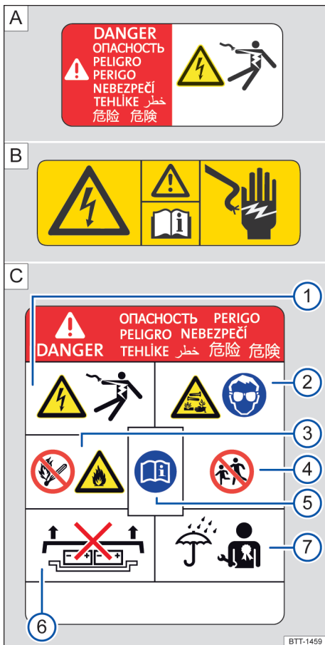
Fig. 157 Placas de advertência (representações esquemáticas): A ) componente de alta tensão, B ) placa de advertência geral para alta tensão, C ) placa de advertência sobre a bateria de alta tensão.
