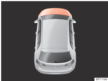
Fig. 189 No display do instrumento combinado: tampa do compartimento do motor aberta ou fechada incorretamente (representação esquemática).
