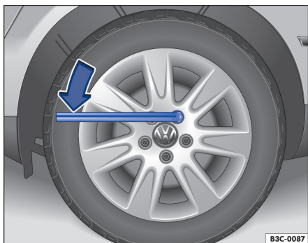
Fig. 206 Troca de roda: afrouxar os parafusos de roda.
