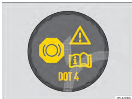
Fig. 105 No compartimento do motor: tampa do reservatório de fluido de freio.
