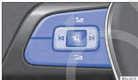
Fig. 15 Lado esquerdo do volante multifunções: teclas de comando.
