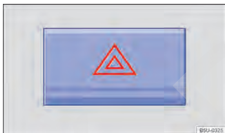
Fig. 154 Na parte superior do console central: interruptor das luzes de advertência.
