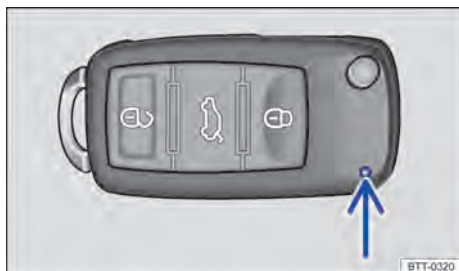
Fig. 20 Luz de controle da chave do veículo com comando remoto.
