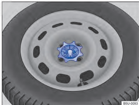
Fig. 135 No compartimento de bagagem: manípulo para fixação da roda de emergência. ▶
