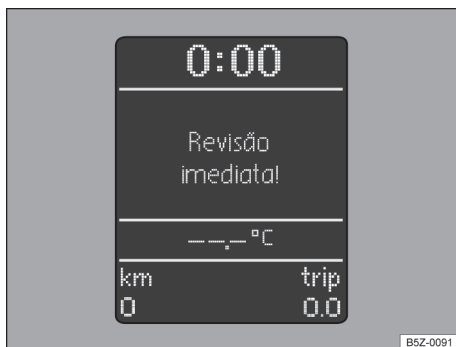
Fig. 11 Display do instrumento combinado: indicação do intervalo de serviço.
