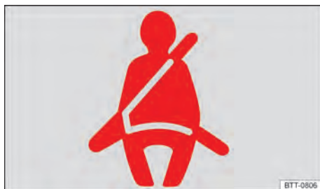
Fig. 41 Luz de advertência no display do instrumento combinado.
