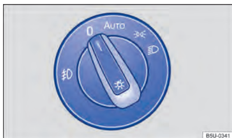
Fig. 59 No painel: interruptor das luzes. ▶
