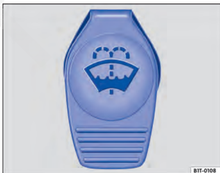
Fig. 67 No compartimento do motor: tampa do reservatório de água dos lavadores dos vidros.
