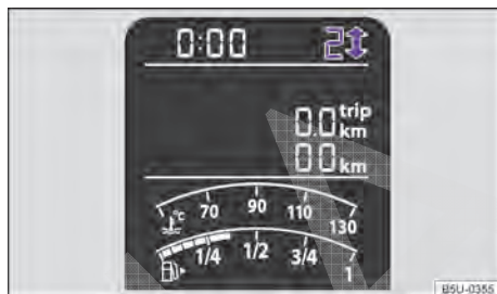
Fig. 96 No instrumento combinado: indicador de troca de marcha (variante 1).
