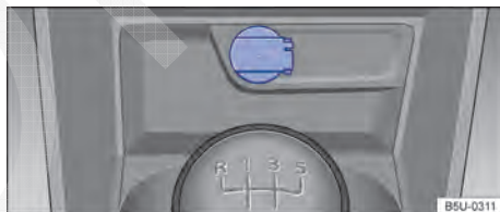
Fig. 90 No console central dianteiro: tomada 12 V.
