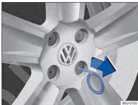
Fig. 137 Retirar as capas de cobertura dos parafusos da roda.
