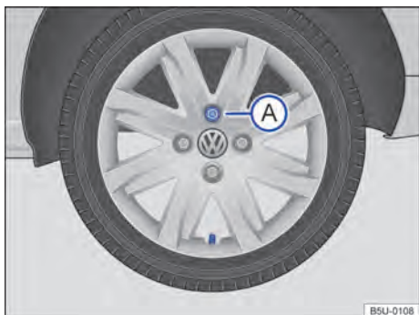
Fig. 138 Retirar a supercalota.
