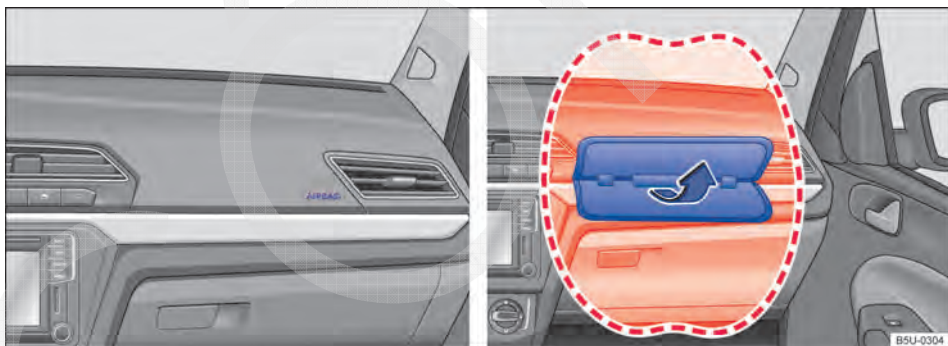
Fig. 54 Local de instalação e área de expansão do airbag frontal do passageiro dianteiro.
