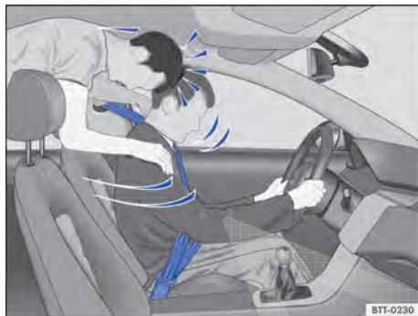
Fig. 45 O passageiro sem cinto de segurança no banco traseiro é lançado para frente sobre o condutor com cinto de segurança.
