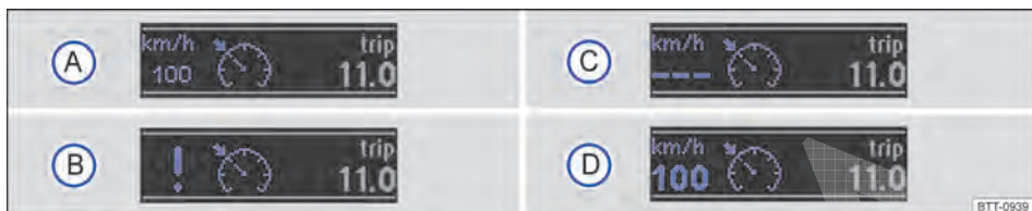
Fig. 112 No display do instrumento combinado: indicadores de status do GRA.
