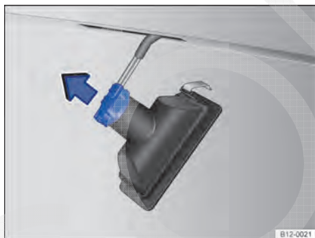
Fig. 177 Lanterna da placa de licença: remover o soquete da lâmpada.
