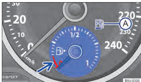
Fig. 14 No instrumento combinado: indicador do nível de combustível (variante 2).
