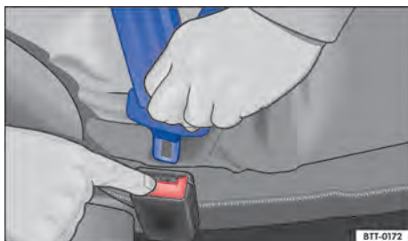
Fig. 29 Soltar a lingueta do cinto de segurança do fecho do cinto de segurança.
