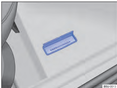
Fig. 216 Em frente ao banco do passageiro dianteiro: número de identificação do veículo (número do chassi) no assoalho, em frente ao banco do passageiro dianteiro.
