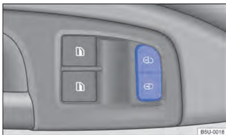
Fig. 47 Na porta do condutor: botão do travamento central.
