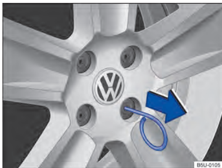
Fig. 208 Retirar as capas de cobertura dos parafusos da roda.
