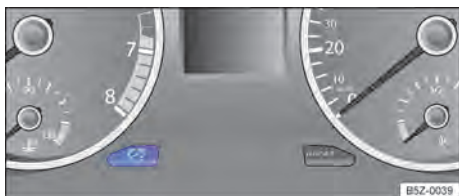
Fig. 65 No instrumento combinado: tecla de regulação da iluminação dos instrumentos e dos interruptores.
