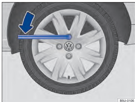
Fig. 210 Troca de roda: soltar os parafusos da roda.
