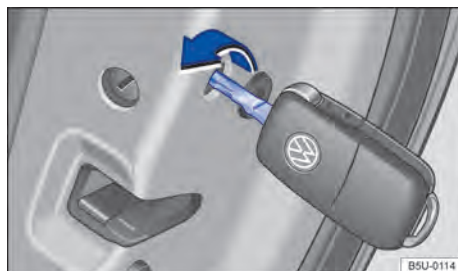
Fig. 50 Travamento de emergência do veículo com a chave do veículo.
