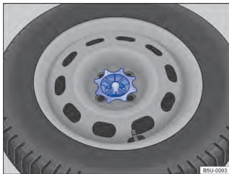
Fig. 206 No compartimento de bagagem: manípulo para fixação da roda de emergência.
