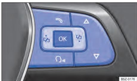
Fig. 19 Lado direito do volante multifunções: teclas de comando dos menus do instrumento combinado.
