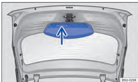
Fig. 52 Tampa traseira aberta: puxador para fechamento.
