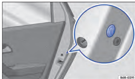
Fig. 49 Na porta traseira: travamento de emergência, coberto por uma vedação de borracha.
