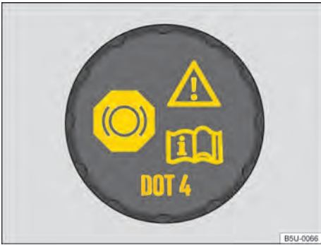
Fig. 199 No compartimento do motor: tampa do reservatório de fluido de freio.
