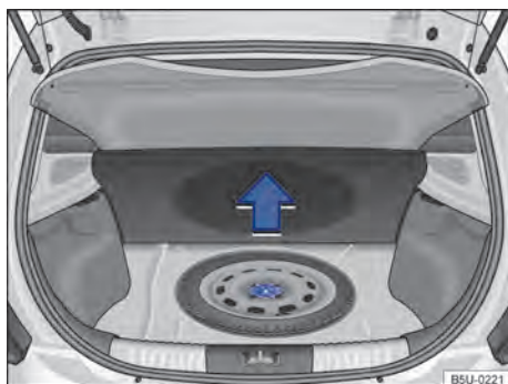
Fig. 170 No compartimento de bagagem, sob o revestimento de assoalho: roda de emergência e ferramentas de bordo.
