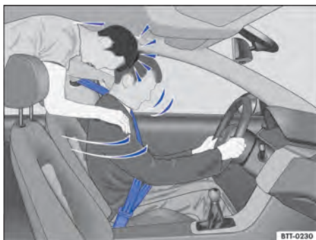
Fig. 26 O passageiro sem cinto de segurança no banco traseiro é lançado para frente sobre o condutor com cinto de segurança.
