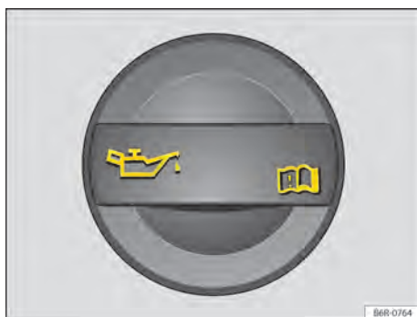
Fig. 196 No compartimento do motor: tampa da abertura para enchimento de óleo do motor.
