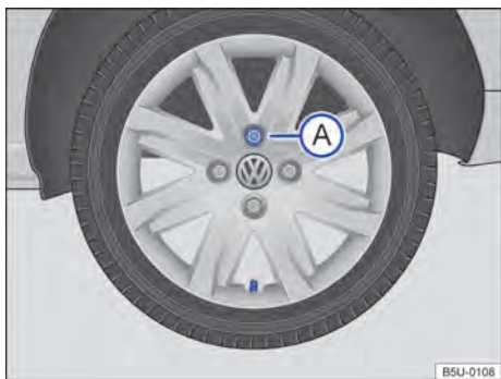
Fig. 212 Troca de roda: sequência de remoção dos parafusos da roda.
