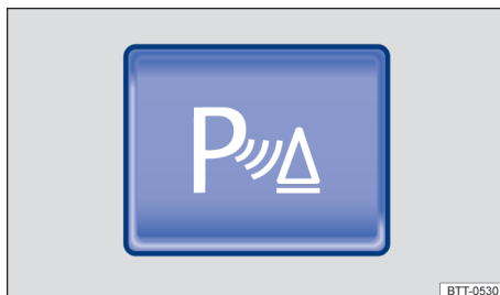
Fig. 90 Na parte superior do console central: botão para ligar e desligar o controle de distância de estacionamento (Park Pilot).
