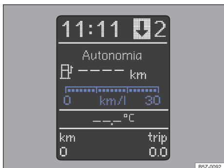
Fig. 16 No instrumento combinado: indicador de consumo de combustível.
