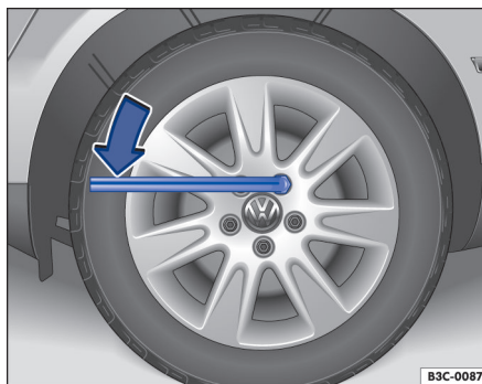
Fig. 161 Troca de roda: soltar os parafusos da roda.
