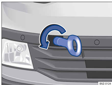
Fig. 139 No para-choque dianteiro à direita: rosquear a argola de reboque.
