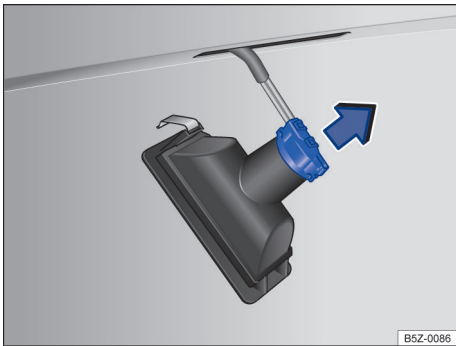
Fig. 127 Lanterna da placa de licença: remover o soquete da lâmpada.
