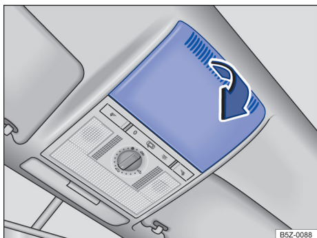
Fig. 56 No revestimento do teto: remover a cobertura.
