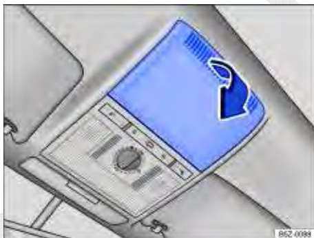
Fig. 157 No revestimento do teto: remover a cobertura.
