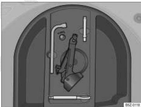
Fig. 160 No compartimento de bagagem: caixa de ferramentas de bordo.
