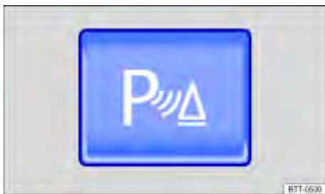
Fig. 112 Na parte superior do console central: botão para ligar e desligar o controle de distância de estacionamento (Park Pilot).
