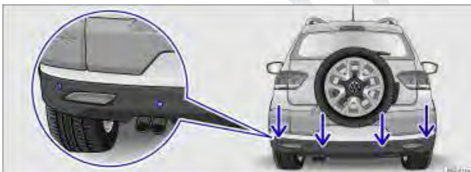
Fig. 115 Sensores de ultrassom do controle de distância de estacionamento no para-choque traseiro.
