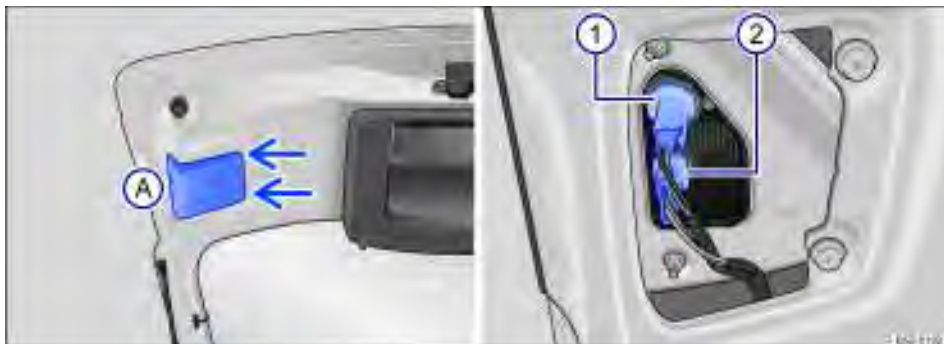
Fig. 180 Lanterna traseira: (A) desinstalar a cobertura e (1) e (2) desinstalar as lâmpadas.
