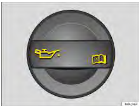
Fig. 129 No compartimento do motor: tampa da abertura para enchimento de óleo do motor.
