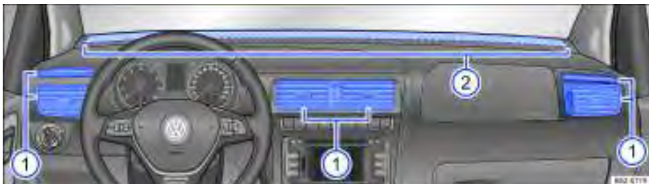
Fig. 122 No painel de instrumentos: difusores de ar.
