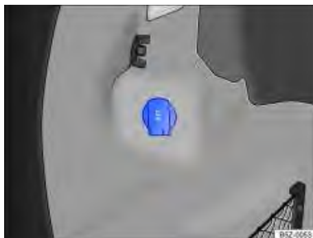
Fig. 92 No compartimento de bagagem: tomada 12 V.
