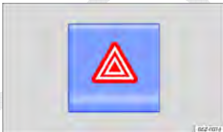
Fig. 148 Na parte superior do console central: interruptor para ligar e desligar as luzes de advertência.
