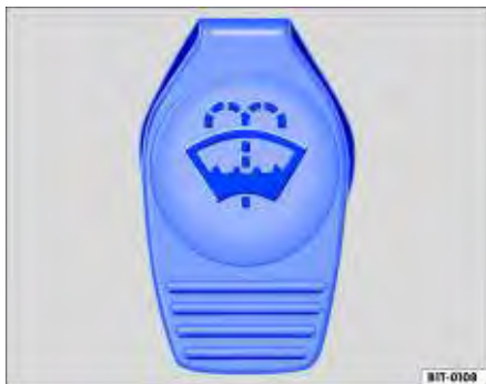
Fig. 69 No compartimento do motor: tampa do reservatório de água dos lavadores dos vidros.
