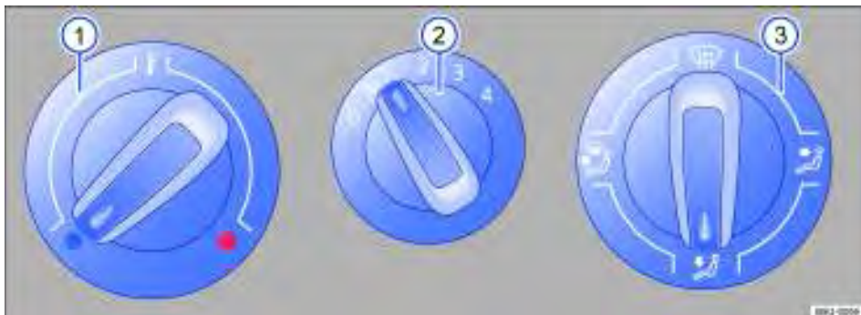
Fig. 120 No console central: comandos do sistema de ventilação e aquecimento.
