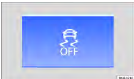
Fig. 107 No console central: botão para desligar e ligar ASR manualmente.
