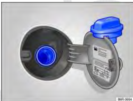
Fig. 125 Portinhola do tanque de combustível aberta com a tampa do tanque de combustível pendurada.
