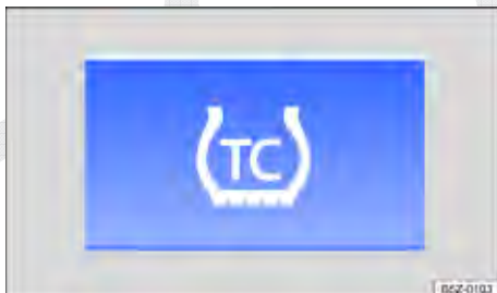
Fig. 108 No console central: botão para desligar e ligar TC (controle de tração) manualmente.
