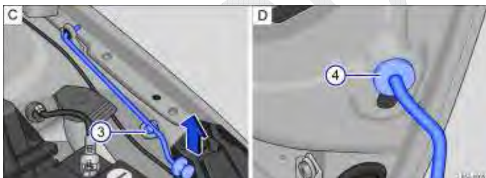
Fig. 127 C: haste de sustentação da tampa do compartimento do motor (3). D: tampa do motor protegida com a haste de sustentação da tampa (4).
