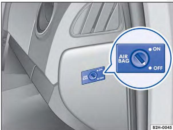
**Fig. 60** Na parte frontal no lado do passageiro dianteiro: interruptor acionado pela chave para desativar e ativar o airbag frontal do passageiro dianteiro.
