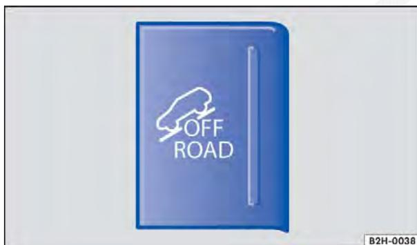
Fig. 113 No console central: botão para ligar e desligar a função off-road manualmente.
