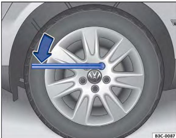
**Fig. 169** Troca de roda: soltar os parafusos de roda.
