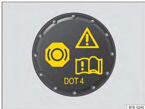
**Fig. 110** No compartimento do motor: tampa do reservatório do fluido de freio.
