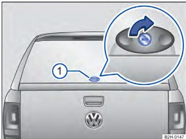
**Fig. 29** Abrir a capota rígida do compartimento de carga.
