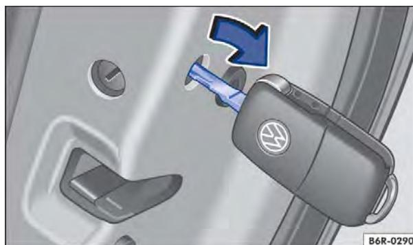
**Fig. 160** Travamento de emergência do veículo com a chave do veículo.
