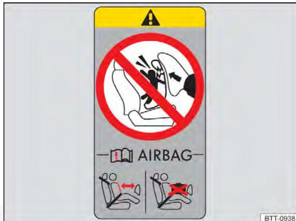
Fig. 66 Na coluna B do lado do passageiro dianteiro: etiqueta adesiva do airbag.
