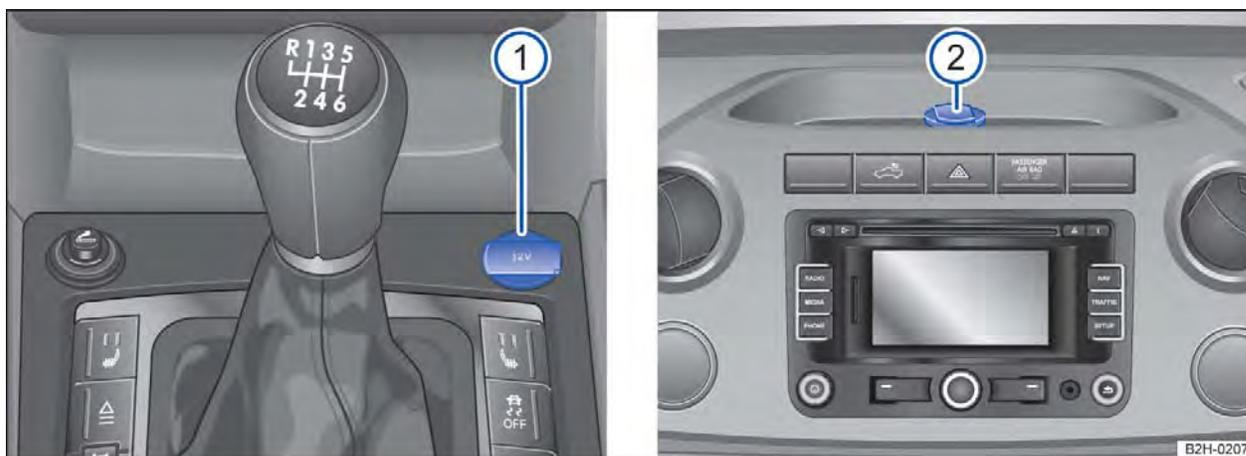
**Fig. 99** Direção à esquerda: no console central dianteiro ① (em veículos com direção à direita é espelhado) e no porta-objetos no painel de instrumentos ②: tomada 12 V.
