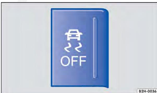
**Fig. 109** No console central: botão para desligar e ligar o ESC manualmente.
