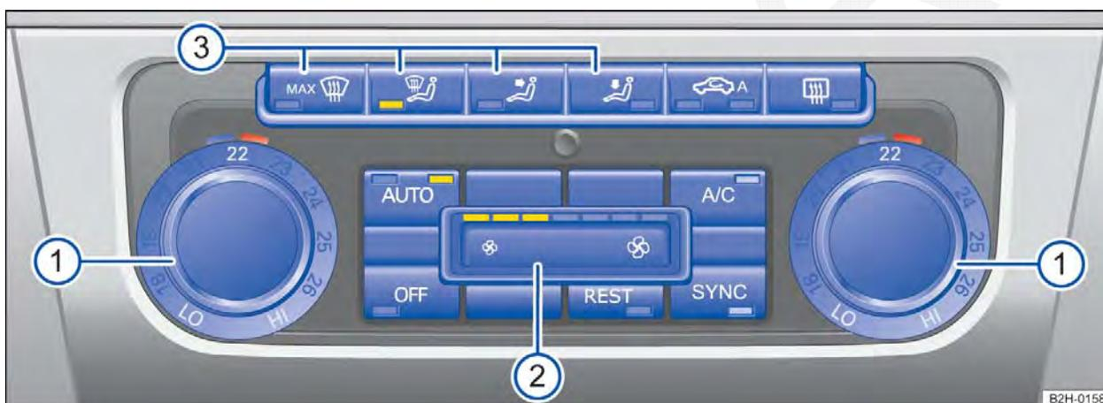
Fig. 125 No painel de instrumentos: comandos do Climatronic.
