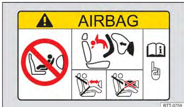
Fig. 65 No para-sol do lado do passageiro dianteiro: etiqueta adesiva do airbag.
