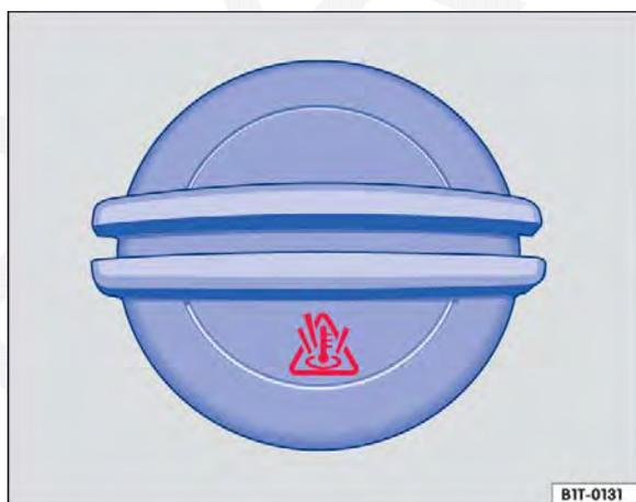
**Fig. 141** No compartimento do motor: tampa do reservatório de expansão do líquido de arrefecimento do motor.
