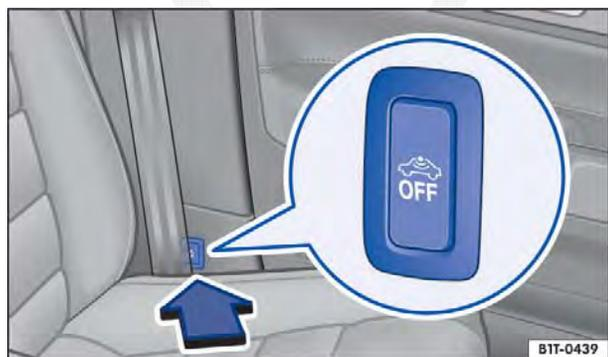
**Fig. 22** Ao lado do banco do condutor: botão para desligar o monitoramento do interior do veículo e o alarme antirrebocagem.
