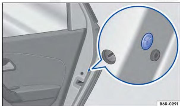
**Fig. 159** Na parte dianteira da porta traseira direita: travamento de emergência, coberto por uma vedação de borracha.
