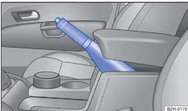
**Fig. 107** Entre os bancos dianteiros: freio de estacionamento.
