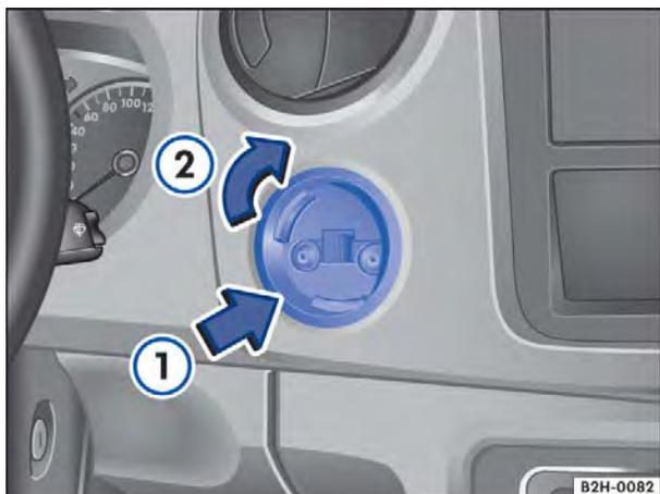
**Fig. 93** Posicionar o acessório no ponto de multifixação.
