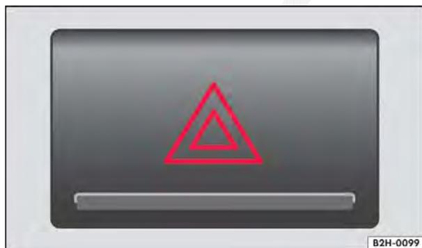
**Fig. 155** No centro do painel de instrumentos: botão para ligar e desligar as luzes de advertência.
