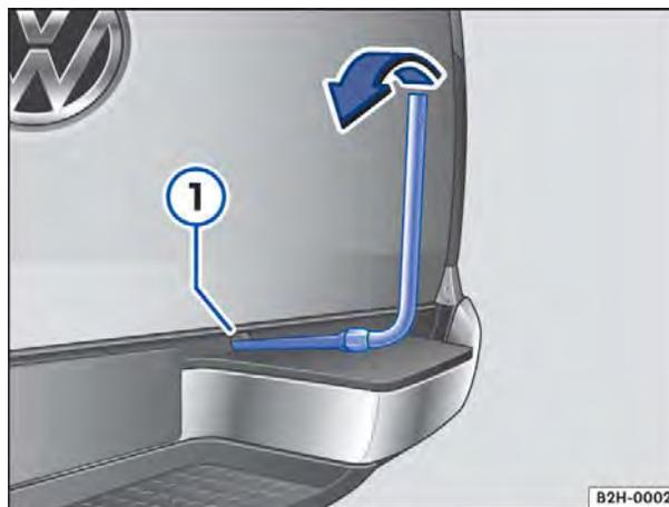
Fig. 165 Girar a roda sobressalente para baixo pelo guincho.
