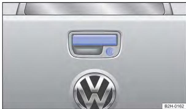
**Fig. 25** Abrir a tampa do compartimento de carga por fora.
