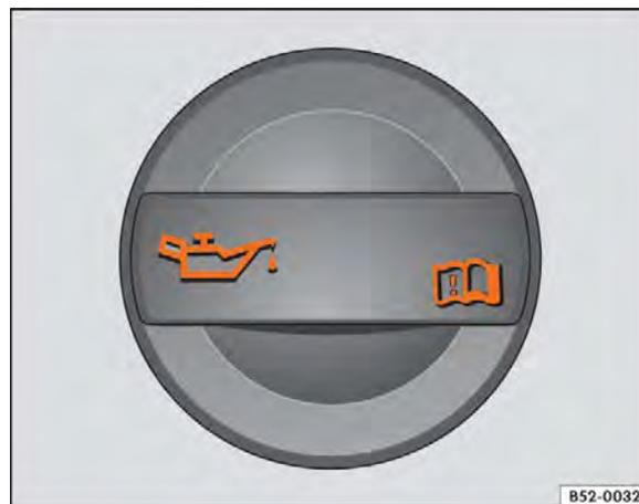
**Fig. 137** No compartimento do motor: tampa da abertura para enchimento de óleo do motor.
