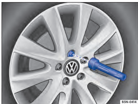
Fig. 241 Troca de roda: desaparafusar os parafusos de roda com o punho da chave de fenda.
