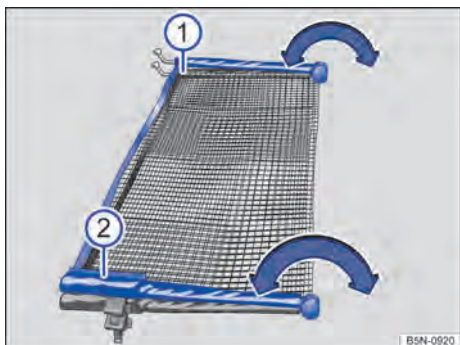
Fig. 180 Rebater a rede divisória para fora e para dentro.
