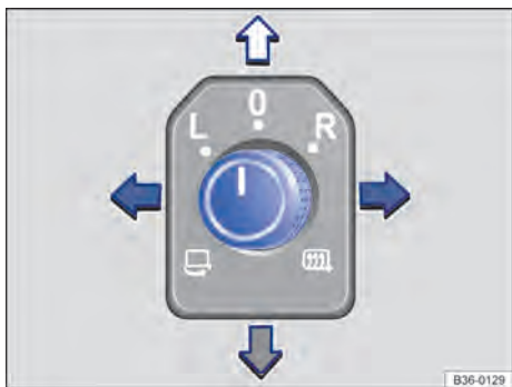
Fig. 108 Na porta do condutor: botão rotativo dos espelhos retrovisores externos.
