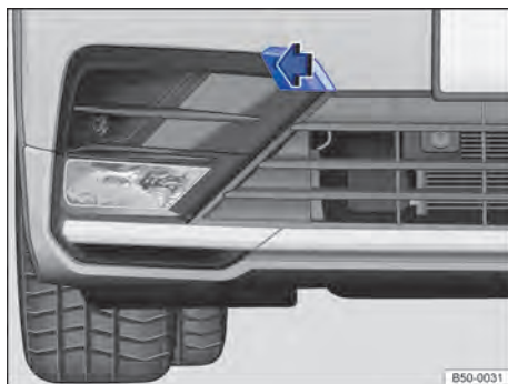
Fig. 214 No para-choque dianteiro à direita: capa de cobertura para o alojamento da argola de reboque.
