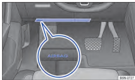
Fig. 49 No lado do condutor: local de instalação do airbag para joelhos.
