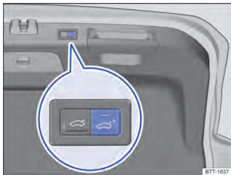
Fig. 72 Na tampa do compartimento de bagagem aberta: botão para fechar eletricamente a tampa do compartimento de bagagem.
