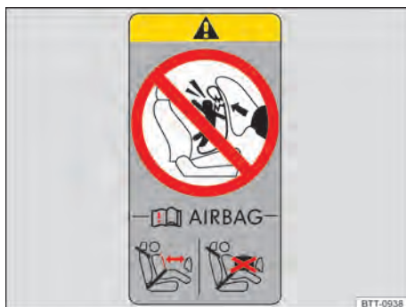
Fig. 53 Representação esquemática: etiqueta de airbag na coluna B.
