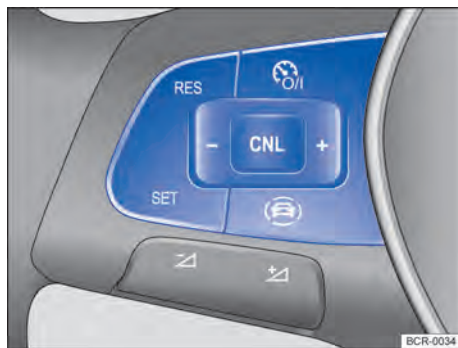
Fig. 136 Lado esquerdo do volante multifunções: botões para comandar o GRA.
