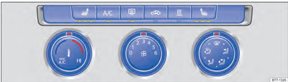
Fig. 111 Na parte superior do console central: comandos do ar-condicionado manual.
