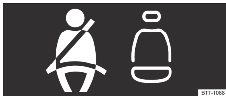
Fig. 30 No display do instrumento combinado: indicador de status do cinto de segurança para os assentos traseiros.
