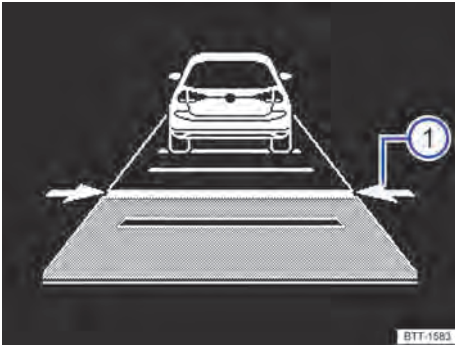
Fig. 143 No display do instrumento combinado: distância configurada ① (representação esquemática, ACC regulando).
