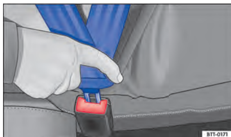
Fig. 36 Introduzir a lingueta do cinto de segurança no fecho do cinto de segurança.
