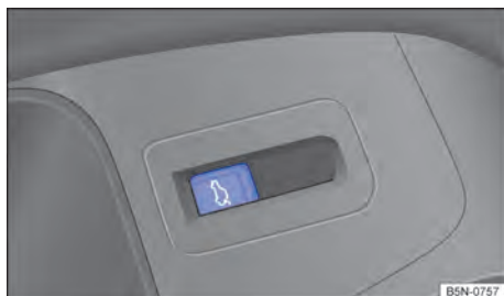
Fig. 68 Na porta do condutor: botão de destravamento da tampa do compartimento de bagagem (dependendo da versão).
