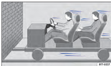
Fig. 31 Um veículo com os ocupantes do veículo sem cintos de segurança está em rota de colisão com um muro.
