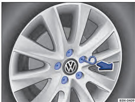
Fig. 236 Remover as capas de cobertura dos parafusos de roda.
