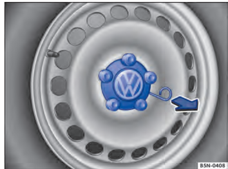
Fig. 234 Retirar a calota central.
