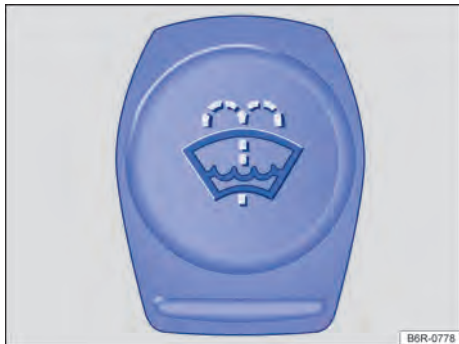
Fig. 219 No compartimento do motor: tampa do reservatório de água dos lavadores dos vidros.
