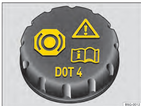
Fig. 224 No compartimento do motor: tampa do reservatório do fluido de freio.
