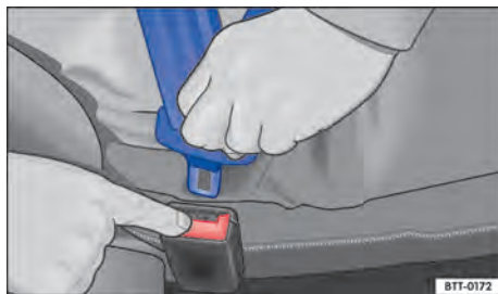
Fig. 37 Soltar a lingueta do cinto de segurança do fecho do cinto de segurança.
