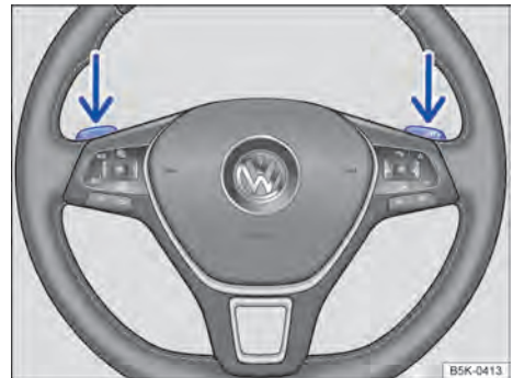
Fig. 125 Volante com seletores basculantes do Tiptronic.
