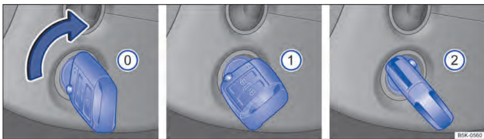
Fig. 118 Ao lado do volante, à direita: posições da chave do veículo no cilindro da ignição.
