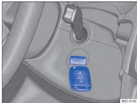
Fig. 120 À direita na coluna de direção: função de partida de emergência em veículos com sistema de travamento e de partida Keyless Access sem chave.
