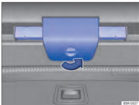
Fig. 57 Na tampa do compartimento de bagagem: suporte para o triângulo de segurança.
