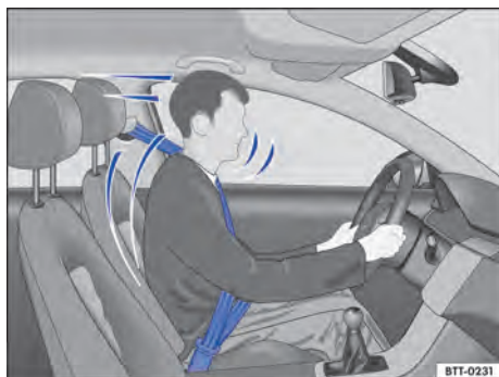
Fig. 35 Condutor protegido pelo cinto de segurança colocado corretamente numa manobra de frenagem súbita.
