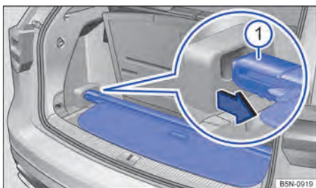
Fig. 177 Embaixo do assoalho do compartimento de bagagem: local de guarda para a cobertura do compartimento de bagagem.
