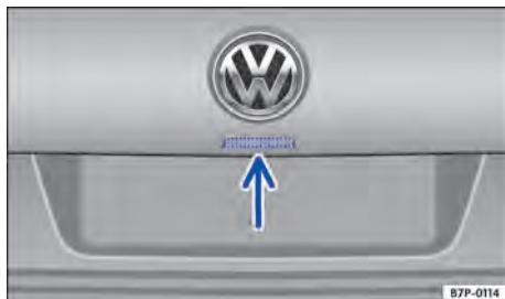
Fig. 69 Na tampa do compartimento de bagagem: botão para abrir a tampa do compartimento de bagagem.
