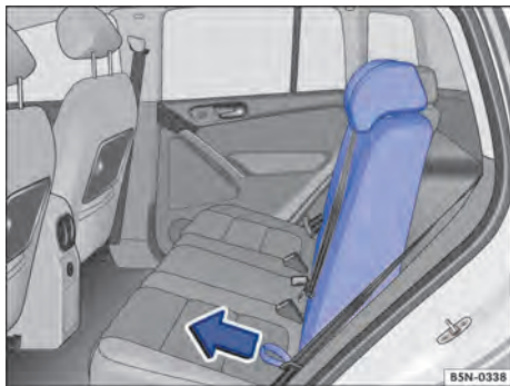
Fig. 84 Rebater o encosto do banco traseiro para frente e de volta.
