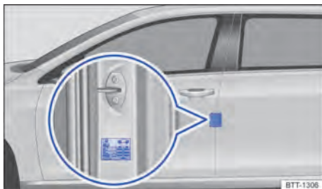
Fig. 230 Na coluna da porta do condutor: etiqueta de pressão dos pneus (alternativamente no lado interno da portinhola do tanque).
