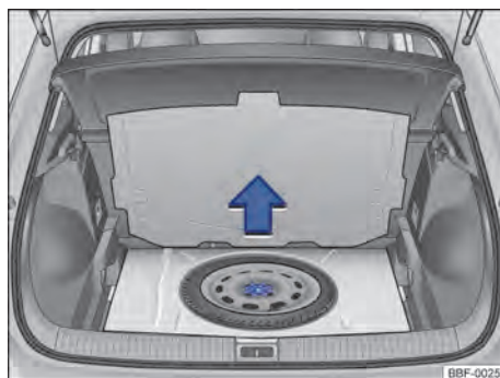
Fig. 174 No compartimento de bagagem, sob o revestimento de assoalho: roda de emergência e ferramentas de bordo.
