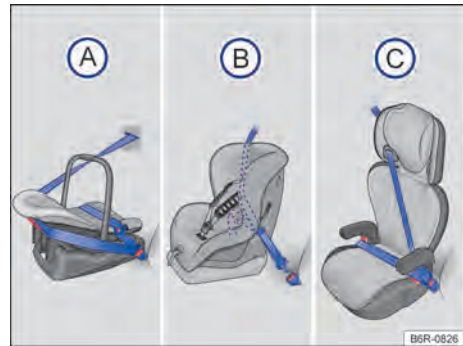
Fig. 42 As ilustrações A , B e C mostram a fixação do sistema de retenção para crianças apenas com o cinto de segurança do veículo.
