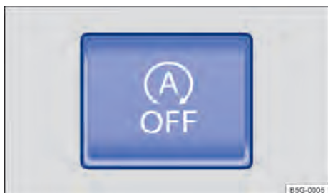
Fig. 95 Na parte superior do console central: botão do sistema Start-Stop.
