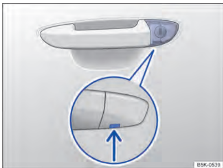
Fig. 56 Maçaneta da porta do condutor: cilindro da fechadura coberto.
