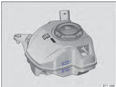
Fig. 201 No compartimento do motor: marcação no reservatório de expansão do líquido de arrefecimento do motor.
