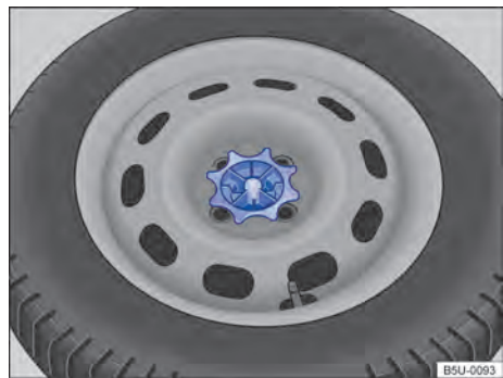
Fig. 210 No compartimento de bagagem: manipulador para fixação da roda de emergência.
