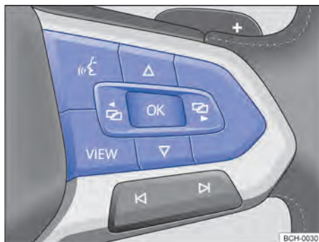
Fig. 21 Lado direito do volante multifunções (variante 2): botões para comando dos menus e exibições de informação do instrumento combinado.
