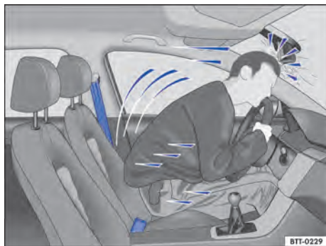
Fig. 27 O condutor sem cinto de segurança é lançado para frente.
