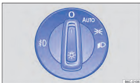
Fig. 76 Ao lado do volante: interruptor de luzes (uma variante).
