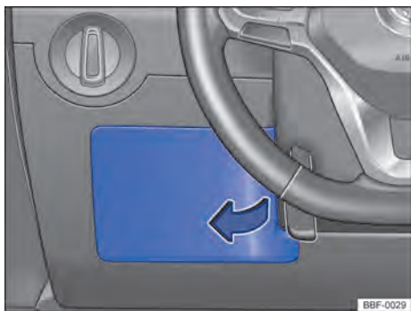
Fig. 184 No lado do condutor do painel de instrumentos: cobertura da caixa de fusíveis.
