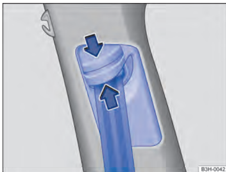
Fig. 34 Ao lado dos bancos dianteiros: regulagem de altura do cinto de segurança.
