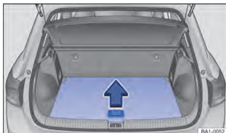
Fig. 169 No compartimento de bagagem: levantar o assoalho do compartimento de bagagem.
