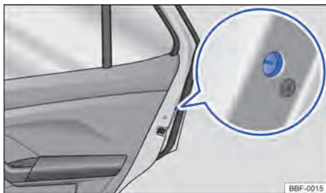
Fig. 58 Na porta traseira: travamento de emergência.
