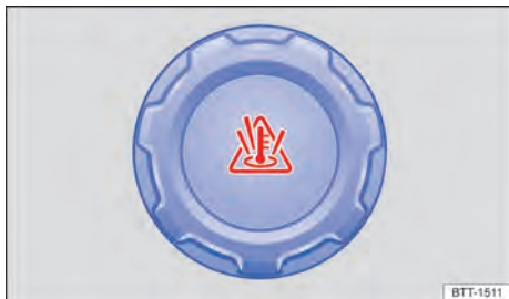
Fig. 202 No compartimento do motor: tampa do reservatório de expansão do líquido de arrefecimento do motor.
