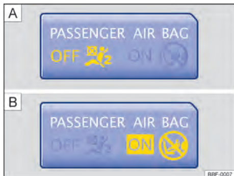
Fig. 35 Na parte superior do console central: luz de controle para o airbag frontal do passageiro dianteiro desligado [A] ou luz de controle para o airbag frontal do passageiro dianteiro ligado [B]. ▶
