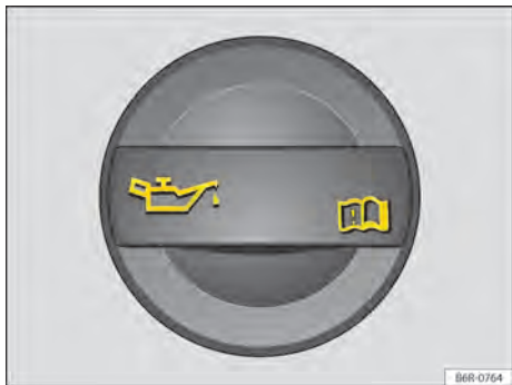
Fig. 200 No compartimento do motor: tampa da abertura para enchimento de óleo do motor.
