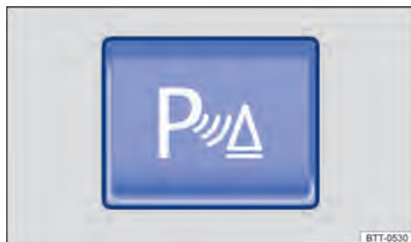
Fig. 106 No console central: botão para ligar e desligar o auxílio de estacionamento.
