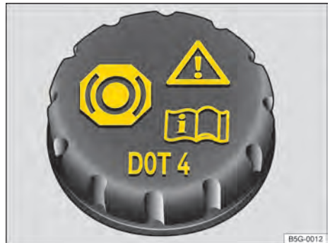
Fig. 203 No compartimento do motor: tampa do reservatório de fluido de freio.
