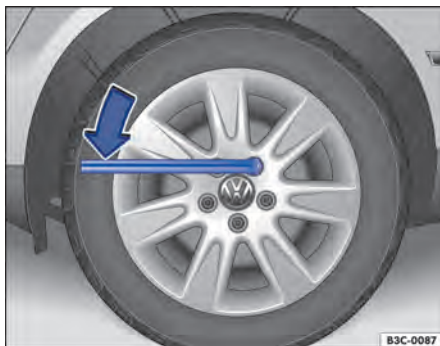
Fig. 213 Troca de roda: soltar os parafusos da roda.
