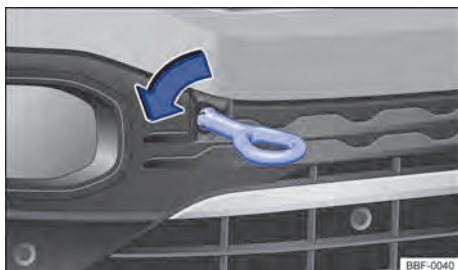
Fig. 194 No para-choque dianteiro à direita: rosquear a argola de reboque.
