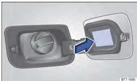
Fig. 208 Na parte interna da portinhola do tanque de combustível: etiqueta com a pressão dos pneus.
