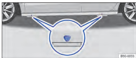
Fig. 214 Pontos de apoio do macaco.
