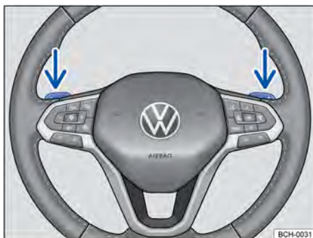
Fig. 98 Volante com seletores basculantes do Tiptronic.
