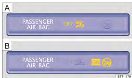
Fig. 14 Na parte superior do console central: luz de controle para o airbag frontal do passageiro dianteiro desligado [A] ou luz de controle para o airbag frontal do passageiro dianteiro ligado [B].
