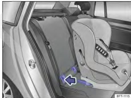
Fig. 28 Representação esquemática: instalar a cadeira de criança ISOFIX com os braços de apoio.
