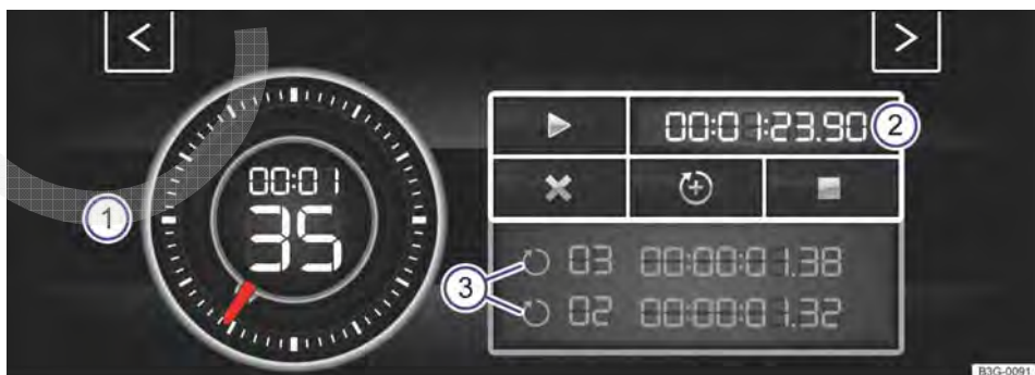
Fig. 70 No sistema Infotainment: Laptimer com cronômetro, superfície de função e tempos de voltas. ▶
