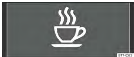
Fig. 60 No display do instrumento combinado: símbolo do sistema de reconhecimento de cansaço.
