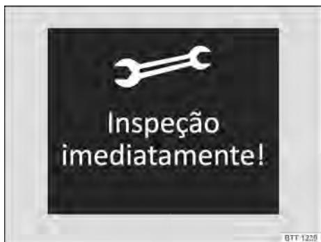
Fig. 64 No display do instrumento combinado: exemplo de indicação para um evento de serviço próximo de vencer no display dos instrumento combinado.
