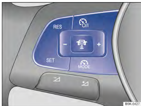
Fig. 168 Lado esquerdo do volante multifunções: Botões de comando do ACC.
