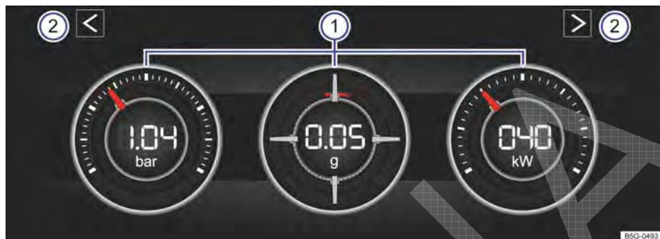
Fig. 69 No sistema Infotainment: módulo de potência.
