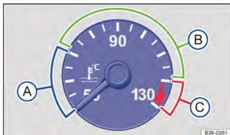
Fig. 63 Indicador de temperatura do líquido de arrefecimento do motor no instrumento combinado: (A) área fria; (B) área normal; (C) área de advertência.
