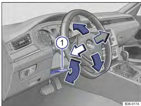
Fig. 100 Embaixo do volante no revestimento da coluna de direção: alavanca de ajuste mecânico da posição do volante.
