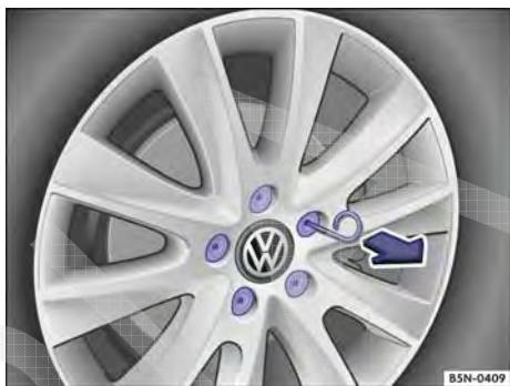
Fig. 316 Remover as capas de cobertura dos parafusos de roda.
