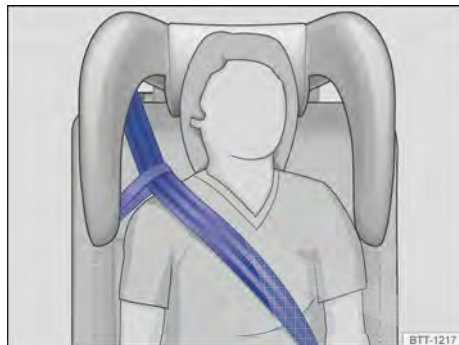
Fig. 34 Cadeira de criança integrada: posição do cadarço do cinto de segurança com alça de passagem do cinto de segurança.
