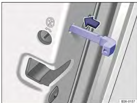
Fig. 87 Na parte dianteira da porta traseira direita: travamento de emergência do veículo com a chave de emergência.
