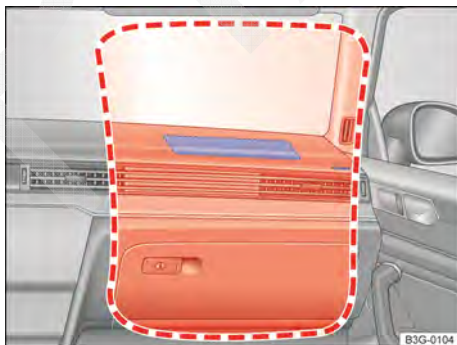
Fig. 16 Local de instalação e área de expansão do airbag frontal do passageiro dianteiro.
