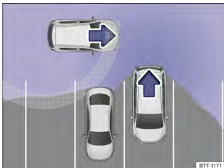
Fig. 182 Área monitorada ao redor do veículo que deve sair da vaga de estacionamento.
