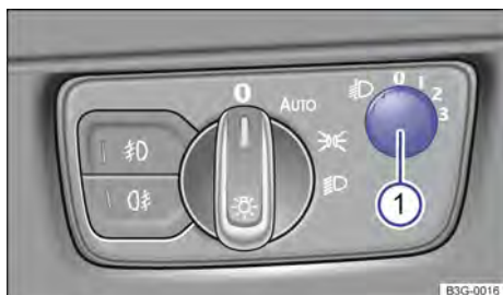
Fig. 119 Ao lado do volante: regulador da regulagem de alcance do farol ①.
