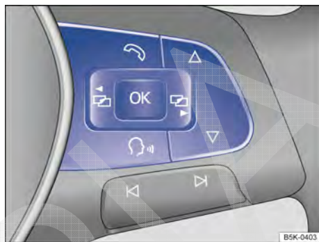
Fig. 67 Lado direito do volante multifunções: botões para comando dos menus e exibições de informação do instrumento combinado.
