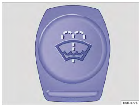
Fig. 297 No compartimento do motor: tampa do reservatório de água dos lavadores dos vidros.
