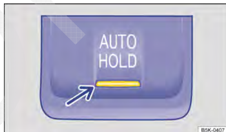
Fig. 185 Na parte inferior do console central: botão do Auto Hold.
