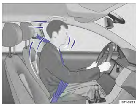
Fig. 8 Condutor protegido pelo cinto de segurança colocado corretamente em uma manobra de frenagem súbita.
