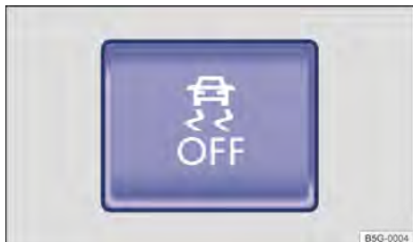
Fig. 209 Na parte inferior do console central: botão para desligar e ligar manualmente o ASR, ASR com ESC ou ESC Sport.
