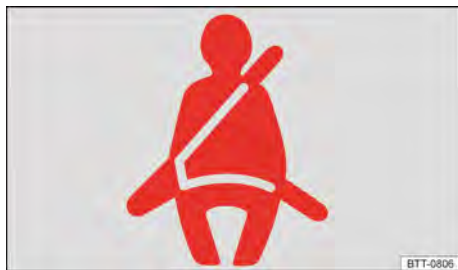
Fig. 2 Luz de advertência do instrumento combinado.
