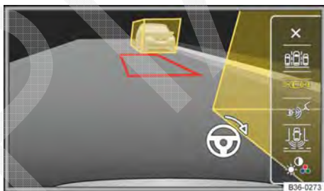
Fig. 194 Exibição do display da câmera de marcha a ré: modo 2 ligado.
