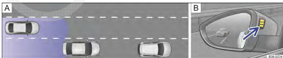
Fig. 180 Situação de condução ao ultrapassar com o trânsito traseiro. Indicação visual no espelho retrovisor externo esquerdo.
