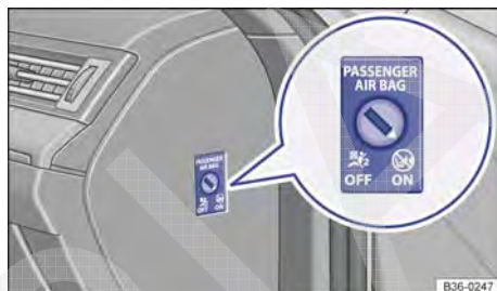
Fig. 17 No painel de instrumentos no lado do passageiro dianteiro: interruptor acionado pela chave para desligar e ligar o airbag frontal do passageiro dianteiro.
