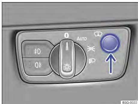
Fig. 57 Ao lado do volante: regulador do head-up display (seta).
