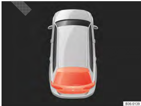
Fig. 88 No display do instrumento combinado: Tampa do compartimento de bagagem aberta ou fechada incorretamente (Passat Variant).
