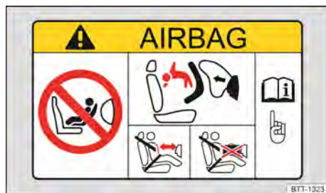
Fig. 25 Representação esquemática: etiqueta de airbag no para-sol.
