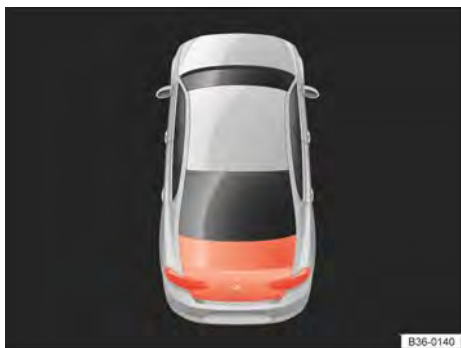
Fig. 89 No display do instrumento combinado: Tampa do compartimento de bagagem aberta ou fechada incorretamente (Passat).
