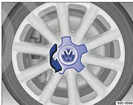
Fig. 314 Virar a calota central.
