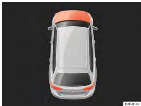
Fig. 296 Representação esquemática do display do instrumento combinado: tampa do compartimento do motor aberta ou fechada incorretamente.
