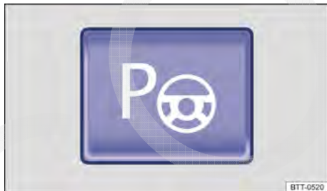
Fig. 199 Na parte superior do console central: botão para ligar o assistente de direção para estacionamento.
