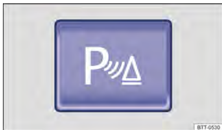
Fig. 186 Na parte superior do console central: Botão para ligar ou desligar o Park Pilot (depende da versão).
