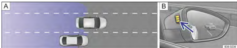
Fig. 181 A Situação de condução ao ultrapassar e mudar frequentemente de faixa. B Indicação visual no espelho retrovisor externo direito.
