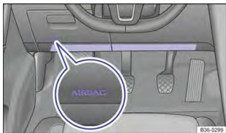
Fig. 22 No lado do condutor: local de instalação do airbag para joelhos.
