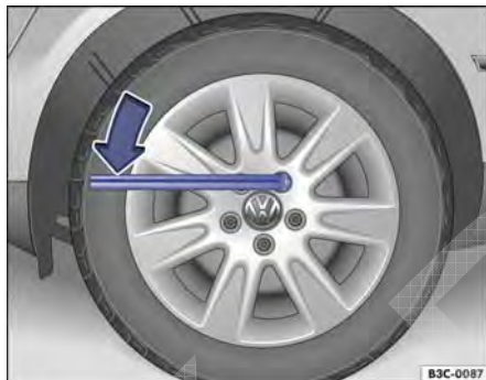
Fig. 317 Troca de roda: soltar os parafusos de roda.
