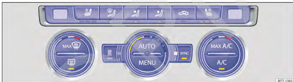
Fig. 133 Na parte superior do console central: comandos do Climatronic.
