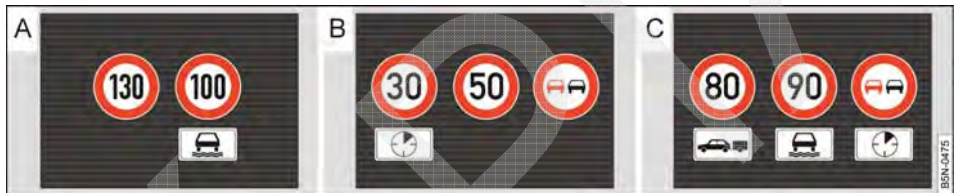
Fig. 61 No display do instrumento combinado: exemplos de limites de velocidade e proibição de ultrapassagem com placas adicionais associadas.
