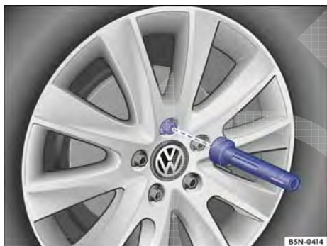
Fig. 321 Troca de roda: desaparafusar os parafusos de roda com o punho da chave de fenda.
