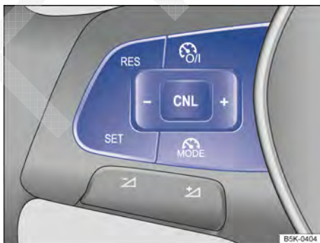
Fig. 165 Lado esquerdo do volante multifunções: botões para comandar o limitador de velocidade.
