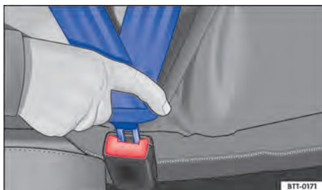
Fig. 31 Introduzir a lingueta do cinto de segurança no fecho do cinto de segurança.
