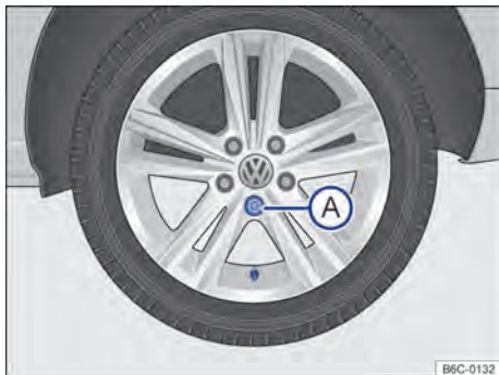
Fig. 198 Retirar a calota integral.
