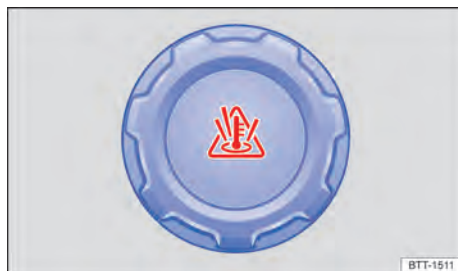
Fig. 188 No compartimento do motor: tampa do reservatório de expansão do líquido de arrefecimento do motor.
