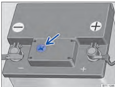
Fig. 190 No compartimento do motor: exemplo de posição do visor no lado superior da bateria do veículo.
