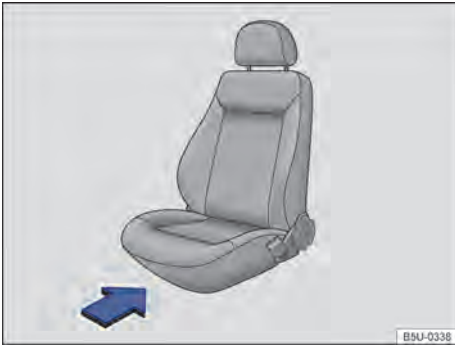
Fig. 51 Na parte frontal do banco do passageiro dianteiro: localização para instalação do suporte do extintor de incêndio.
