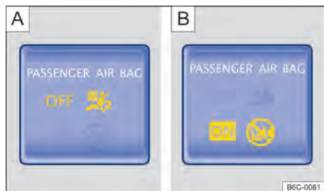
Fig. 36 Na parte superior do console central: luz de controle para o airbag frontal do passageiro dianteiro desligado [A] ou luz de controle para o airbag frontal do passageiro dianteiro ligado [B].
