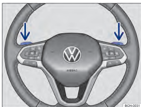
Fig. 96 Volante com seletores basculantes do Tiptronic.
