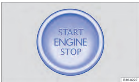
Fig. 91 Na parte inferior do console central: botão de partida para ligar o motor.
