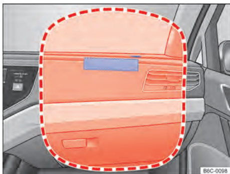
Fig. 38 Local de instalação e área de expansão do airbag frontal do passageiro dianteiro.
