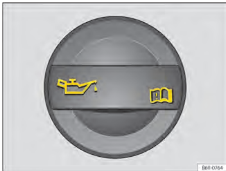
Fig. 186 No compartimento do motor: tampa da abertura para enchimento de óleo do motor.
