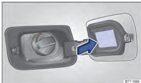
Fig. 194 Na parte interna da portinhola do tanque de combustível: etiqueta com a pressão dos pneus.
