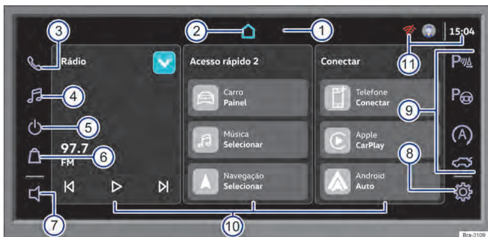
Fig. 139 Vista geral dos comandos.
