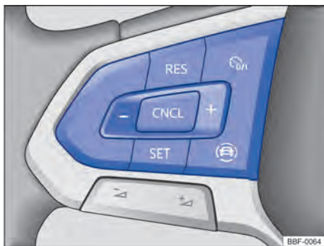
Fig. 98 Lado esquerdo do volante multifunções: botões para comandar o GRA.
