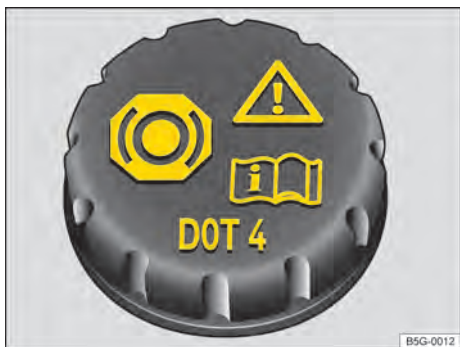
Fig. 189 No compartimento do motor: tampa do reservatório de fluido de freio.
