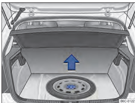
Fig. 159 No compartimento de bagagem, sob o revestimento de assoalho: roda de emergência e ferramentas de bordo.
