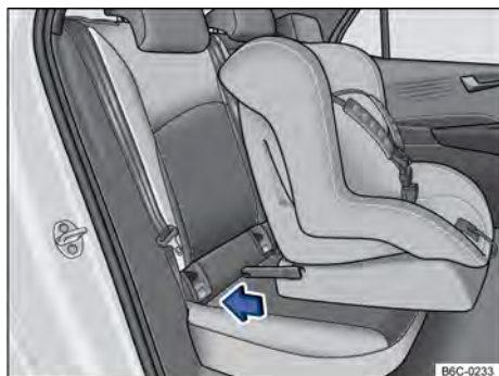
Fig. 44 No banco do veículo: identificação dos pontos de ancoragem inferiores para cadeiras de criança.
