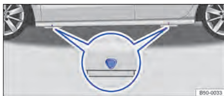
Fig. 201 Pontos de apoio do macaco.
