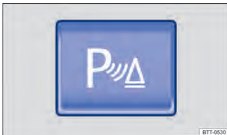
Fig. 100 No console central ou no display do rádio: botão para ligar e desligar o auxílio de estacionamento.
