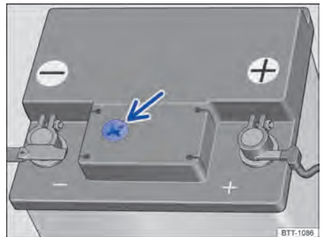
Fig. 186 No compartimento do motor: exemplo de posição do visor no lado superior da bateria do veículo.
