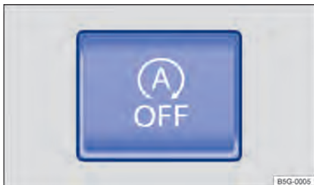
Fig. 88 Na parte superior do console central: botão do sistema Start-Stop.
