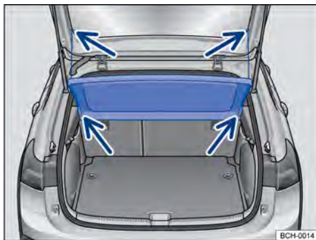
Fig. 154 No compartimento de bagagem: remover e instalar a cobertura do compartimento de bagagem.
