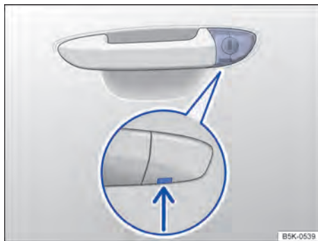
Fig. 53 Maçaneta da porta do condutor: cilindro da fechadura coberto.
