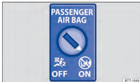
Fig. 35 No painel de instrumentos no lado do passageiro dianteiro: interruptor acionado pela chave para desligar e ligar o airbag frontal do passageiro dianteiro.
