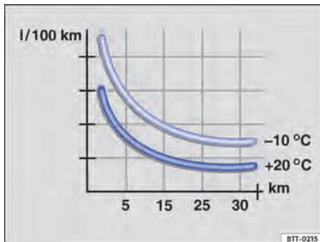
Fig. 84 Consumo de combustível em l/100 km em 2 temperaturas ambiente diferentes.
