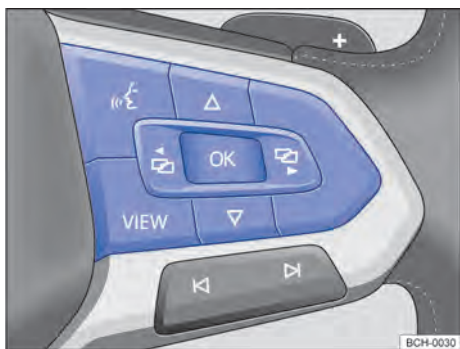
Fig. 17 Lado direito do volante multifunções: botões para comando dos menus e exibições de informação do instrumento combinado.
