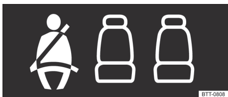
Fig. 21 Indicador de status do cinto de segurança para os assentos traseiros no display do instrumento combinado.
