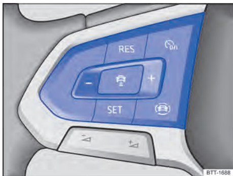
Fig. 100 Lado esquerdo do volante multifunções: botões para comandar o ACC.
