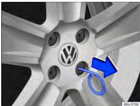
Fig. 159 Remover as capas de cobertura dos parafusos da roda.
