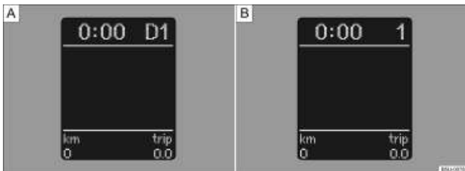
Fig. 101 (A) Posições da alavanca seletora no display: indicação da alavanca no modo de condução automatizada (Modo normal), com a 1ª marcha engatada. (B) Posições da alavanca seletora no display: modo de condução manual, com a 1ª marcha selecionada.
