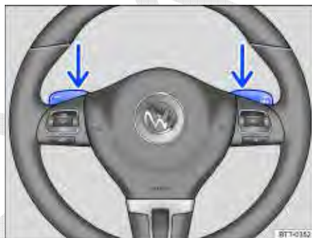
Fig. 104 Volante com dois seletores basculantes para troca de marcha no modo manual.
