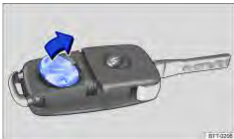
Fig. 25 Chave do veículo com comando remoto: remover a bateria.
