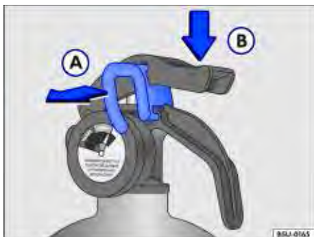
Fig. 149 Sequência de utilização do extintor de incêndio.
