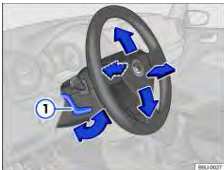
Fig. 42 Ajustar a posição do volante mecanicamente.
