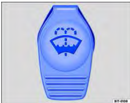
Fig. 71 No compartimento do motor: tampa do reservatório de água dos lavadores do para-brisa / vidro traseiro.
