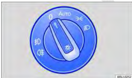
Fig. 64 No painel: interruptor giratório das luzes.
