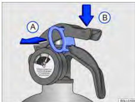
Fig. 150 Sequência de utilização do extintor de incêndio.
