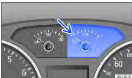
Fig. 120 No instrumento combinado: indicador da reserva de combustível.
