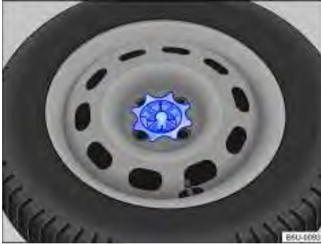
Fig. 140 No compartimento de bagagem: manípulo para fixação da roda de emergência.
