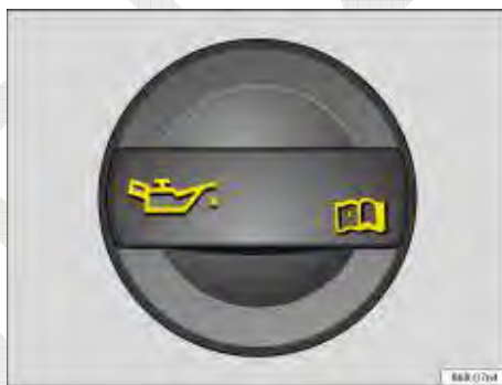
Fig. 125 No compartimento do motor: tampa da abertura para enchimento de óleo do motor.
