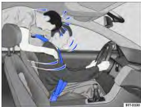
Fig. 47 O passageiro sem cinto de segurança no banco traseiro é lançado para frente sobre o condutor com cinto de segurança.
