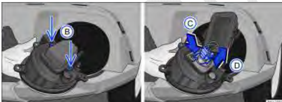
Fig. 184 Remover a cobertura para acesso da lâmpada e acesso a lâmpada do farol de neblina.
