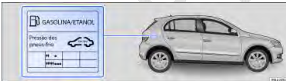
Fig. 138 Na portinhola do tanque de combustível: etiqueta da pressão dos pneus.
