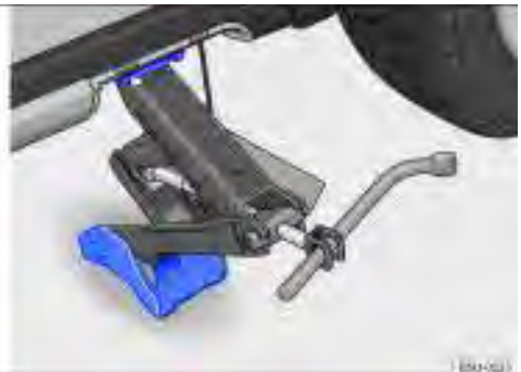
Fig. 162 Pontos de apoio do macaco e macaco posicionado no lado esquerdo traseiro do veículo - veículos com soleiras externas.
