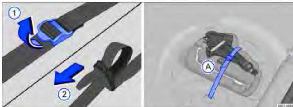
Fig. 156 No compartimento de bagagem: cinta de fixação da caixa de ferramentas e caixa de ferramentas de bordo.
