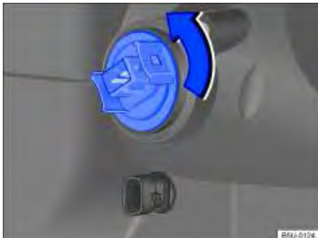
Fig. 175 Soquete da lâmpada incandescente do indicador de direção dianteiro.
