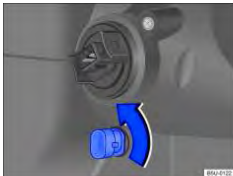
Fig. 173 Soquete da lâmpada incandescente da luz de posição.
