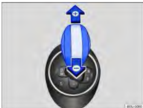
Fig. 103 Alavanca seletora na posição para condução de marcha no modo manual.
