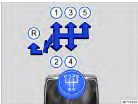
Fig. 99 Esquema de troca da transmissão manual de 5 marchas.
