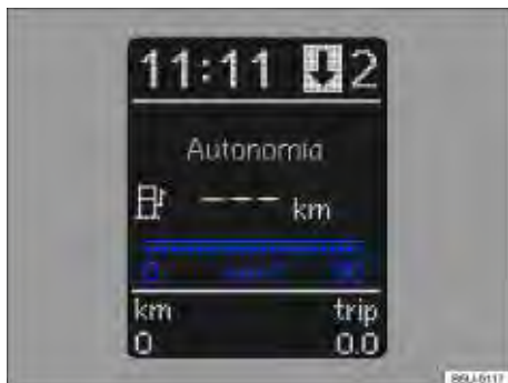
Fig. 12 No instrumento combinado: indicador de consumo de combustível.
