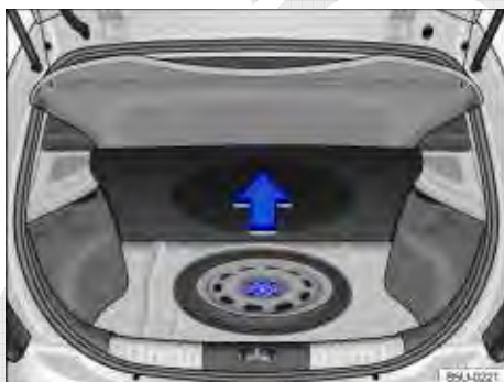
Fig. 155 No compartimento de bagagem, sob o revestimento de assoalho: roda de emergência e ferramentas de bordo.
