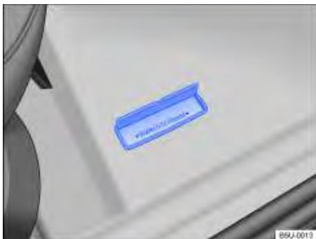
Fig. 18 Em frente ao banco do passageiro dianteiro: número de identificação do veículo (número do chassi) no assoalho, em frente ao banco do passageiro dianteiro.
