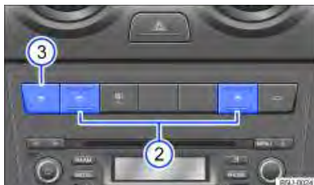
Fig. 34 No console central: teclas dos vidros elétricos traseiros.
