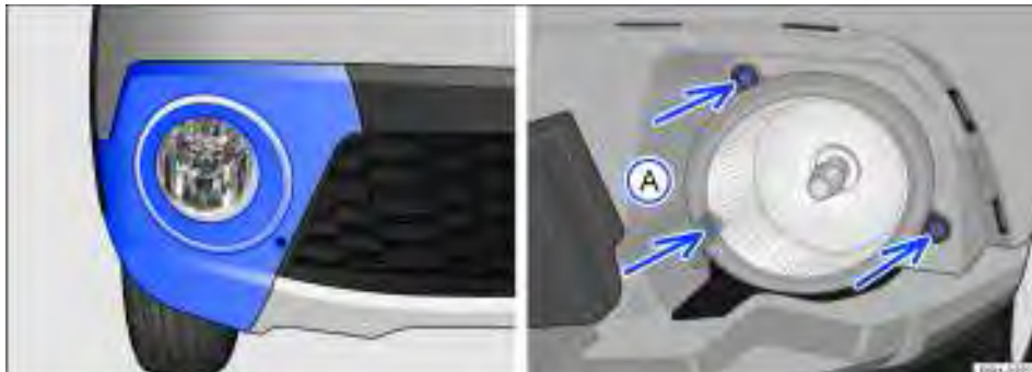
Fig. 183 No para-choque dianteiro: desinstalar o farol de neblina.
