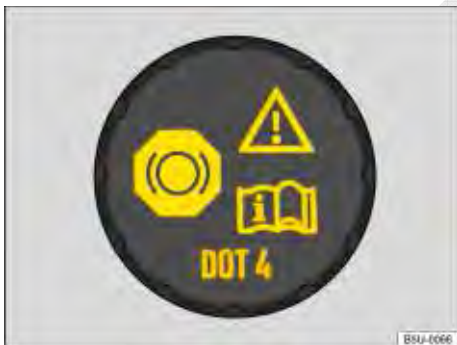
Fig. 108 No compartimento do motor: tampa do reservatório de fluido do freio.
