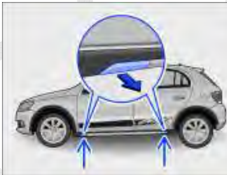
Fig. 162 Pontos de apoio do macaco e macaco posicionado no lado esquerdo traseiro do veículo - veículos com soleiras externas.
