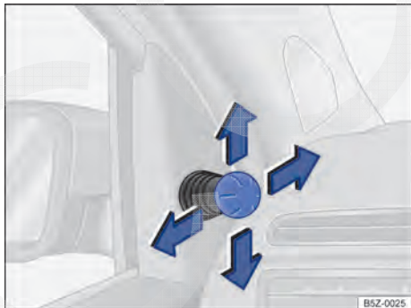
Fig. 72 Nas portas dianteiras: botão de ajuste dos espelhos retrovisores externos mecânicos.
