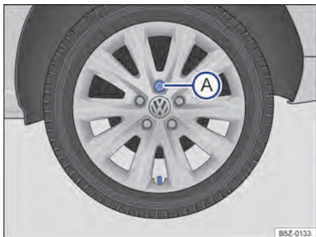
Fig. 163 Retirar a calota integral.
