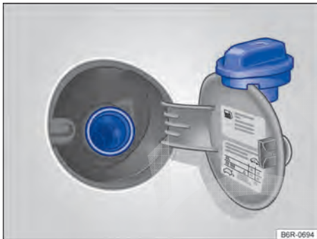
Fig. 124 Portinhola do tanque de combustível aberta com a tampa do tanque de combustível pendurada.
