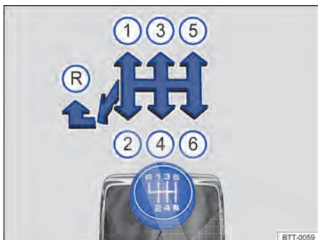
Fig. 98 Esquema de troca de marchas da transmissão manual de 6 marchas.
