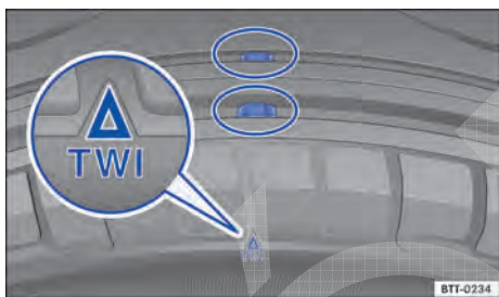
Fig. 141 Perfil do pneu: indicadores de desgaste.
