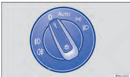
Fig. 61 No painel: interruptor das luzes.
